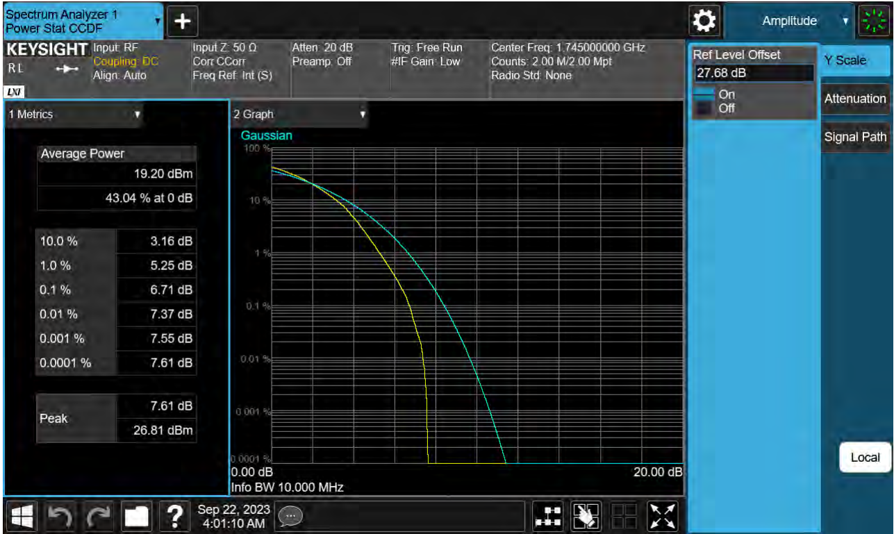
Sub6 n66. PAR Plot (10 M BW_Ch.349000_256QAM_Full RB)
