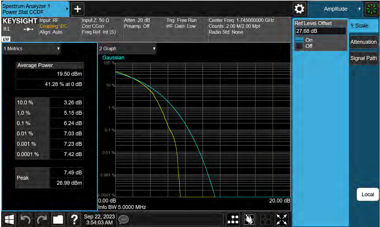
Sub6 n66. PAR Plot (5 M BW_Ch.349000_256QAM_Full RB)
