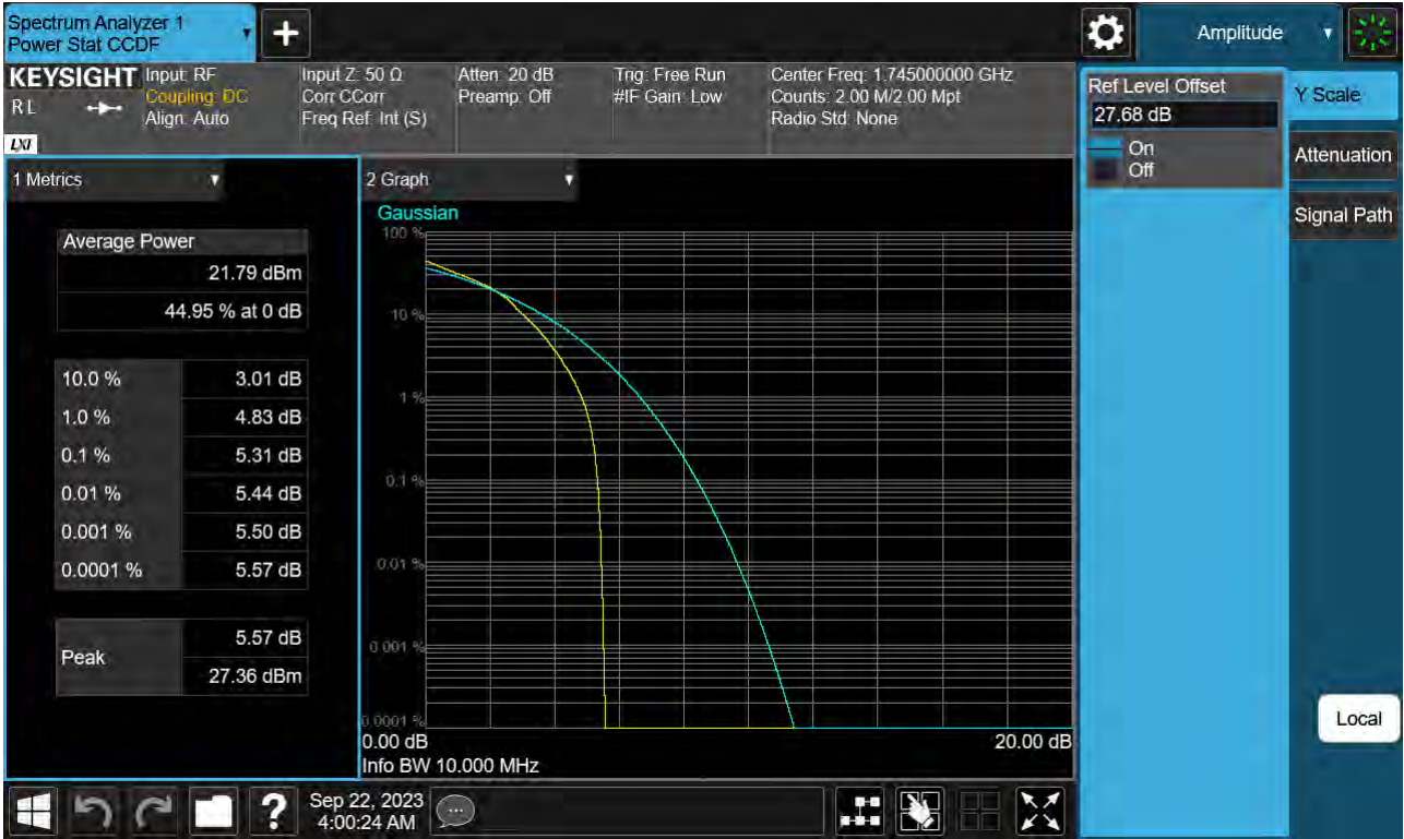
Sub6 n66. PAR Plot (10 M BW_Ch.349000_16QAM_Full RB)
