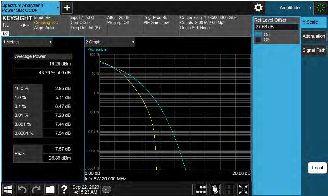
Sub6 n66. PAR Plot (20 M BW_Ch.349000_256QAM_Full RB)
