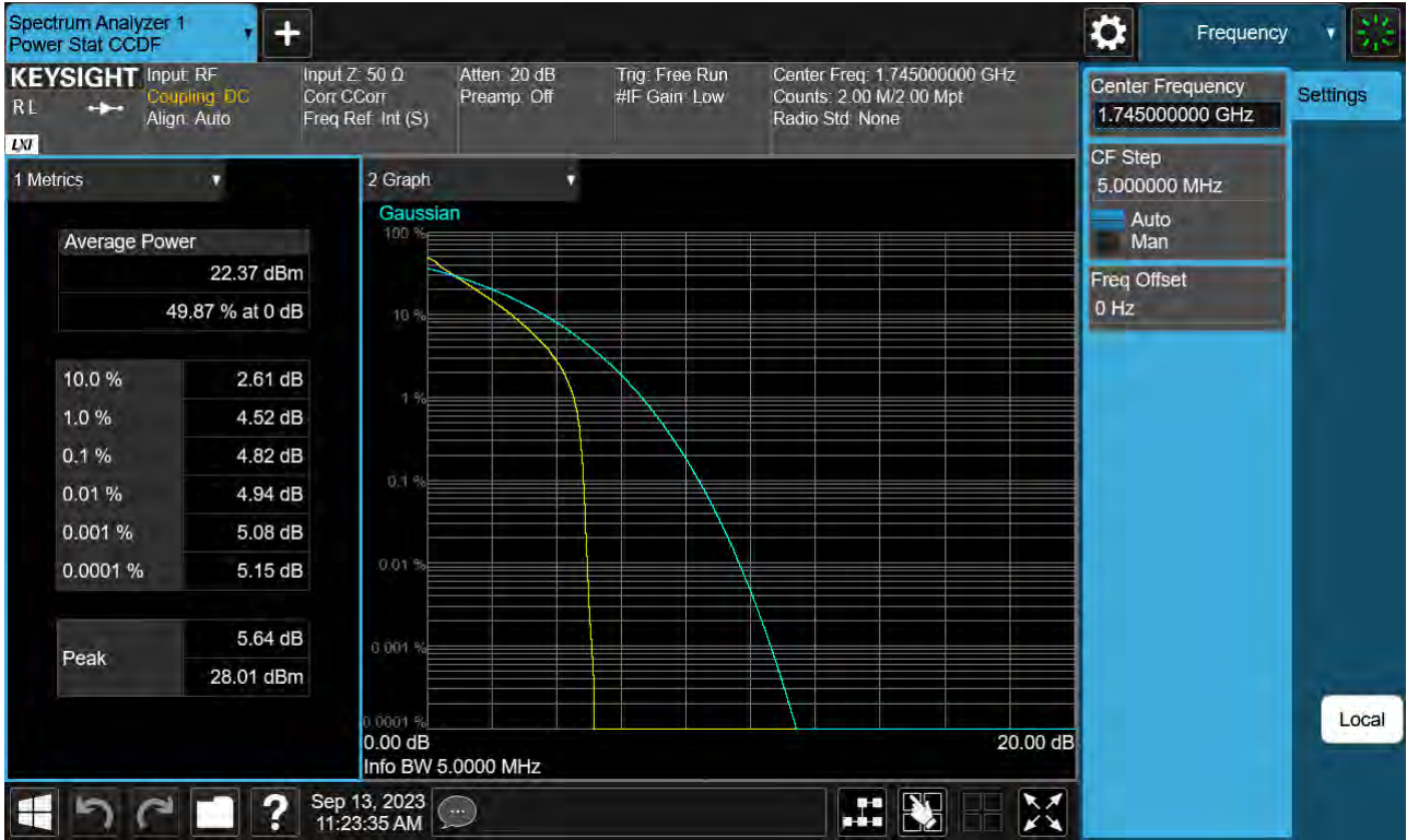
Sub6 n66. PAR Plot (5 M BW_Ch.349000_QPSK_Full RB)
