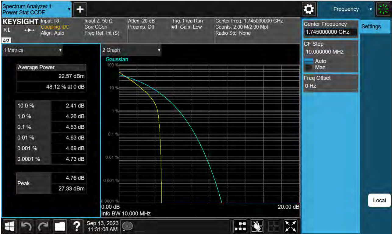
Sub6 n66. PAR Plot (10 M BW_Ch.349000_QPSK_Full RB)
