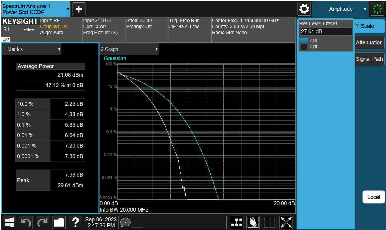
Sub6 n66. PAR Plot (20 M BW_Ch.349000_QPSK_Full RB)
