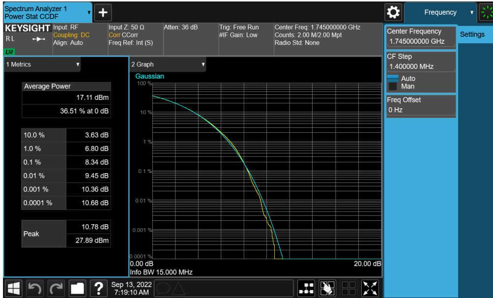
Plot 7-422. PAR Plot (NR Band n66 - 15.0MHz CP-OFDM 256-QAM - Full RB - Ant A)
