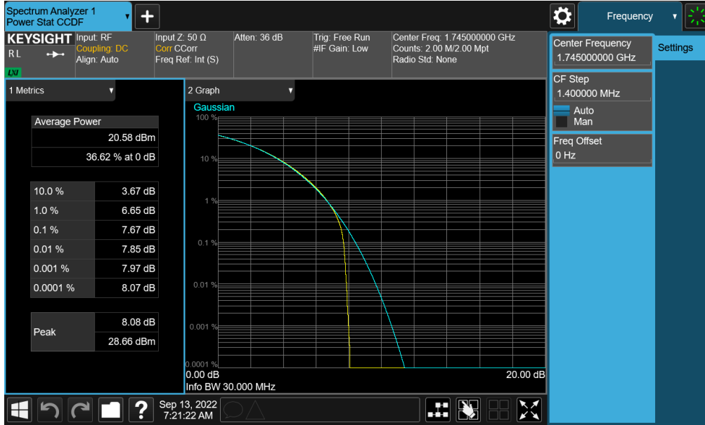
Plot 7-412. PAR Plot (NR Band n66 - 30.0MHz CP-OFDM QPSK - Full RB - Ant A)
