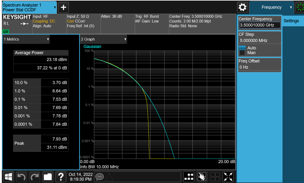
Plot 7-215. PAR Plot (NR Band n77 - DoD Band – 10MHz CP-OFDM QPSK - Full RB)
