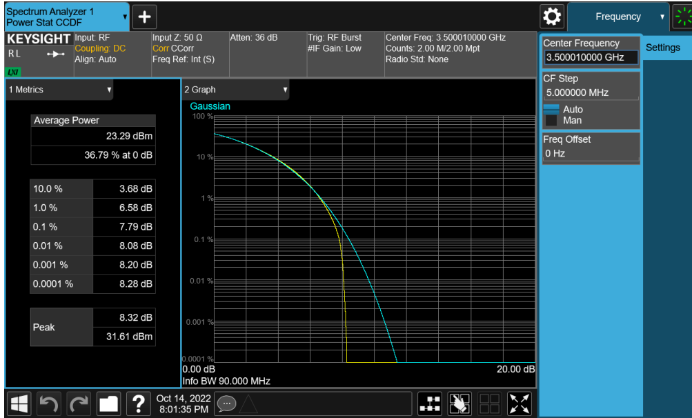
Plot 7-185. PAR Plot (NR Band n77 - DoD Band – 90MHz CP-OFDM QPSK - Full RB)
