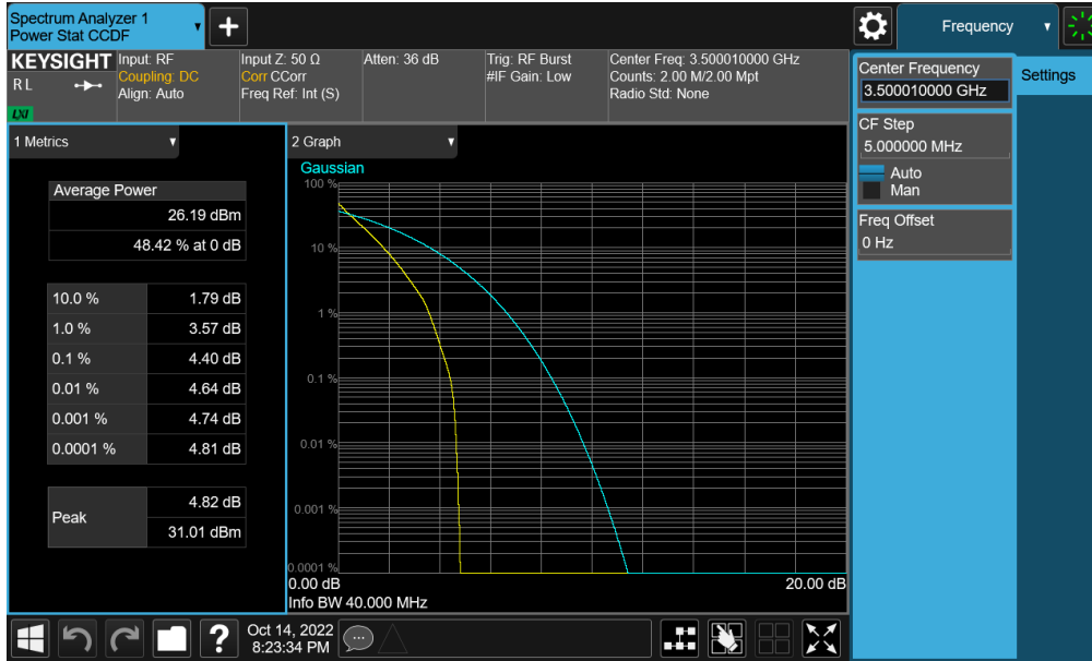
Plot 7-199. PAR Plot (NR Band n77 - DoD Band – 40MHz DFT-s-OFDM \pi/2 BPSK - Full RB)
