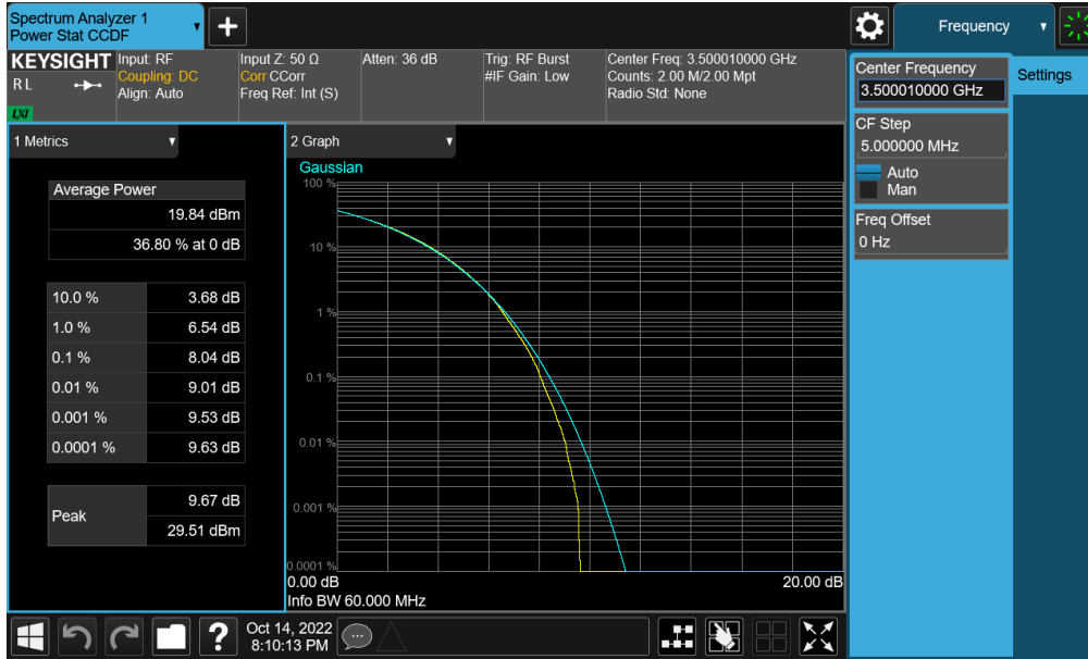
Plot 7-195. PAR Plot (NR Band n77 - DoD Band – 60MHz CP-OFDM 256-QAM - Full RB)
