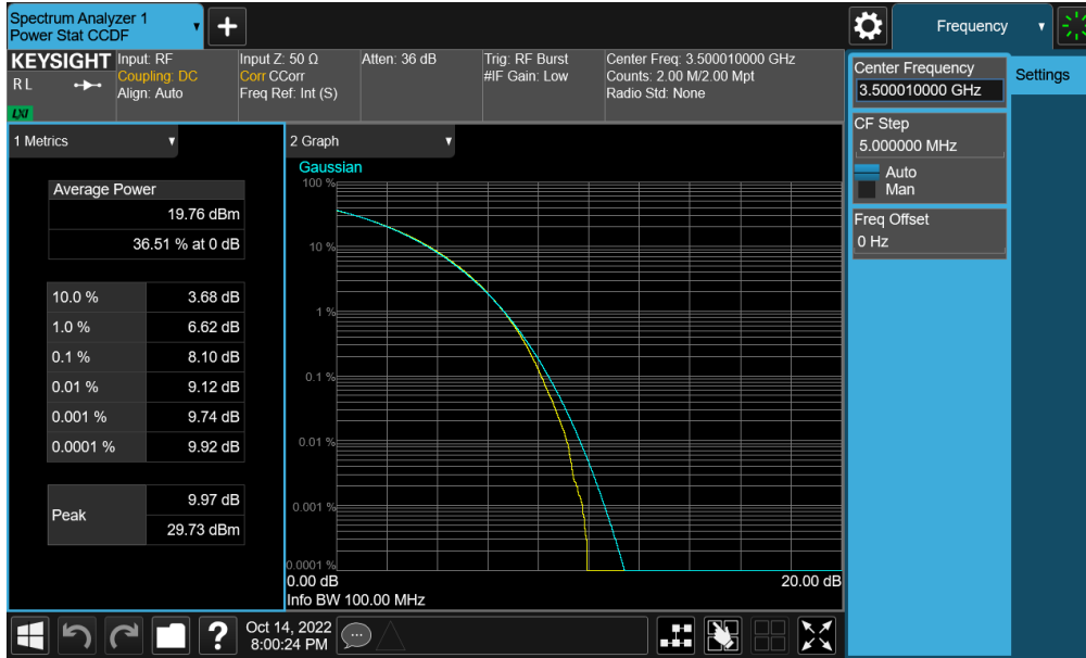
Plot 7-183. PAR Plot (NR Band n77 - DoD Band – 100MHz CP-OFDM 256-QAM - Full RB)
