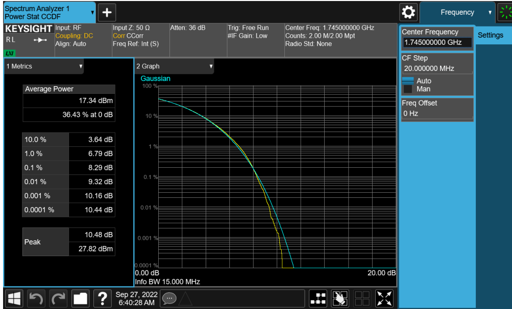
Plot 7-418. PAR Plot (NR Band n66 - 15.0MHz CP-OFDM 256-QAM - Full RB - ANT A)
