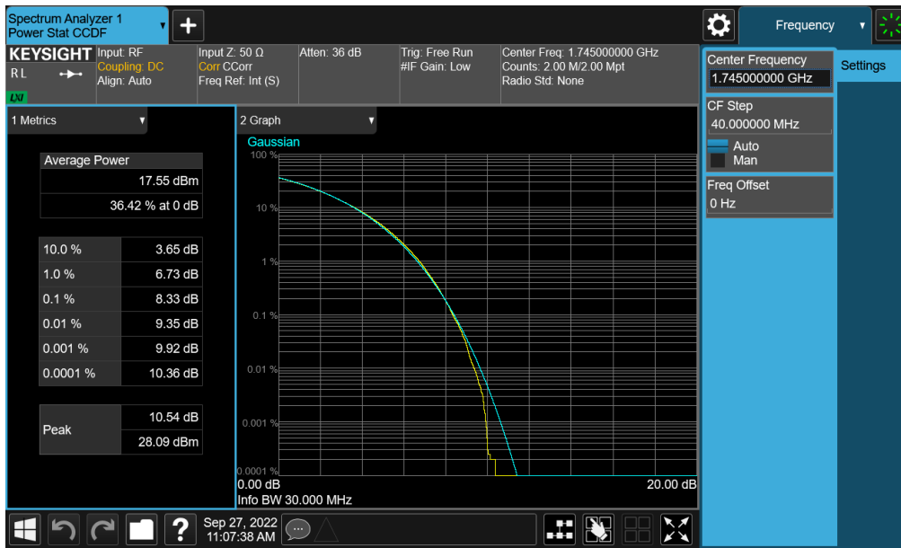
Plot 7-442. PAR Plot (NR Band n66 - 30.0MHz CP-OFDM 256-QAM - Full RB - Ant F)
