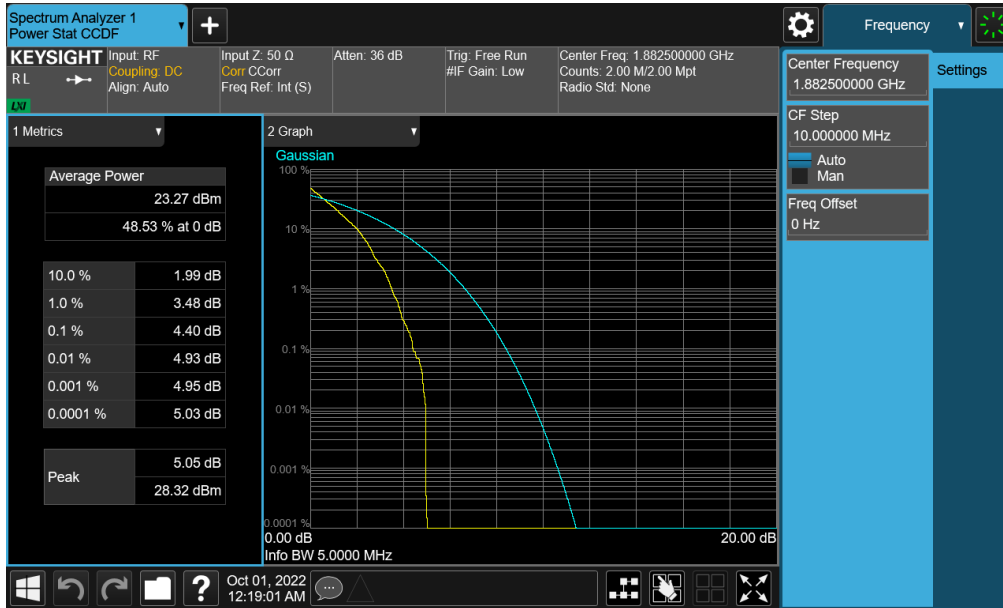
Plot 7-340. PAR Plot (NR Band n25/2 - 5.0MHz DFT-s-OFDM BPSK - Full RB - Ant F)
