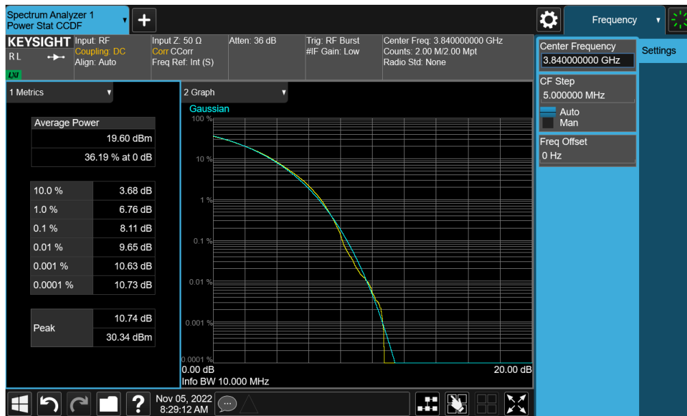
Plot 7-252. PAR Plot (NR Band n77 - C-Band - 10MHz CP-OFDM 256-QAM - Full RB)
