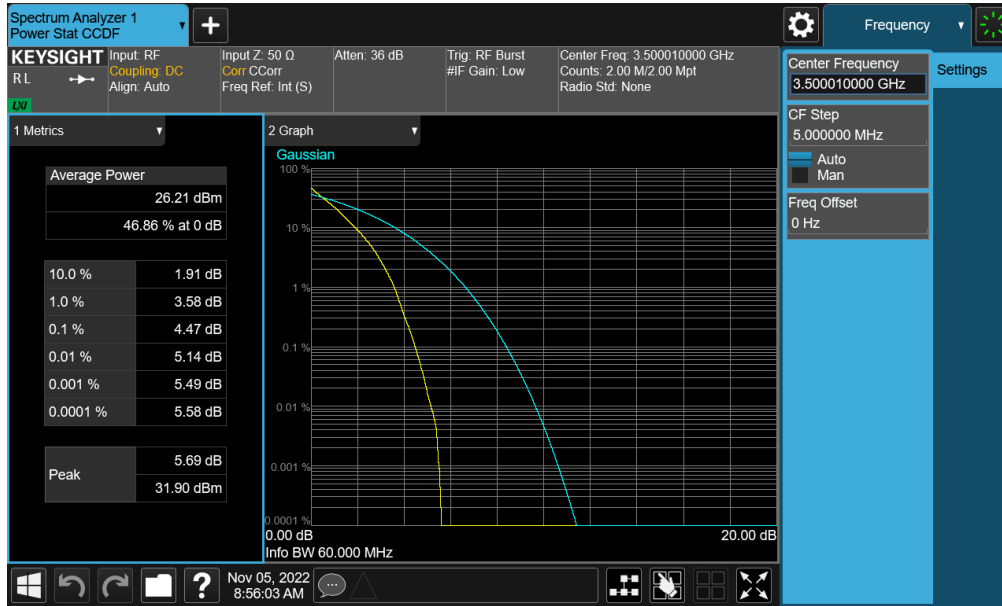
Plot 7-193. PAR Plot (NR Band n77 - DoD Band – 60MHz DFT-s-OFDM \pi/2 BPSK - Full RB)
