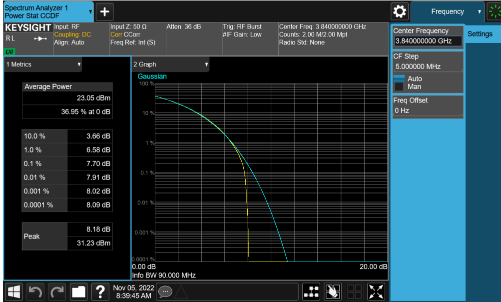
Plot 7-221. PAR Plot (NR Band n77 - C-Band – 90MHz CP-OFDM QPSK - Full RB)
