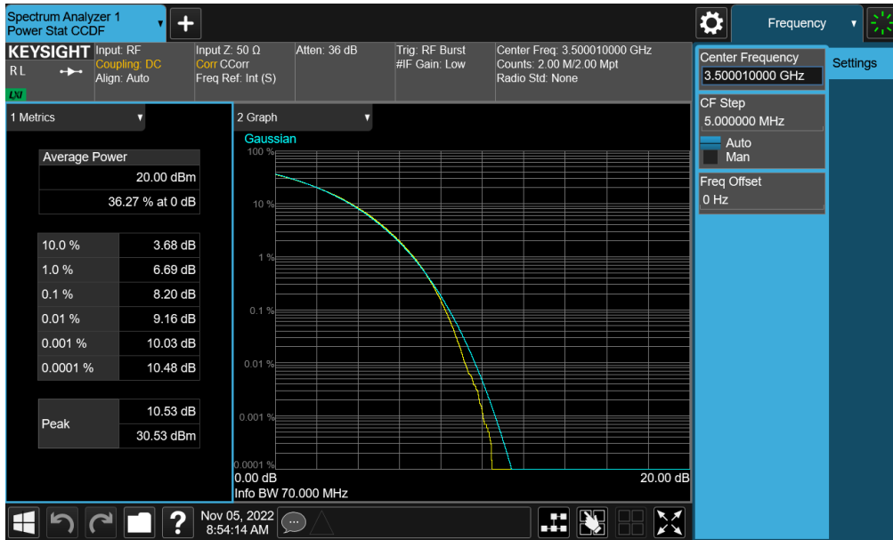
Plot 7-192. PAR Plot (NR Band n77 - DoD Band – 70MHz CP-OFDM 256-QAM - Full RB)
