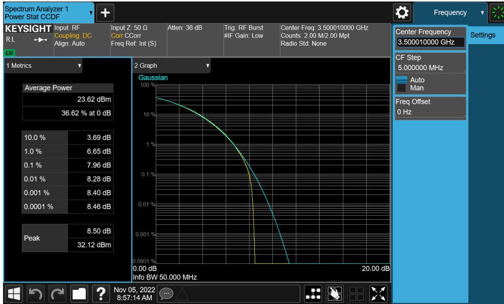
Plot 7-197. PAR Plot (NR Band n77 - DoD Band – 50MHz CP-OFDM QPSK - Full RB)
