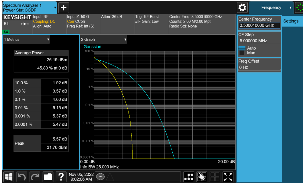
Plot 7-205. PAR Plot (NR Band n77 - DoD Band – 25MHz DFT-s-OFDM \pi/2 BPSK - Full RB)
