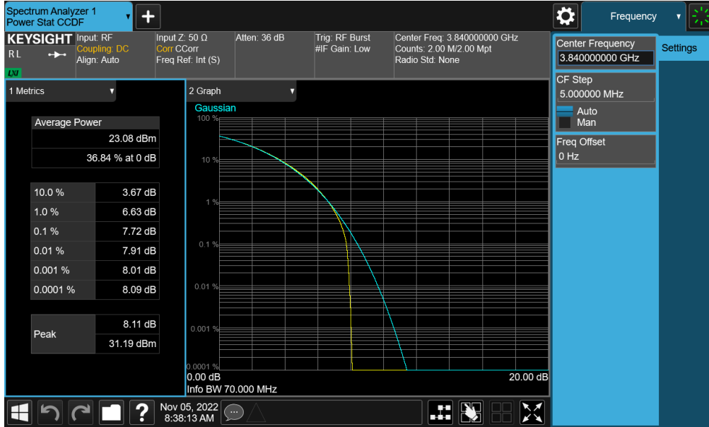
Plot 7-227. PAR Plot (NR Band n77 - C-Band – 70MHz CP-OFDM QPSK - Full RB)
