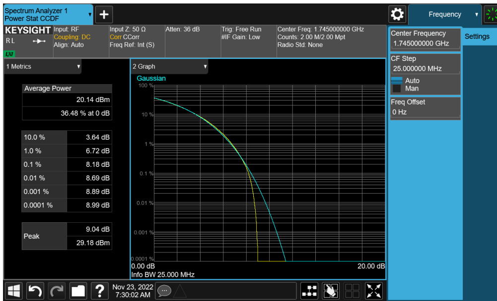
Plot 7-448. PAR Plot (NR Band n66 - 25.0MHz CP-OFDM QPSK - Full RB - Ant F)
