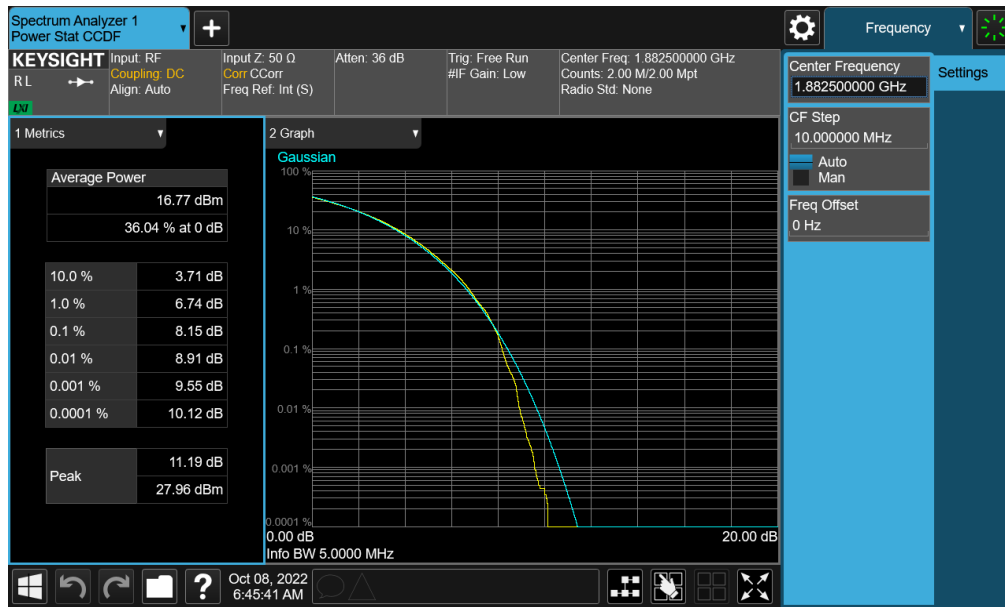
Plot 7-339. PAR Plot (NR Band n25/2 - 5.0MHz CP-OFDM 256-QAM - Full RB - Ant F)
