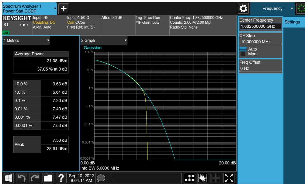
Plot 7-317. PAR Plot (NR Band n25/2 - 5.0MHz CP-OFDM QPSK - Full RB - Ant A)
