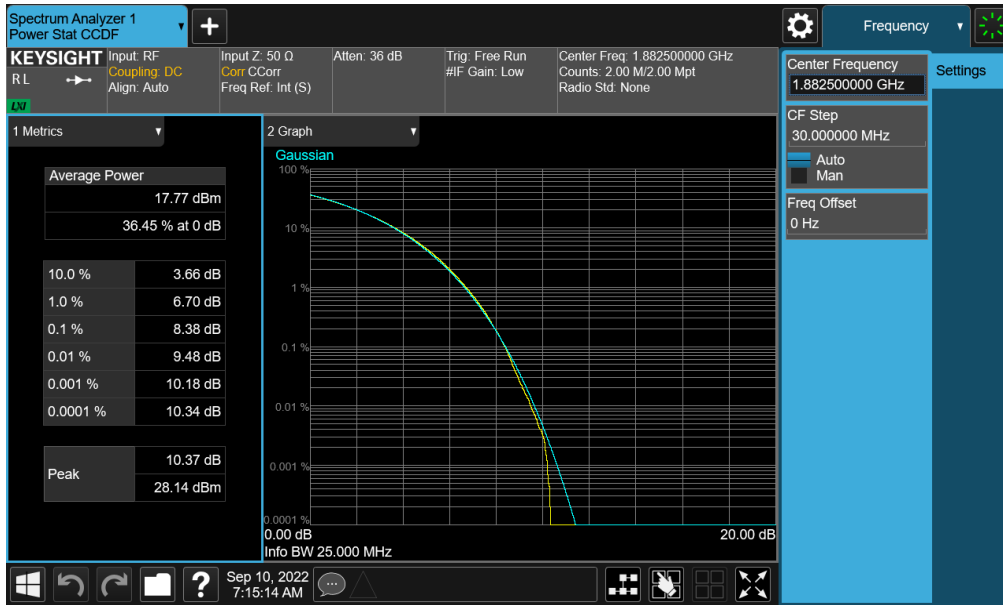
Plot 7-306. PAR Plot (NR Band n25/2 - 25.0MHz CP-OFDM 256-QAM - Full RB - Ant A)
