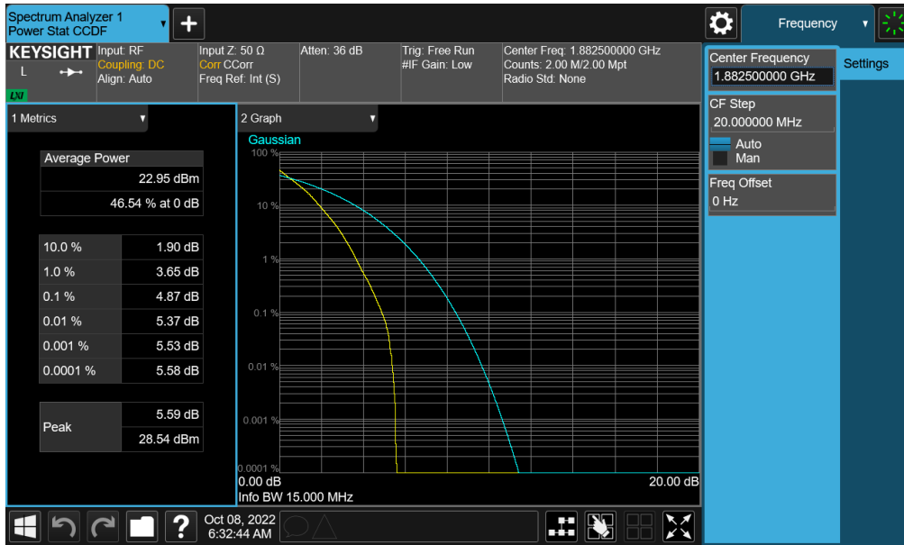
Plot 7-331. PAR Plot (NR Band n25/2 - 15.0MHz DFT-s-OFDM BPSK - Full RB - Ant F)
