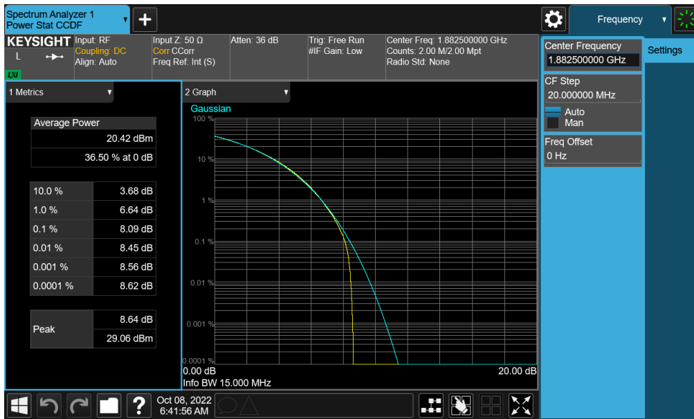
Plot 7-332. PAR Plot (NR Band n25/2 - 15.0MHz CP-OFDM QPSK - Full RB - Ant F)
