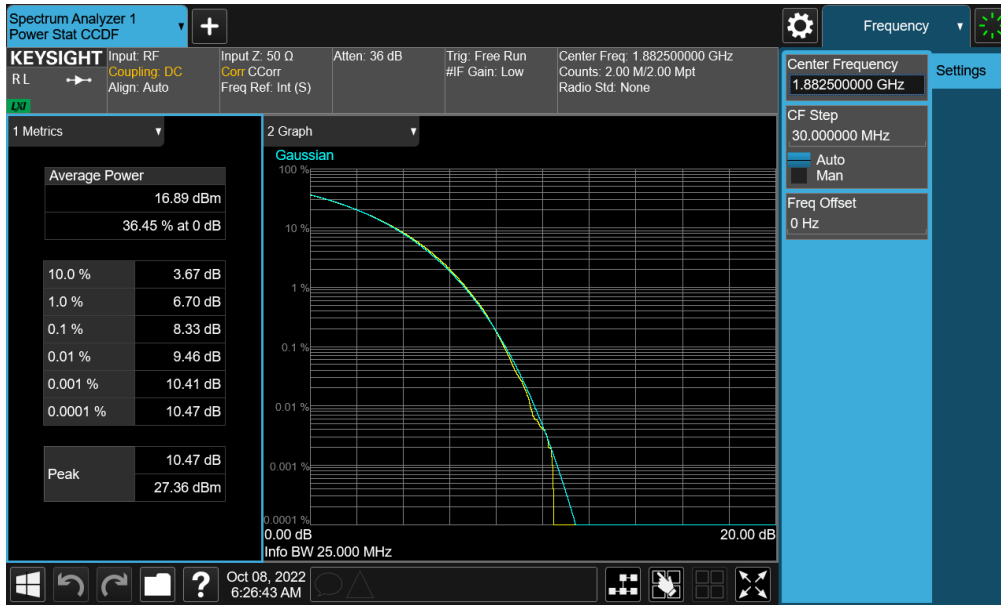
Plot 7-327. PAR Plot (NR Band n25/2 - 25.0MHz CP-OFDM 256-QAM - Full RB - Ant F)
