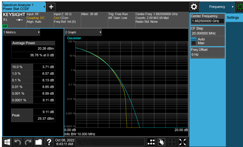
Plot 7-335. PAR Plot (NR Band n25/2 - 10.0MHz CP-OFDM QPSK - Full RB - Ant F)
