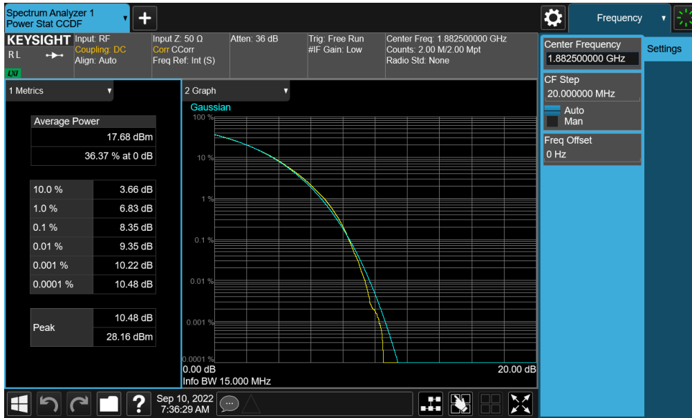
Plot 7-312. PAR Plot (NR Band n25/2 - 15.0MHz CP-OFDM 256-QAM - Full RB - Ant A)
