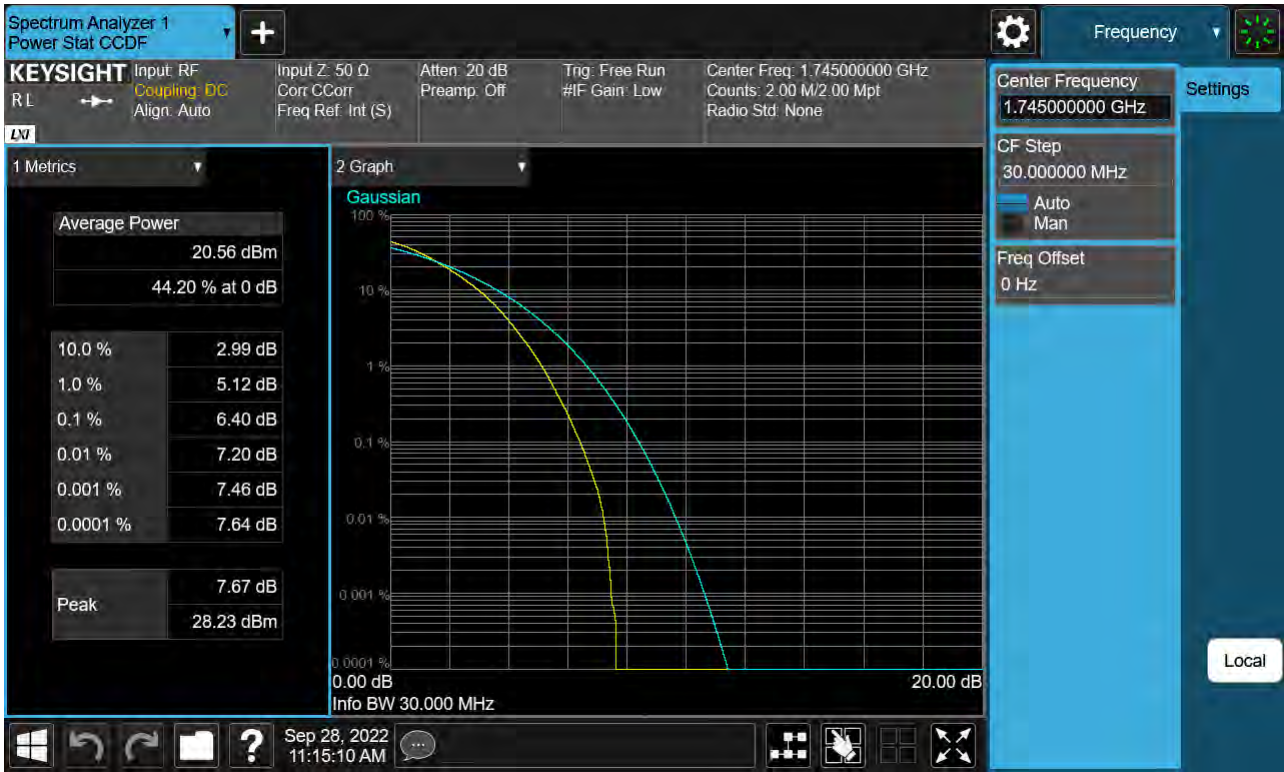
Sub6 n66. PAR Plot (30 M BW_Ch.349000_64QAM_Full RB)
