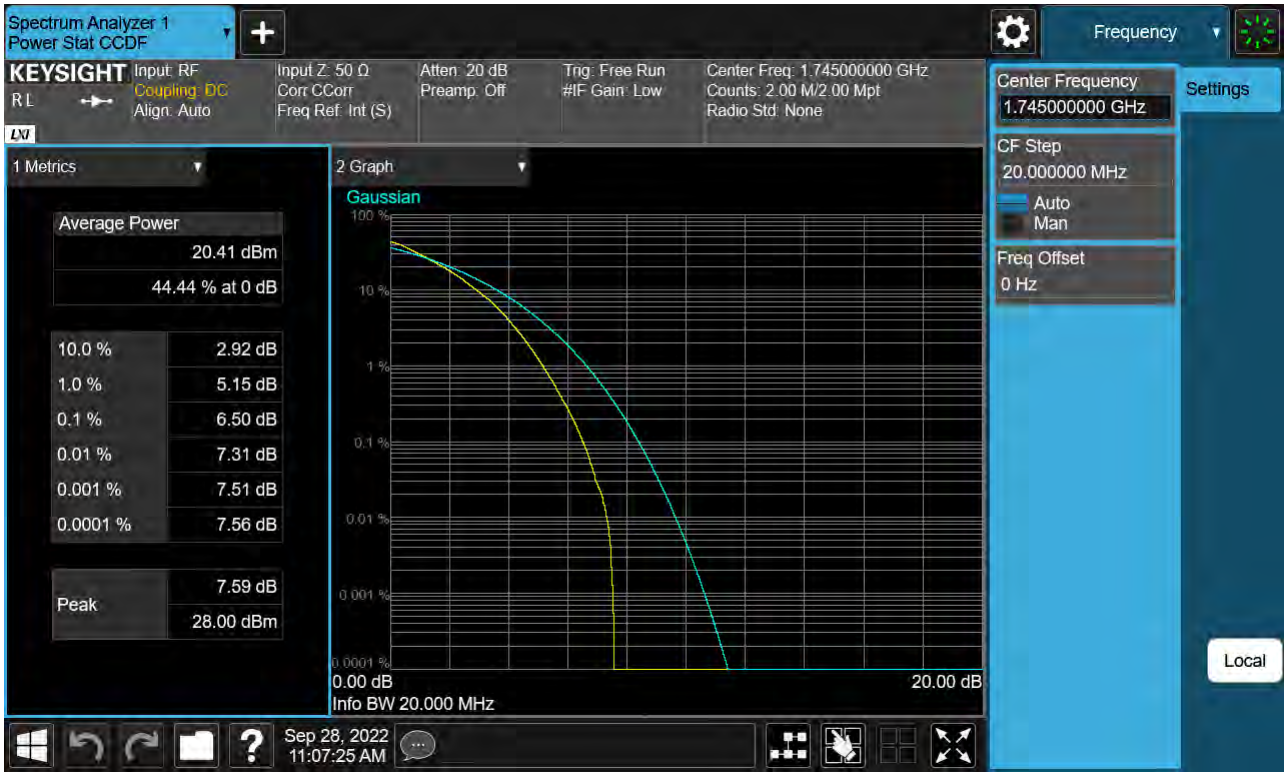
Sub6 n66. PAR Plot (20 M BW_Ch.349000_64QAM_Full RB)
