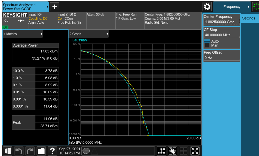
Plot 7-182. PAR Plot (NR Band n25/2 - 5.0MHz CP-OFDM 256-QAM - Full RB)
