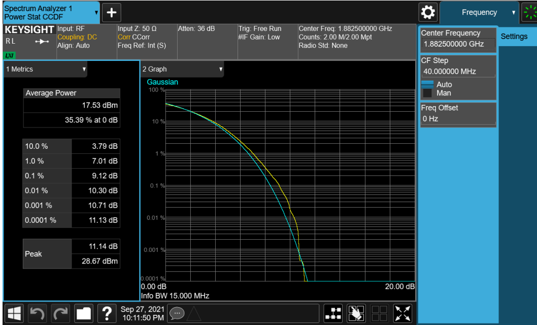
Plot 7-176. PAR Plot (NR Band n25/2 - 15.0MHz CP-OFDM 256-QAM - Full RB)
