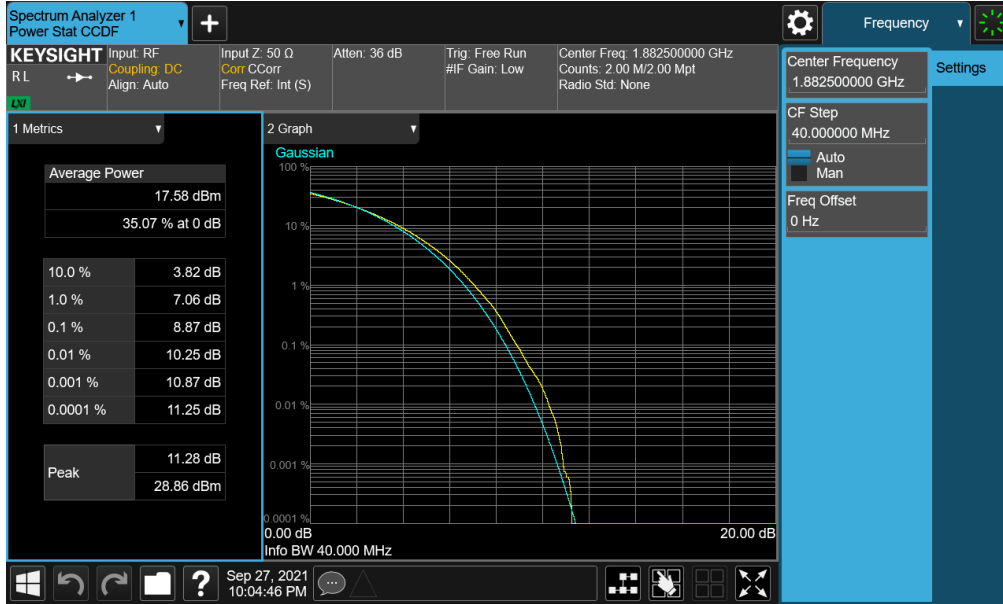
Plot 7-164. PAR Plot (NR Band n25/2 - 40.0MHz CP-OFDM 256-QAM - Full RB)
