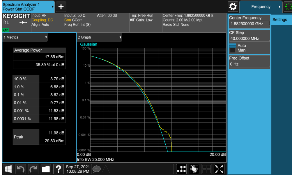
Plot 7-170. PAR Plot (NR Band n25/2 - 25MHz CP-OFDM 256-QAM - Full RB)
