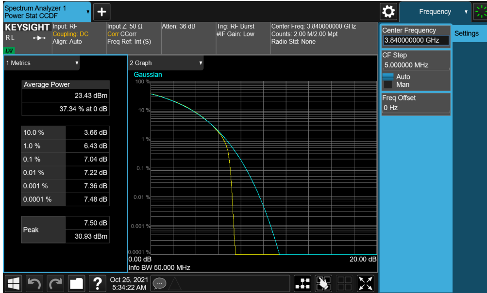
Plot 7-220. PAR Plot (NR Band n77 - 50MHz CP-OFDM QPSK - Full RB - ANT F)
