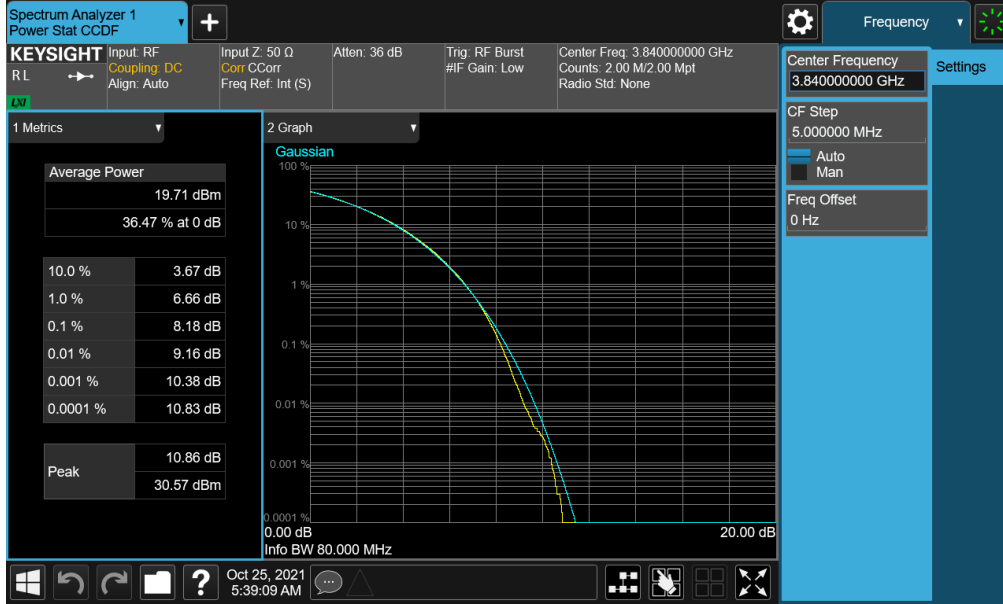
Plot 7-212. PAR Plot (NR Band n77 - 80MHz CP-OFDM 256-QAM - Full RB - ANT F)
