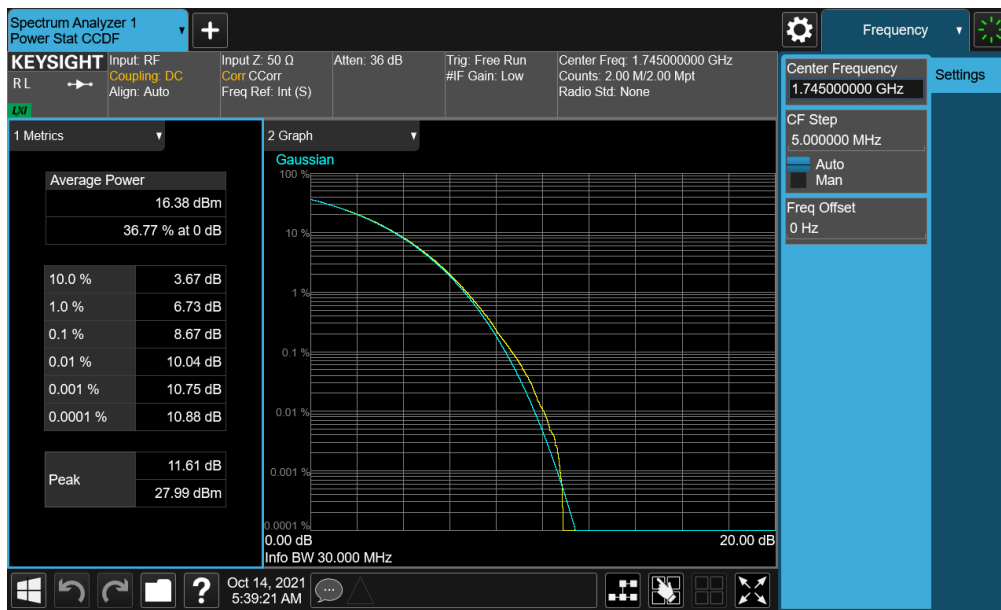
Plot 7-310. PAR Plot (NR Band n66 - 30.0MHz CP-OFDM 256-QAM - Full RB - Ant A)
