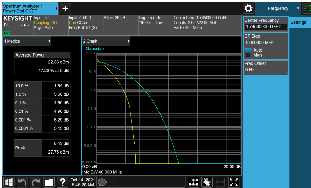
Plot 7-323. PAR Plot (NR Band n66 - 40.0MHz DFT-s-OFDM BPSK - Full RB – Ant I)
