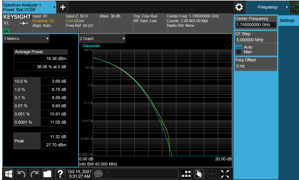
Plot 7-307. PAR Plot (NR Band n66 - 40.0MHz CP-OFDM 256-QAM - Full RB - Ant A)
