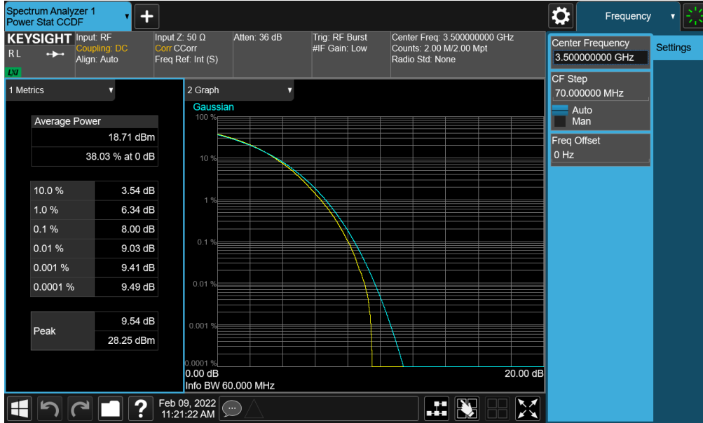
Plot 7-185. PAR Plot (NR Band n77 (DoD)- 60MHz CP-OFDM 256-QAM - Full RB - Ant F)
