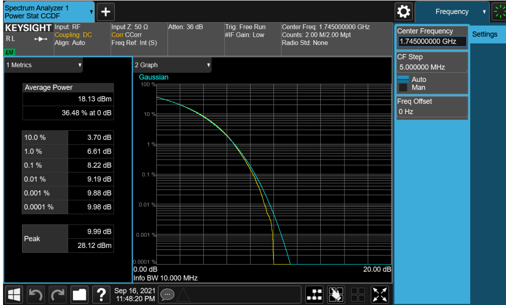
Plot 7-335. PAR Plot (NR Band n66 - 10.0MHz CP-OFDM 256-QAM - Full RB)
