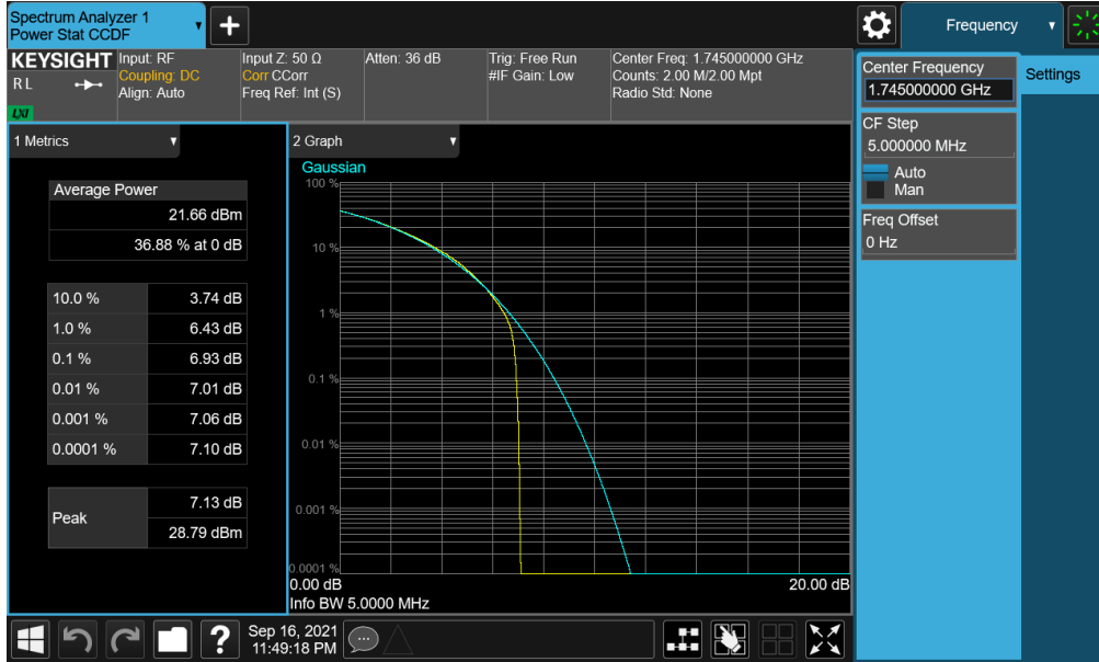
Plot 7-337. PAR Plot (NR Band n66 - 5.0MHz CP-OFDM QPSK - Full RB)
