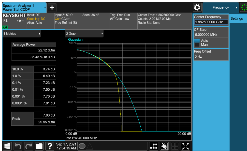
Plot 7-194. PAR Plot (NR Band n25 - 40.0MHz CP-OFDM QPSK - Full RB - ANT A)
