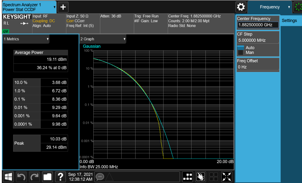
Plot 7-201. PAR Plot (NR Band n25 - 25.0MHz CP-OFDM 256-QAM - Full RB - ANT A)
