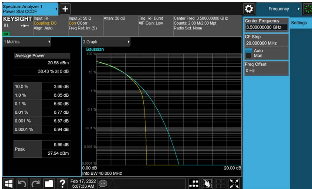
Plot 7-188. PAR Plot (NR Band n77 - 40MHz CP-OFDM QPSK - Full RB- DoD-Band - Ant G - SRS 1)
