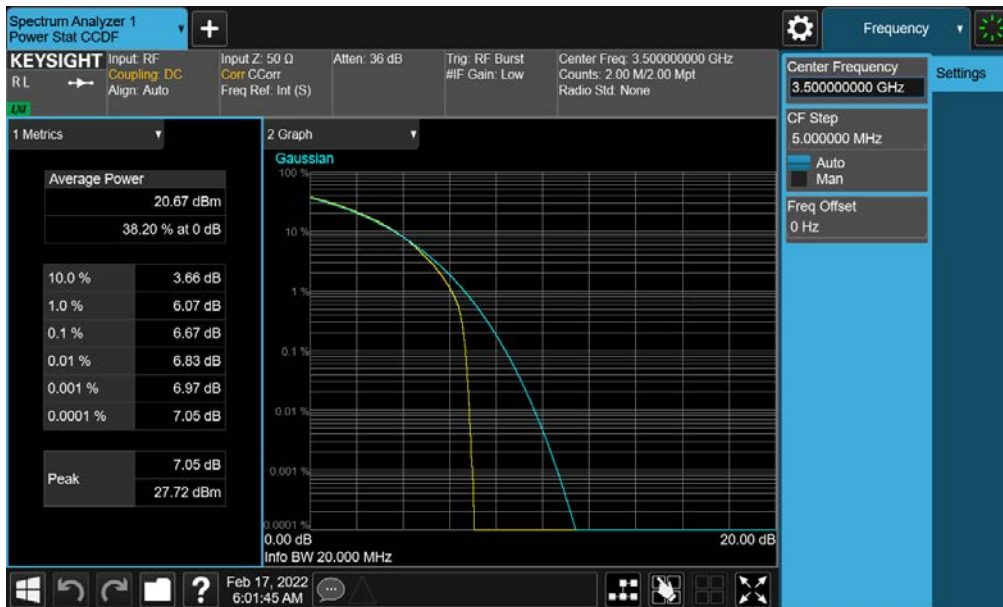
Plot 7-194. PAR Plot (NR Band n77 - 20MHz CP-OFDM QPSK - Full RB- DoD-Band - Ant G - SRS 1)
