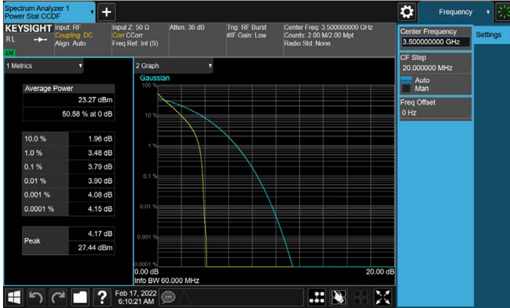
Plot 7-181. PAR Plot (NR Band n77 - 60MHz DFT-s-OFDM BPSK - Full RB- DoD-Band - Ant G - SRS 1)
