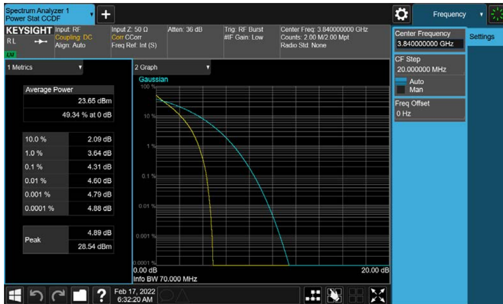
Plot 7-145. PAR Plot (NR Band n77 - 70MHz DFT-s-OFDM BPSK - Full RB- C-Band - Ant G - SRS 1)
