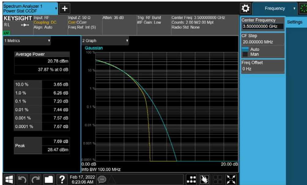
Plot 7-170. PAR Plot (NR Band n77 - 100MHz CP-OFDM QPSK - Full RB– DoD-Band - Ant G - SRS 1)
