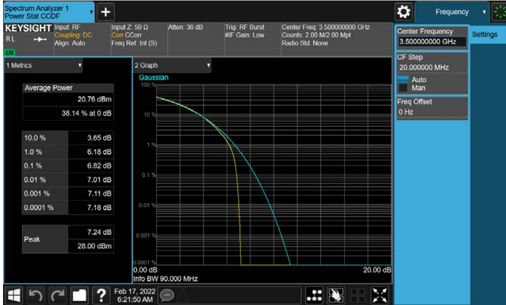
Plot 7-173. PAR Plot (NR Band n77 - 90MHz CP-OFDM QPSK - Full RB- DoD-Band - Ant G - SRS 1)
