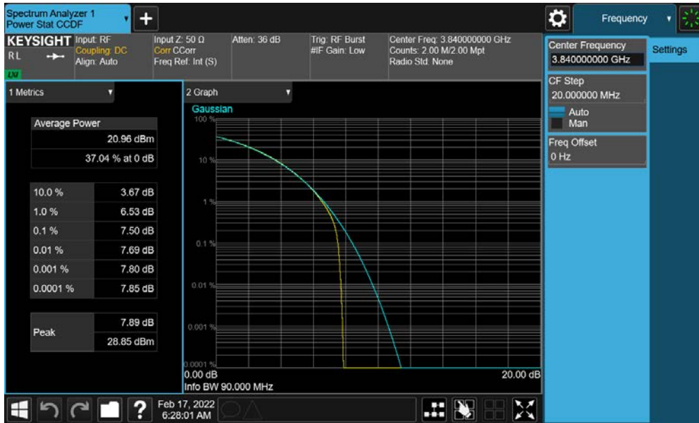
Plot 7-140. PAR Plot (NR Band n77 - 90MHz CP-OFDM QPSK - Full RB- C-Band - Ant G - SRS 1)
