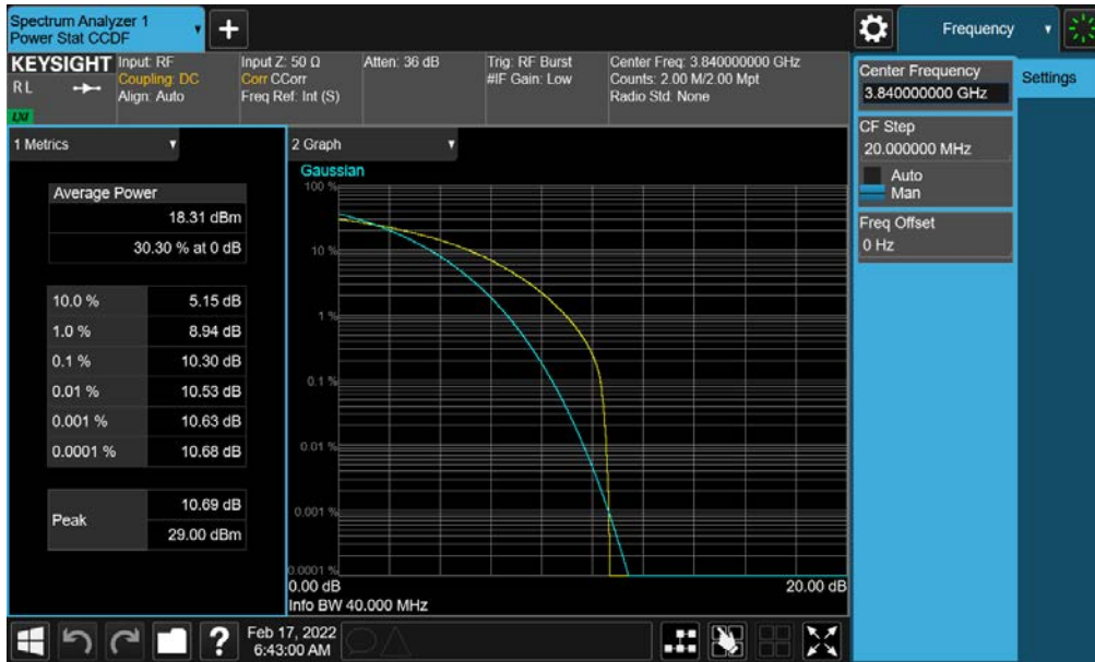
Plot 7-155. PAR Plot (NR Band n77 - 40MHz CP-OFDM QPSK - Full RB- C-Band - Ant G - SRS 1)
