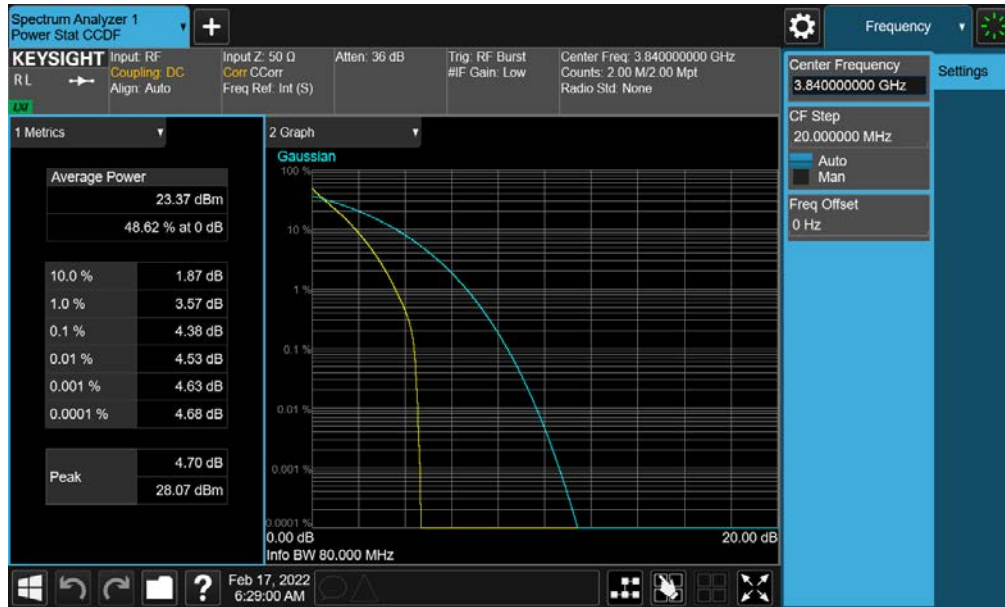
Plot 7-142. PAR Plot (NR Band n77 - 80MHz DFT-s-OFDM BPSK - Full RB- C-Band - Ant G - SRS 1)
