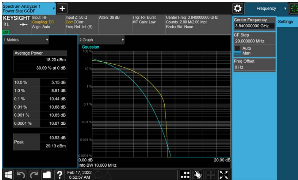
Plot 7-167. PAR Plot (NR Band n77 - 10MHz CP-OFDM QPSK - Full RB- C-Band - Ant G - SRS 1)
