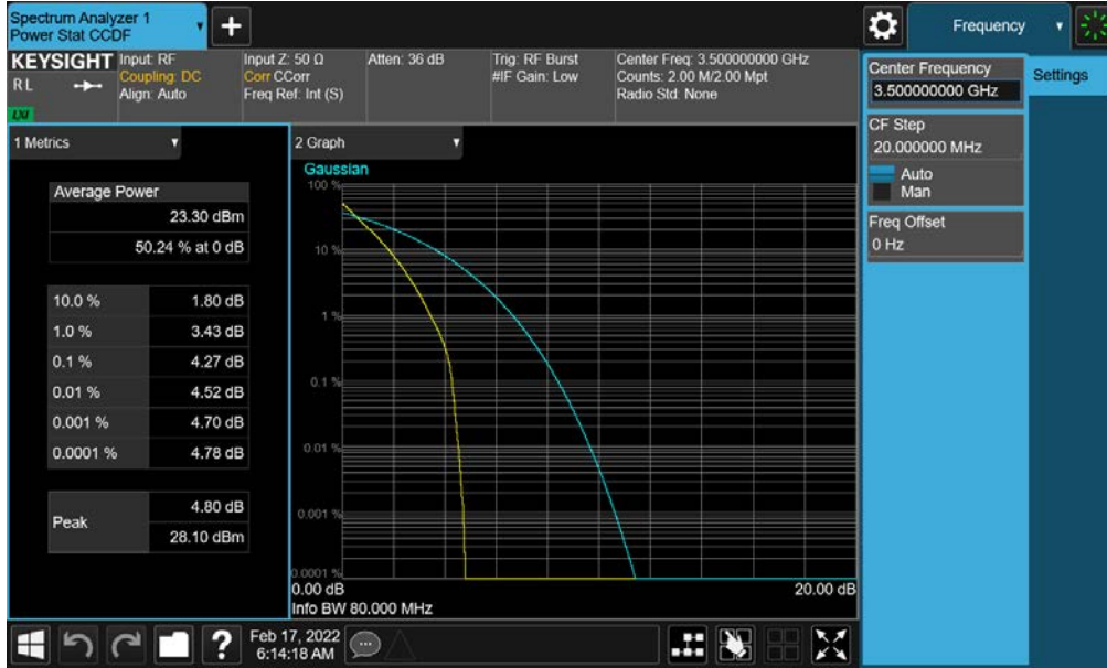
Plot 7-175. PAR Plot (NR Band n77 - 80MHz DFT-s-OFDM BPSK - Full RB- DoD-Band - Ant G - SRS 1)
