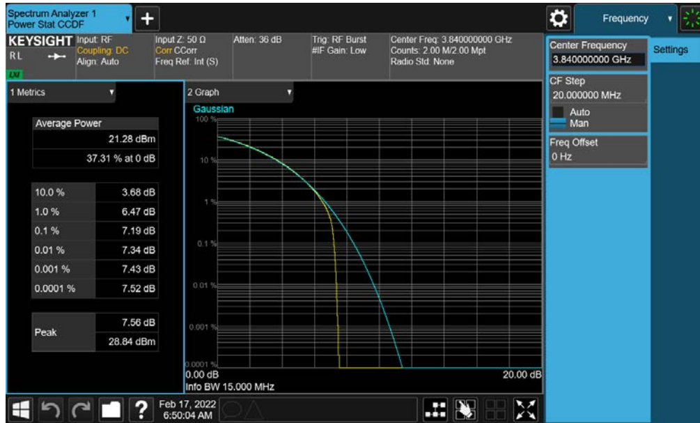
Plot 7-164. PAR Plot (NR Band n77 - 15MHz CP-OFDM QPSK - Full RB- C-Band - Ant G - SRS 1)
