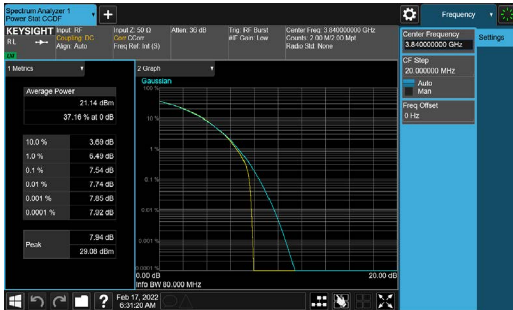
Plot 7-143. PAR Plot (NR Band n77 - 80MHz CP-OFDM QPSK - Full RB- C-Band - Ant G - SRS 1)
