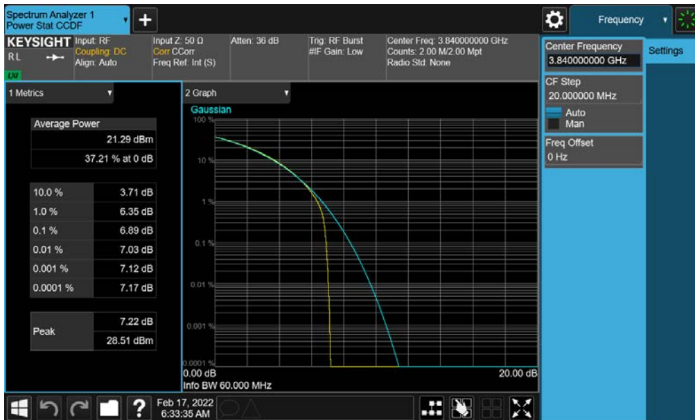
Plot 7-149. PAR Plot (NR Band n77 - 60MHz CP-OFDM QPSK - Full RB- C-Band - Ant G - SRS 1)
