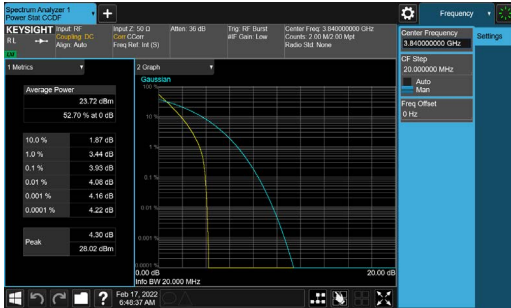
Plot 7-160. PAR Plot (NR Band n77 - 20MHz DFT-s-OFDM BPSK - Full RB- C-Band - Ant G - SRS 1)
