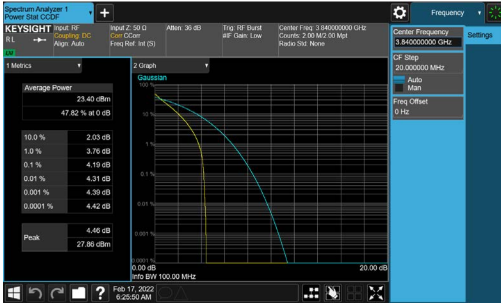
Plot 7-136. PAR Plot (NR Band n77 - 100MHz DFT-s-OFDM BPSK - Full RB– C-Band - Ant G - SRS 1)
