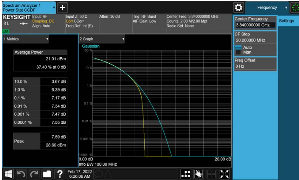
Plot 7-137. PAR Plot (NR Band n77 - 100MHz CP-OFDM QPSK - Full RB– C-Band - Ant G - SRS 1)
