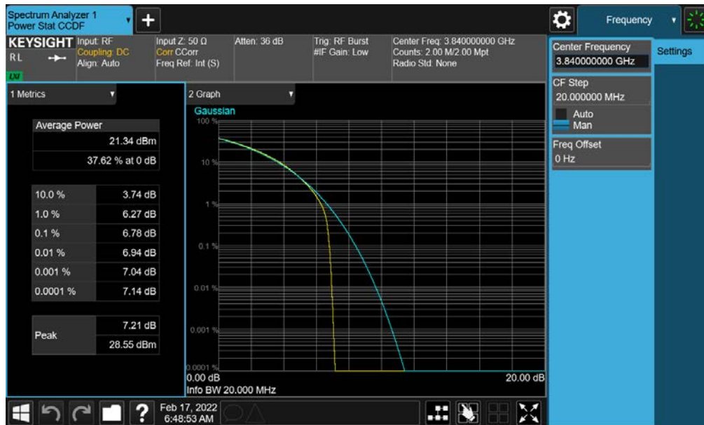
Plot 7-161. PAR Plot (NR Band n77 - 20MHz CP-OFDM QPSK - Full RB- C-Band - Ant G - SRS 1)
