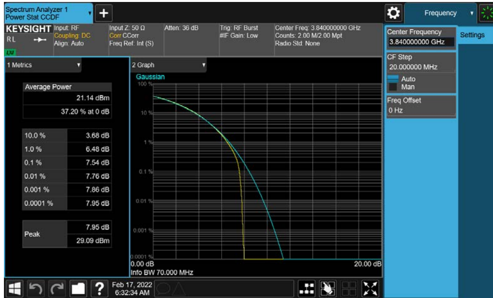
Plot 7-146. PAR Plot (NR Band n77 - 70MHz CP-OFDM QPSK - Full RB- C-Band - Ant G - SRS 1)
