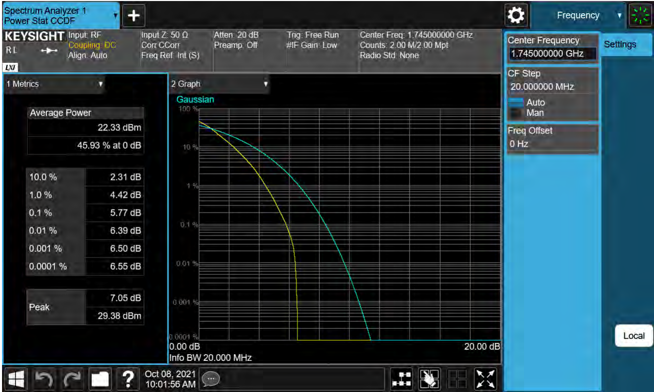
Sub6 n66. PAR Plot (20 M BW_Ch.349000_QPSK_Full RB)
