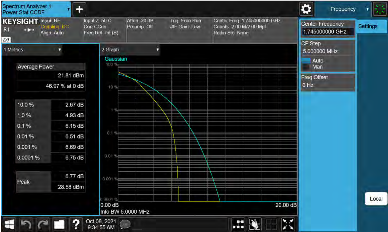
Sub6 n66. PAR Plot (5 M BW_Ch.349000_16QAM_Full RB)
