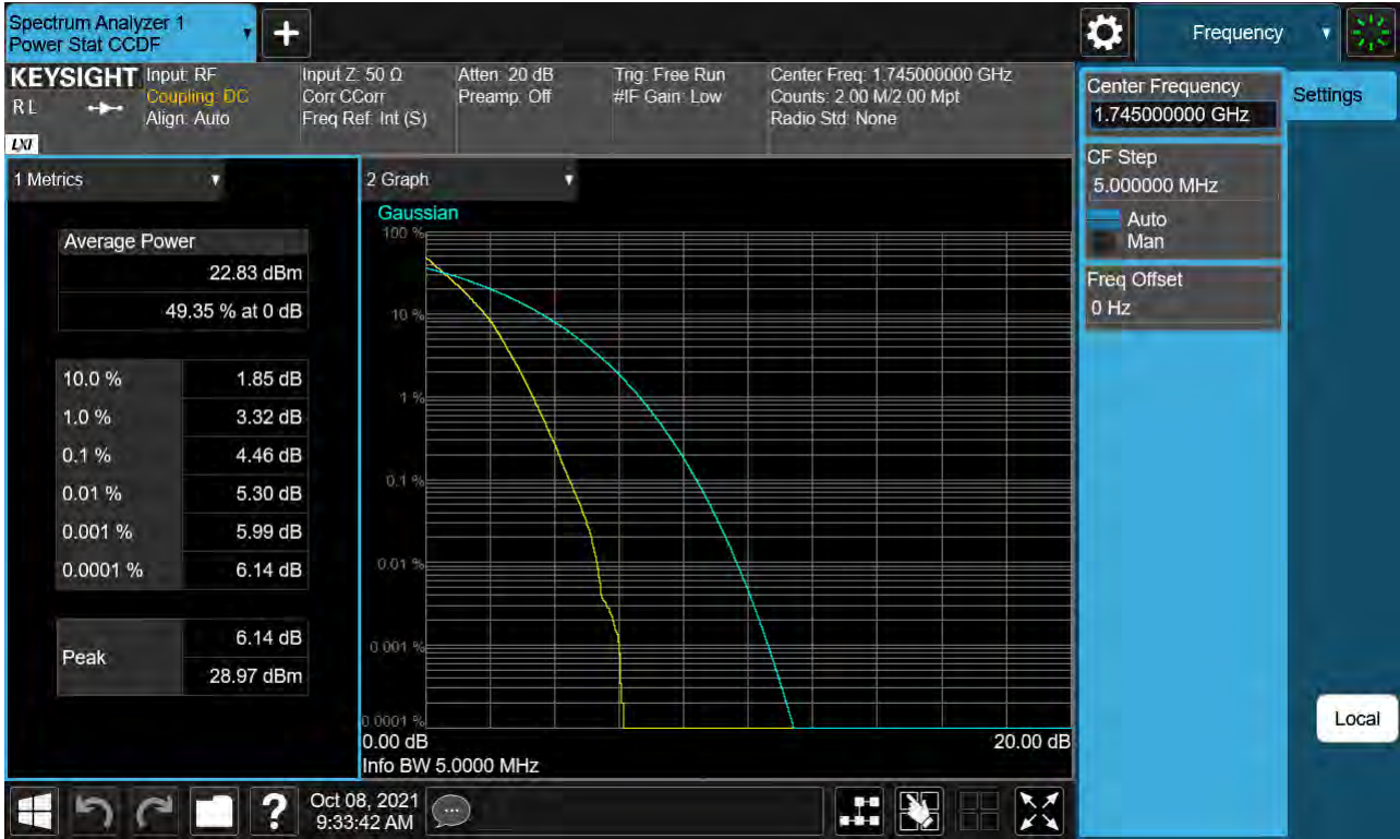
Sub6 n66. PAR Plot (5 M BW_Ch.349000_ BPSK_ Full RB)
