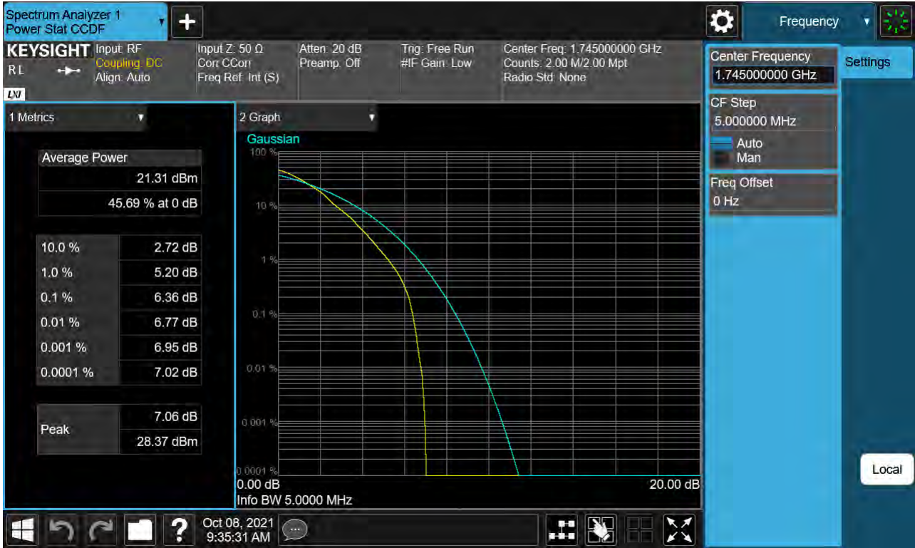
Sub6 n66. PAR Plot (5 M BW_Ch.349000_64QAM_Full RB)
