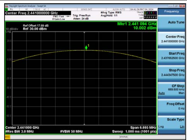
Dual ANT.2 \pi/4 DQPSK : Peak Power (CH. 39)
