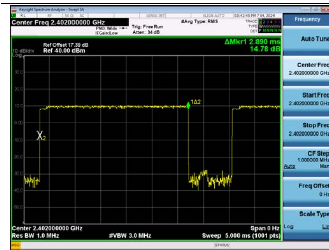
Dual ANT.1 \pi/4 DQPSK : Dwell Time(Ch. 0)
