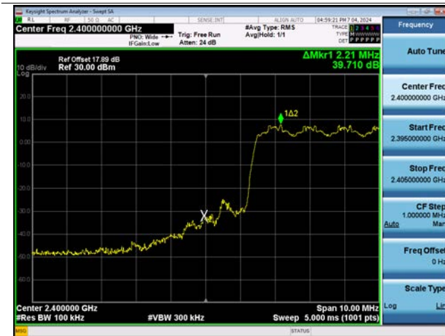
Dual ANT.2 \pi/4 DQPSK Band Edge(CH.0)
