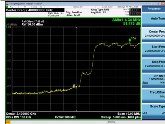
ANT.2 8DPSK Band Edge(CH.0)
