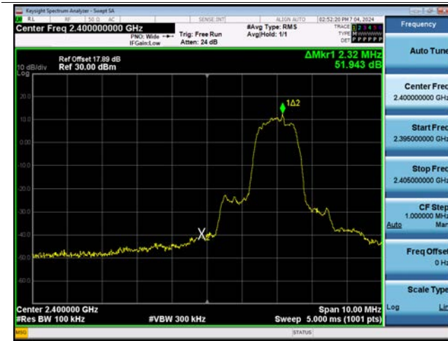
ANT.2 8DPSK Band Edge(CH.0)
