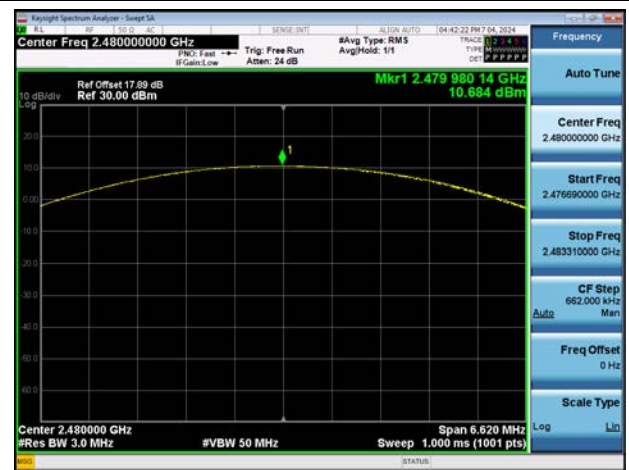
Dual ANT.2 \pi/4 DQPSK : Peak Power (CH. 39)
