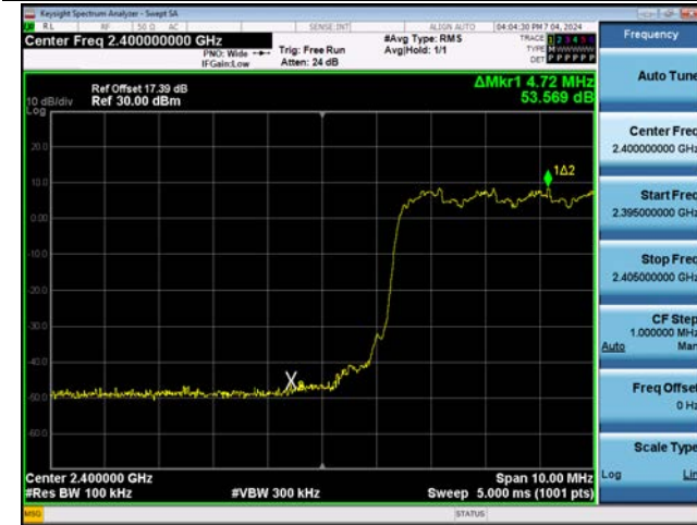
Dual ANT.2 \pi/4 DQPSK Band Edge(CH.0)
