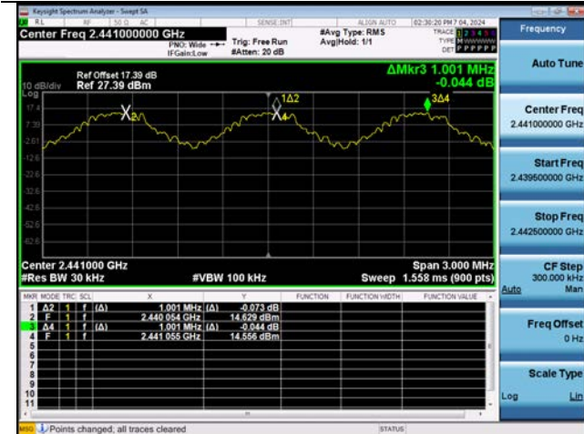
ANT. 1 \pi/4 DQPSK : Channel Separation
