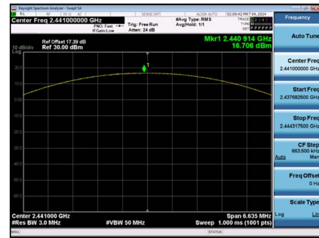
ANT.1 \pi /4DQPSK : Peak Power (CH. 39)
