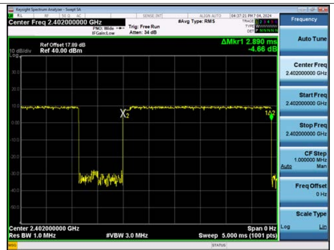
Dual ANT.2 \pi/4 DQPSK : Dwell Time(Ch. 0)
