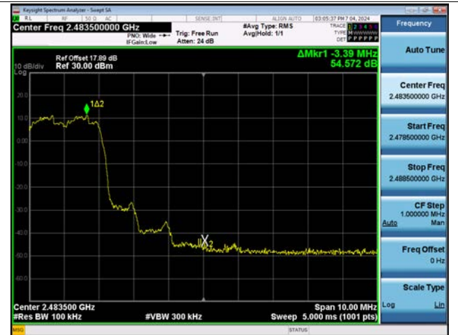
ANT.2 8DPSK Band Edge(CH.78)
