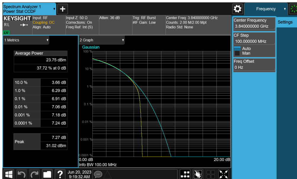
Plot 7-74. PAR Plot (NR Band n77 - 100MHz CP-OFDM QPSK - Full RB – Ant F)
