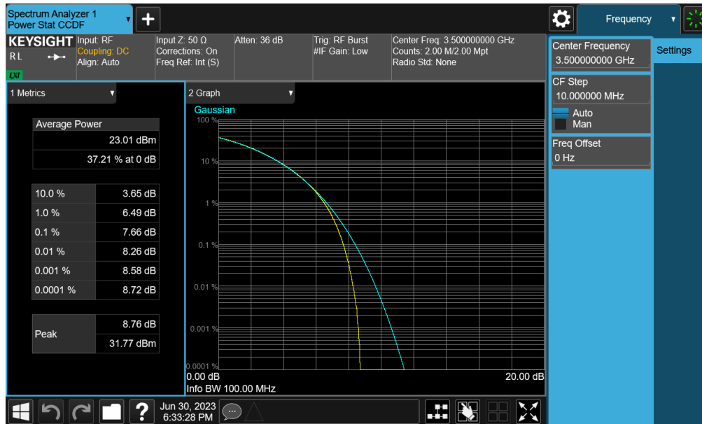
Plot 7-111. PAR Plot (NR Band n77 (DoD) - 100MHz CP-OFDM QPSK - Full RB – Ant F)
