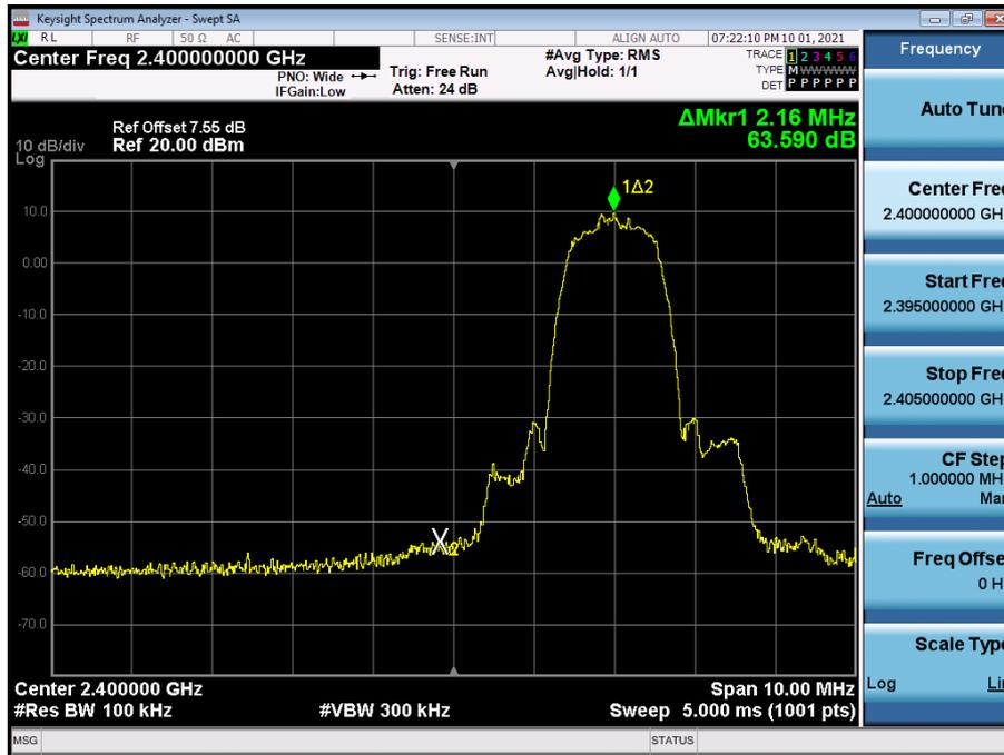
Test Plots without hopping ( $\pi/4$ DQPSK)
