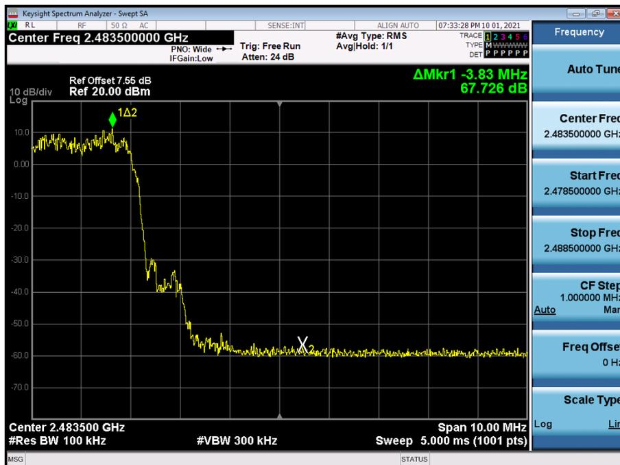
Test Plots with hopping ( $\pi/4$ DQPSK)
