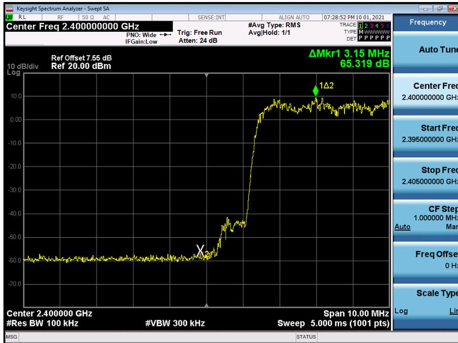
Test Plots with hopping ( $\pi/4$ DQPSK)
