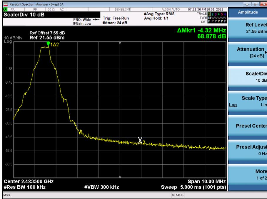
Test Plots without hopping ( $\pi/4$ DQPSK)
