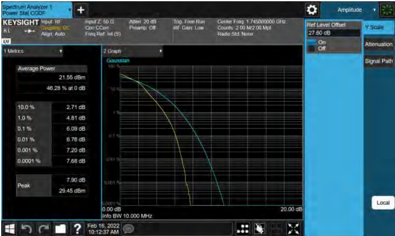
Sub6 n66. PAR Plot (10 M BW_Ch.349000_16QAM_Full RB)
