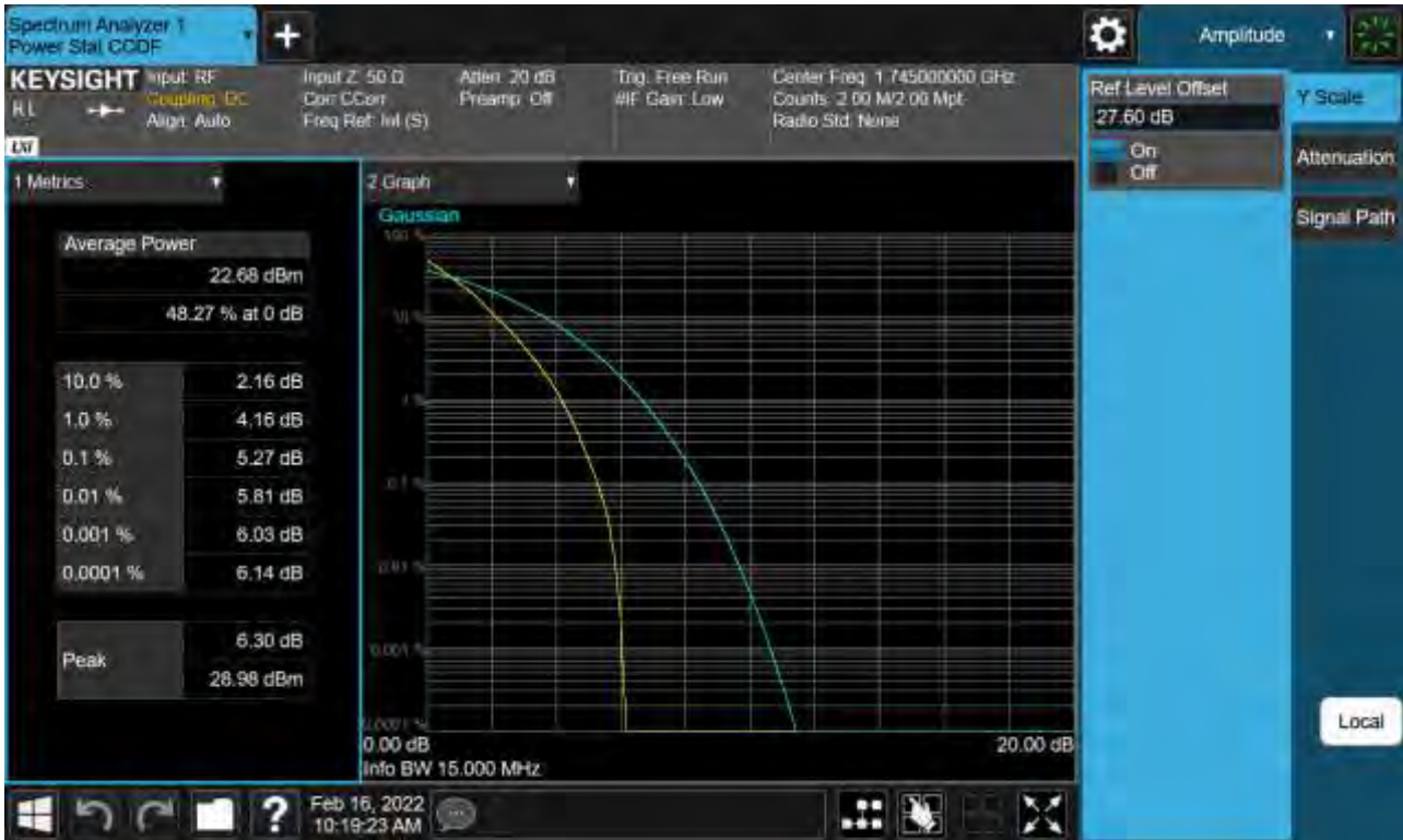
Sub6 n66. PAR Plot (15 M BW_Ch.349000_QPSK_Full RB)
