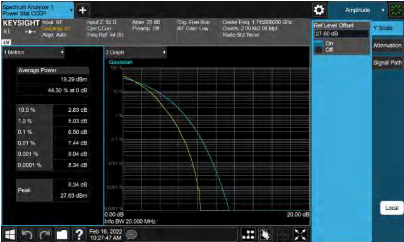
Sub6 n66. PAR Plot (20 M BW_Ch.349000_256QAM_Full RB)
