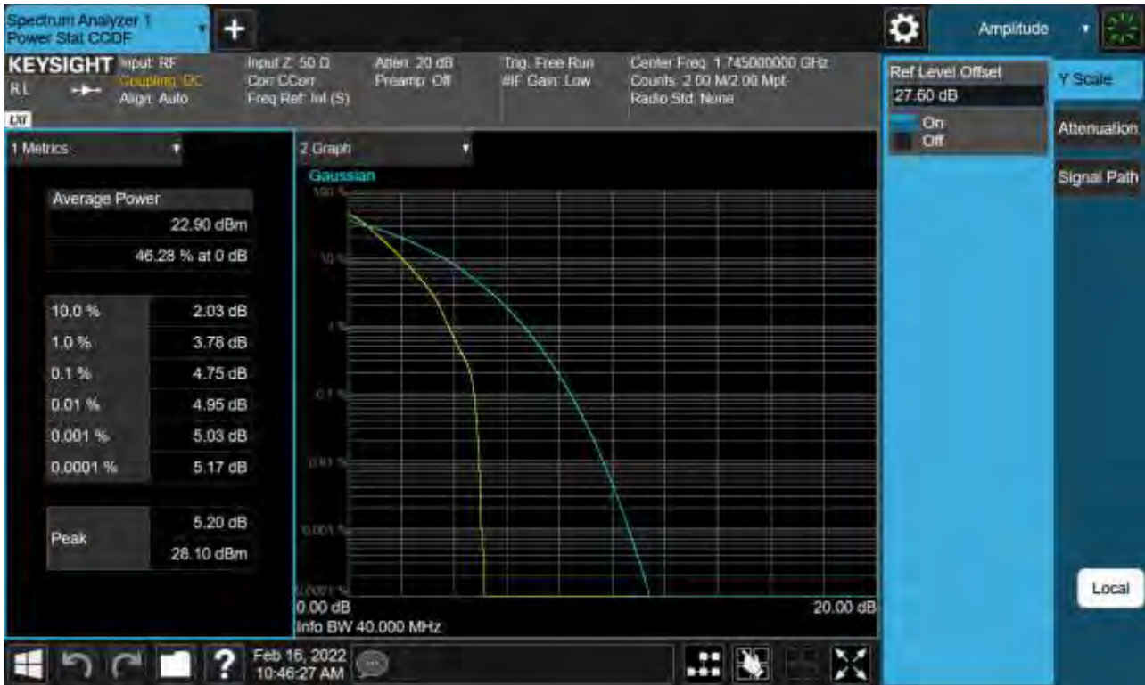
Sub6 n66. PAR Plot (40 M BW_Ch.349000_ BPSK_ Full RB)
