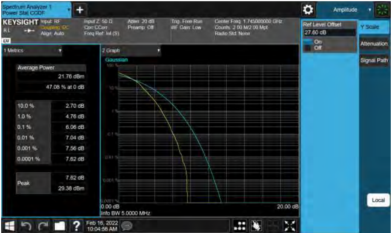
Sub6 n66. PAR Plot (5 M BW_Ch.349000_16QAM_Full RB)
