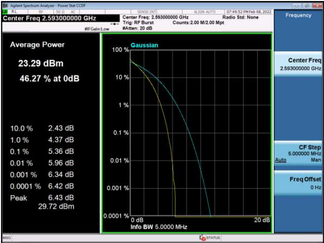
PAR Plot (5 M BW_Ch.40620_QPSK_RB25_0)
