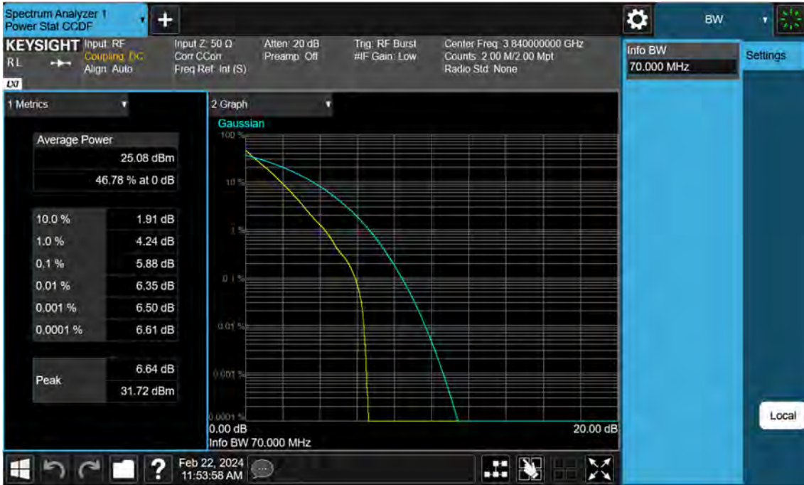
Sub6 n77. PAR Plot (70 M BW_Ch.656000_ BPSK)
