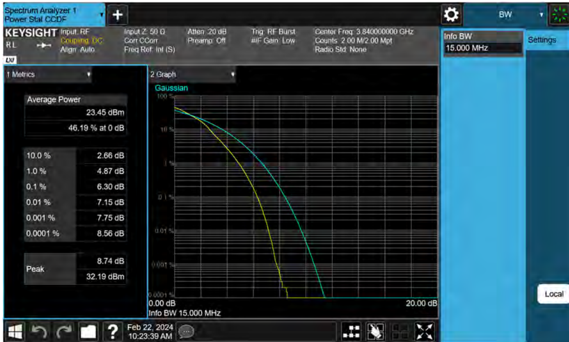
Sub6 n77. PAR Plot (15 M BW_Ch.656000_16QAM)
