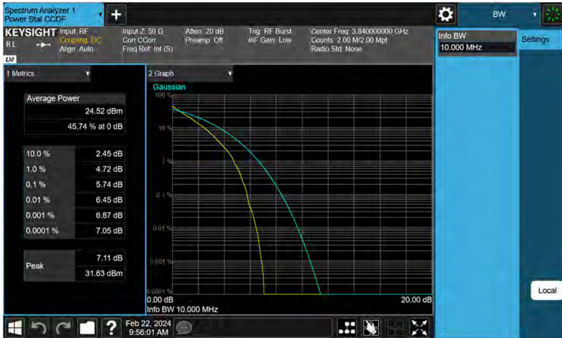
Sub6 n77. PAR Plot (10 M BW_Ch.656000_QPSK)
