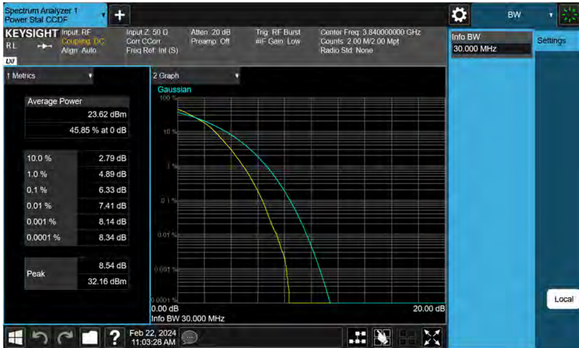
Sub6 n77. PAR Plot (30 M BW_Ch.656000_16QAM)
