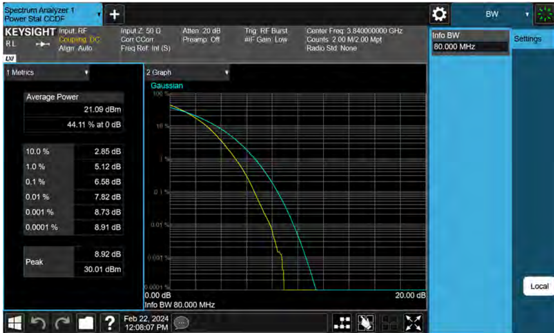
Sub6 n77. PAR Plot (80 M BW_Ch.656000_256QAM)
