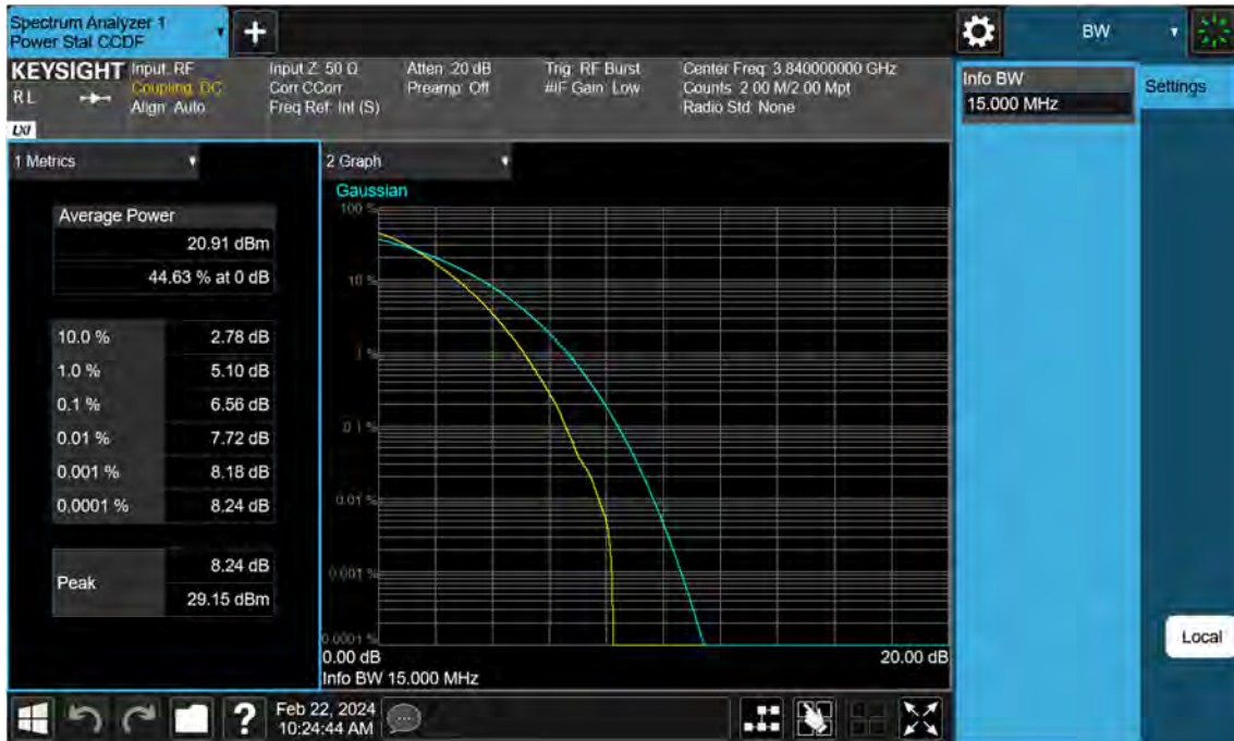
Sub6 n77. PAR Plot (15 M BW_Ch.656000_256QAM)
