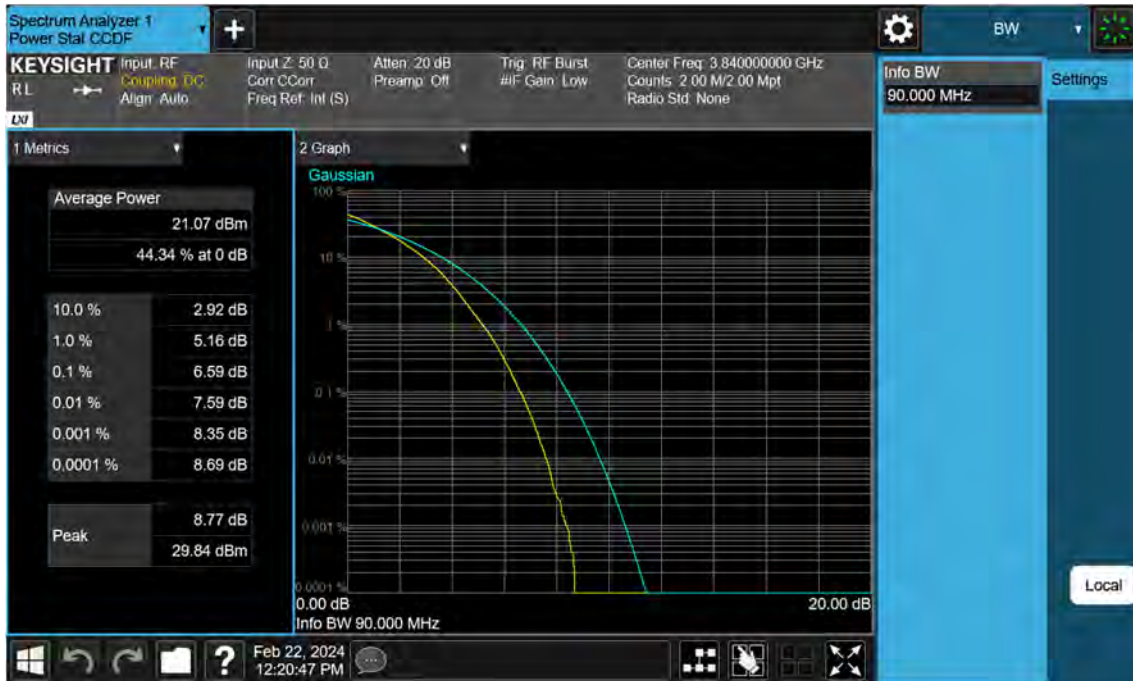
Sub6 n77. PAR Plot (90 M BW_Ch.656000_256QAM)
