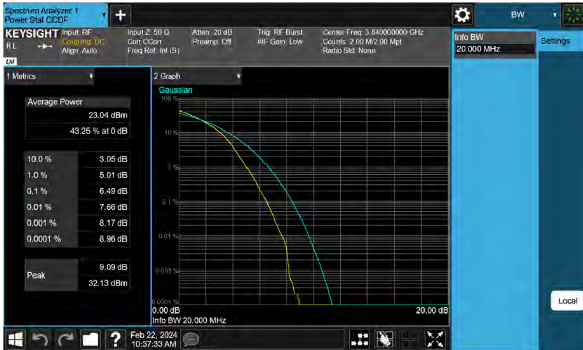
Sub6 n77. PAR Plot (20 M BW_Ch.656000_64QAM)
