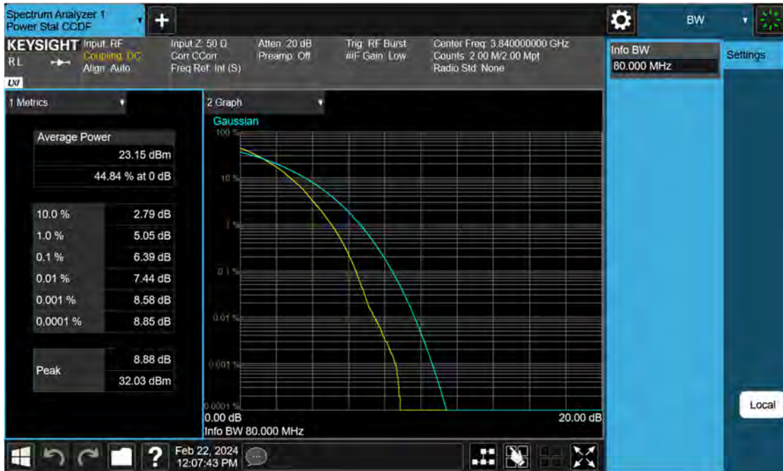
Sub6 n77. PAR Plot (80 M BW_Ch.656000_64QAM)
