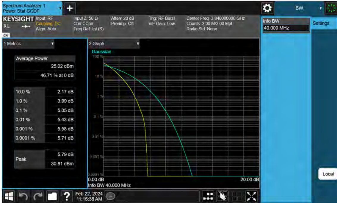
Sub6 n77. PAR Plot (40 M BW_Ch.656000_ BPSK)
