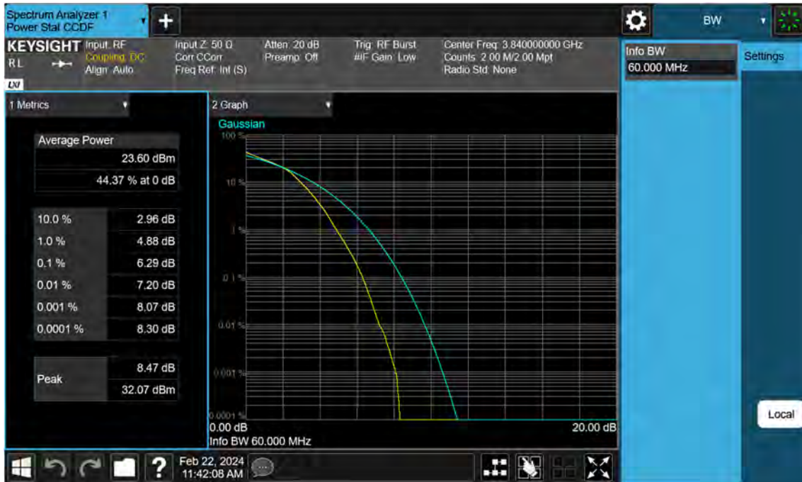
Sub6 n77. PAR Plot (60 M BW_Ch.656000_16QAM)
