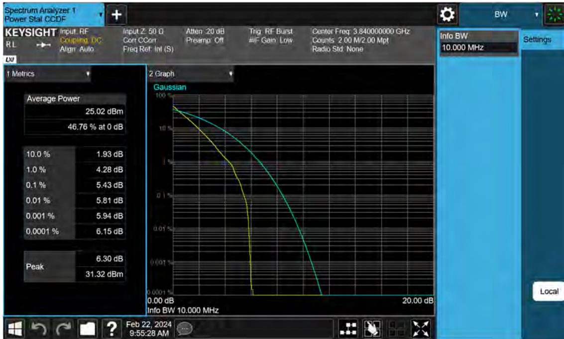
Sub6 n77. PAR Plot (10 M BW_Ch.656000_ BPSK)
