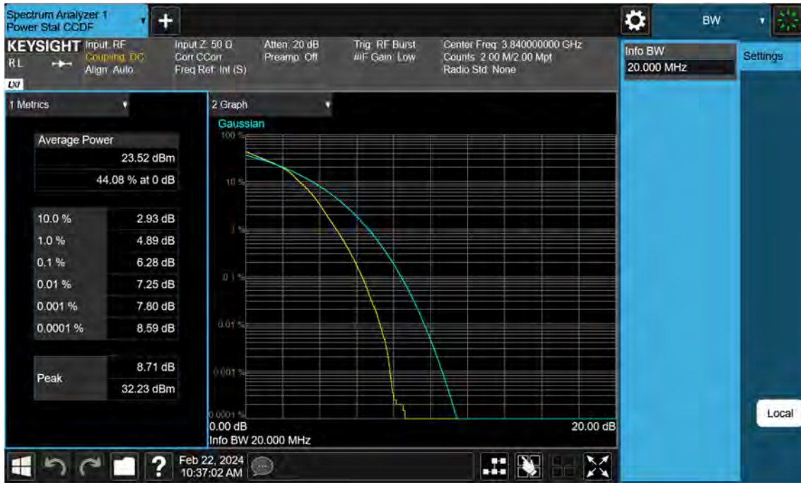
Sub6 n77. PAR Plot (20 M BW_Ch.656000_16QAM)
