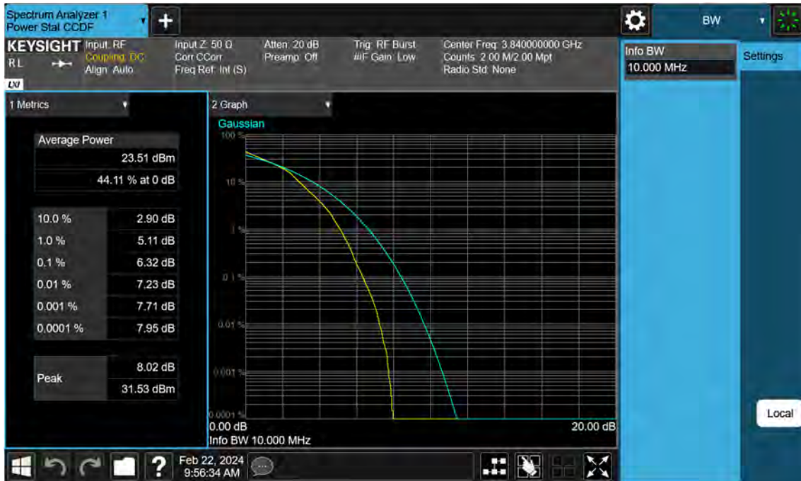
Sub6 n77. PAR Plot (10 M BW_Ch.656000_16QAM)
