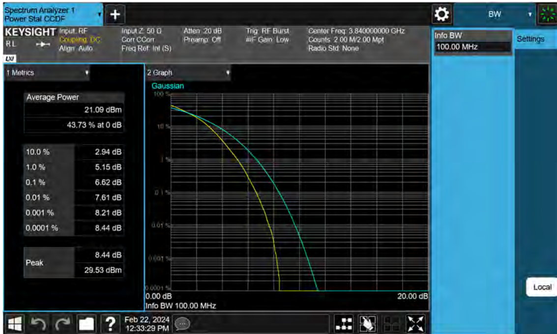
Sub6 n77. PAR Plot (100 M BW_Ch.656000_256QAM)
