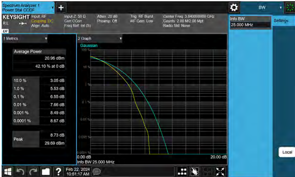
Sub6 n77. PAR Plot (25 M BW_Ch.656000_256QAM)
