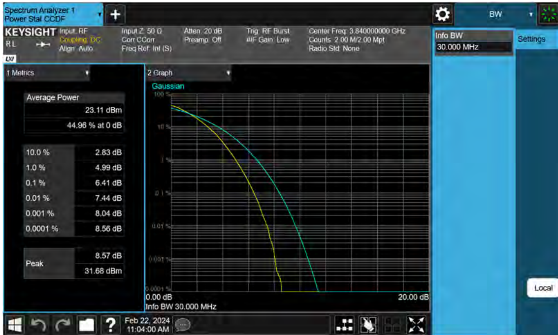
Sub6 n77. PAR Plot (30 M BW_Ch.656000_64QAM)
