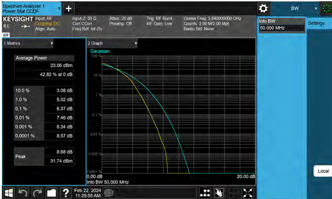
Sub6 n77. PAR Plot (50 M BW_Ch.656000_64QAM)
