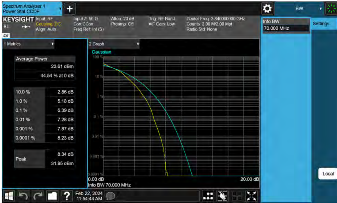
Sub6 n77. PAR Plot (70 M BW_Ch.656000_16QAM)
