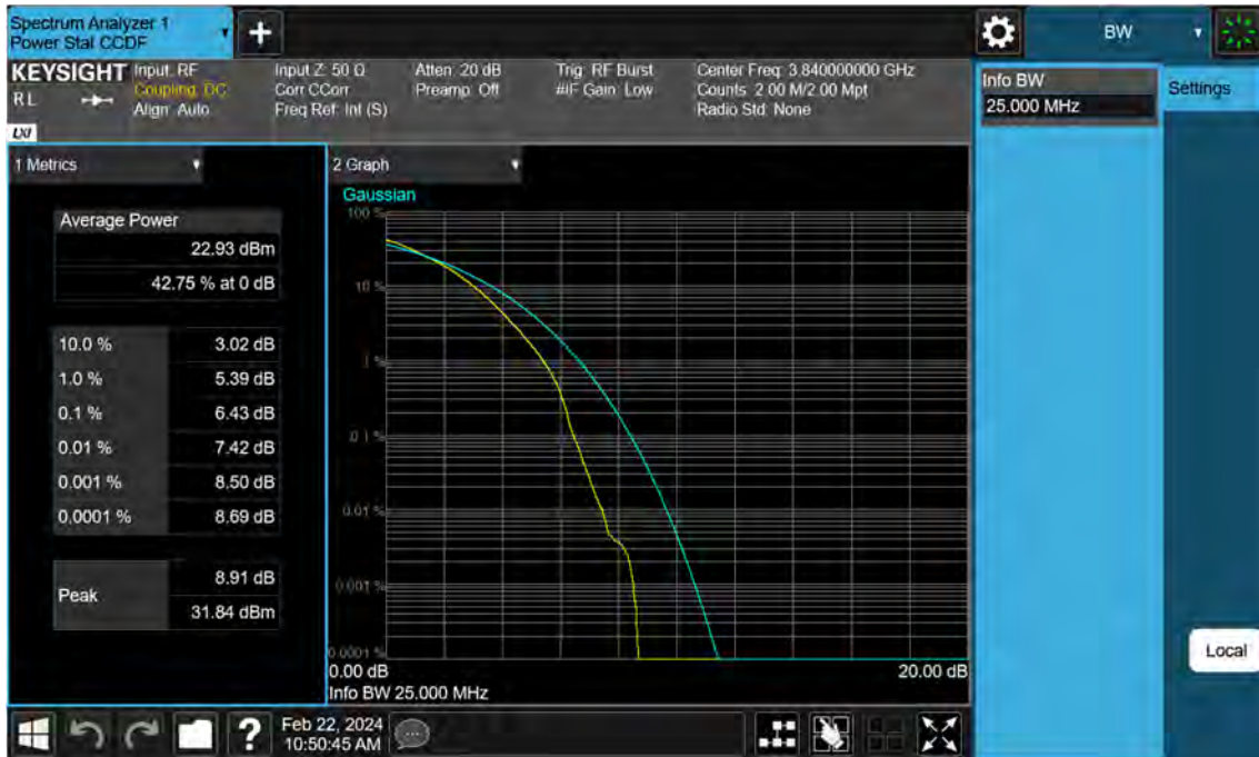
Sub6 n77. PAR Plot (25 M BW_Ch.656000_64QAM)
