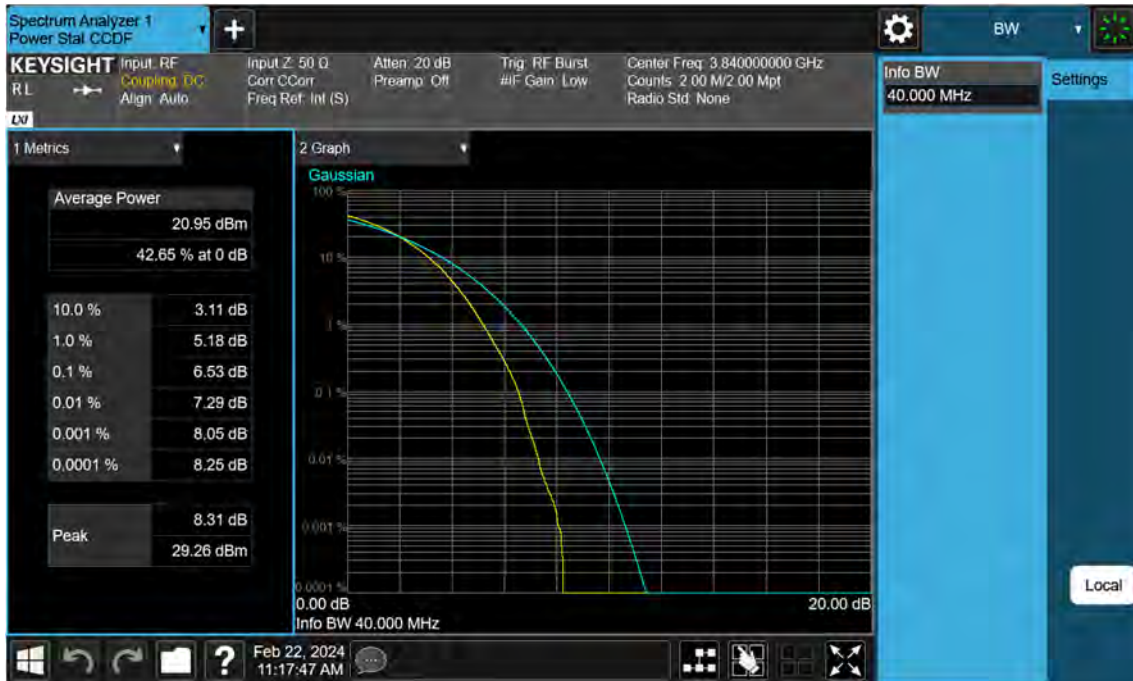
Sub6 n77. PAR Plot (40 M BW_Ch.656000_256QAM)
