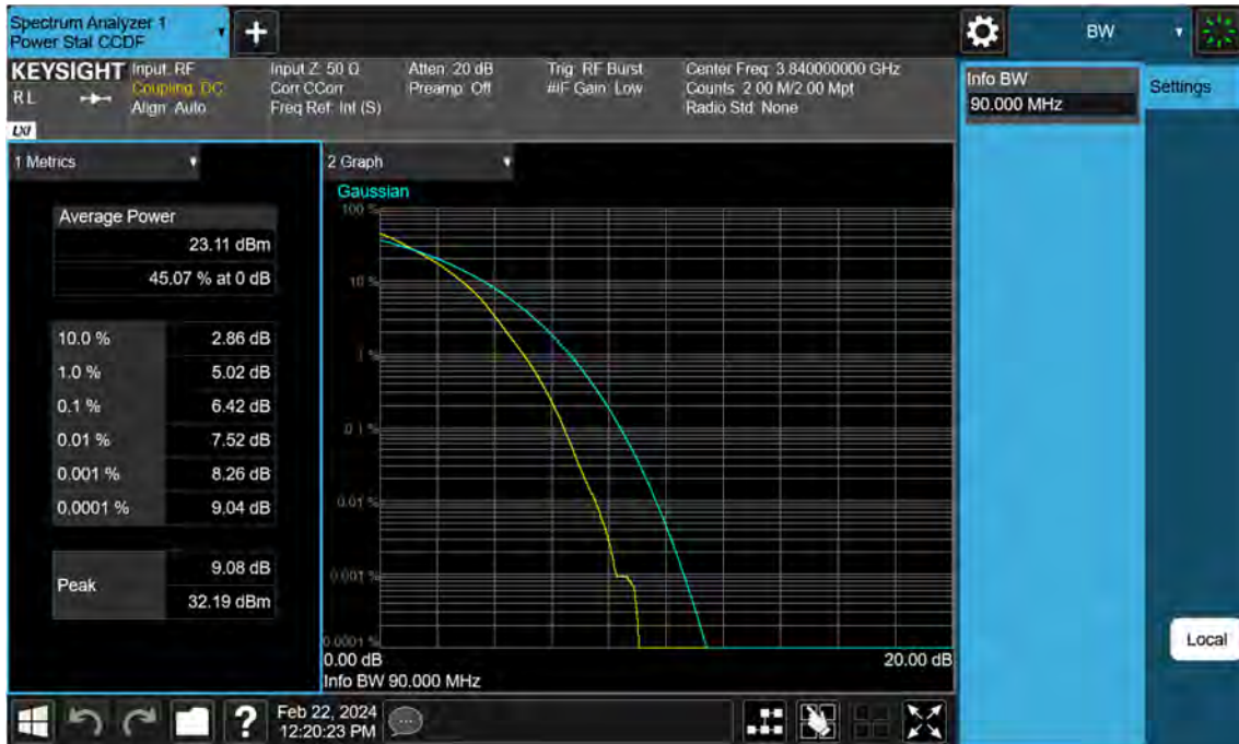
Sub6 n77. PAR Plot (90 M BW_Ch.656000_64QAM)
