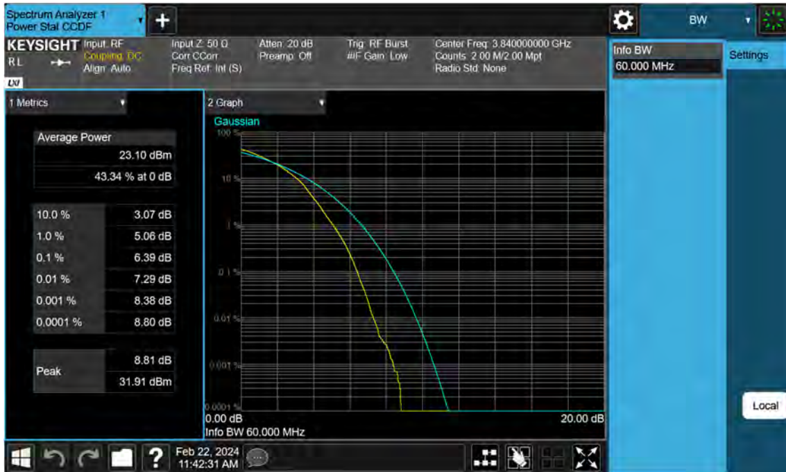
Sub6 n77. PAR Plot (60 M BW_Ch.656000_64QAM)
