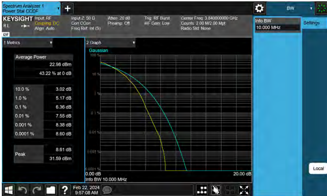
Sub6 n77. PAR Plot (10 M BW_Ch.656000_64QAM)
