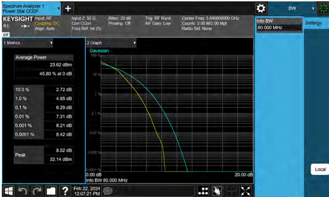
Sub6 n77. PAR Plot (80 M BW_Ch.656000_16QAM)
