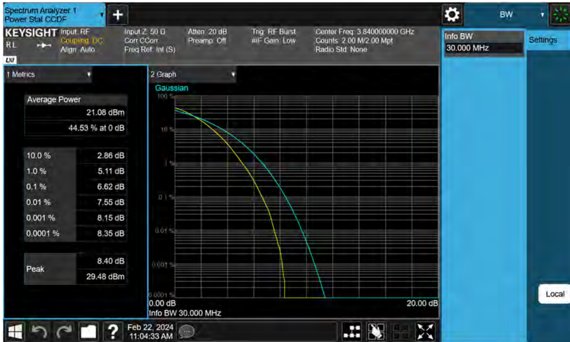
Sub6 n77. PAR Plot (30 M BW_Ch.656000_256QAM)
