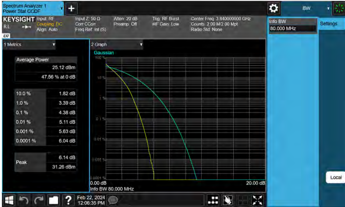
Sub6 n77. PAR Plot (80 M BW_Ch.656000_ BPSK)
