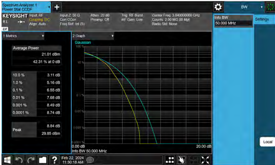
Sub6 n77. PAR Plot (50 M BW_Ch.656000_256QAM)
