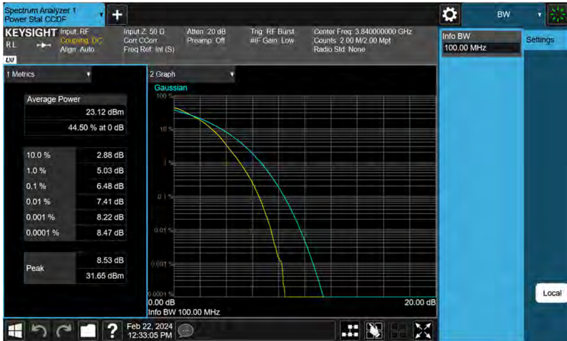
Sub6 n77. PAR Plot (100 M BW_Ch.656000_64QAM)
