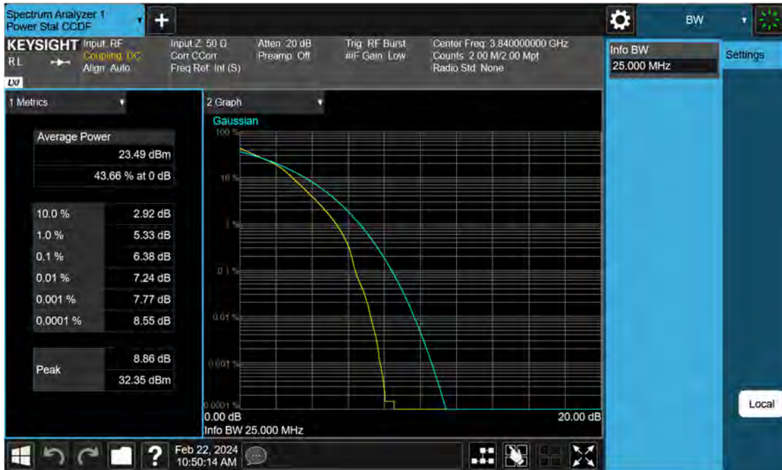
Sub6 n77. PAR Plot (25 M BW_Ch.656000_16QAM)
