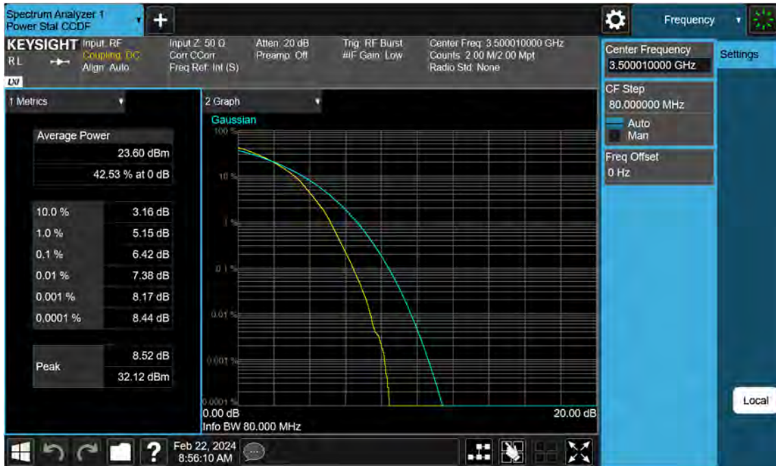
Sub6 n77. PAR Plot (80 M BW_Ch.633334_64QAM)
