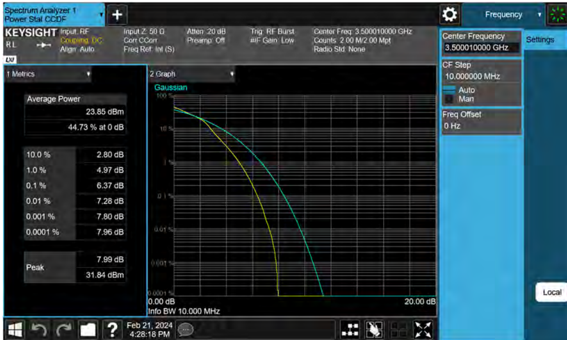
Sub6 n77. PAR Plot (10 M BW_Ch.633334_16QAM)
