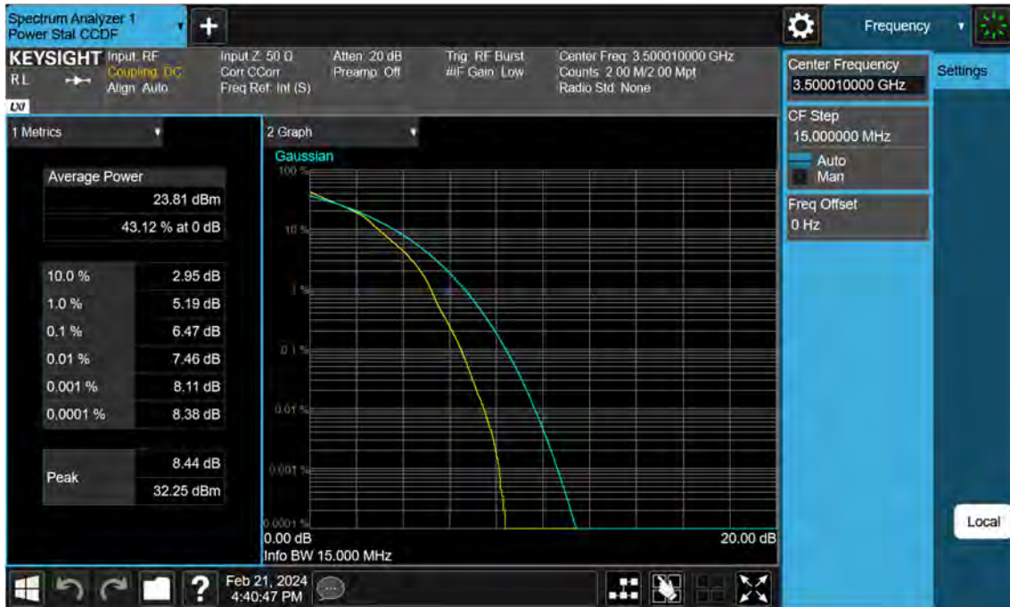
Sub6 n77. PAR Plot (15 M BW_Ch.633334_16QAM)
