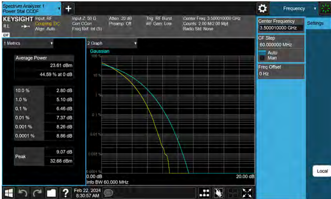
Sub6 n77. PAR Plot (60 M BW_Ch.633334_64QAM)
