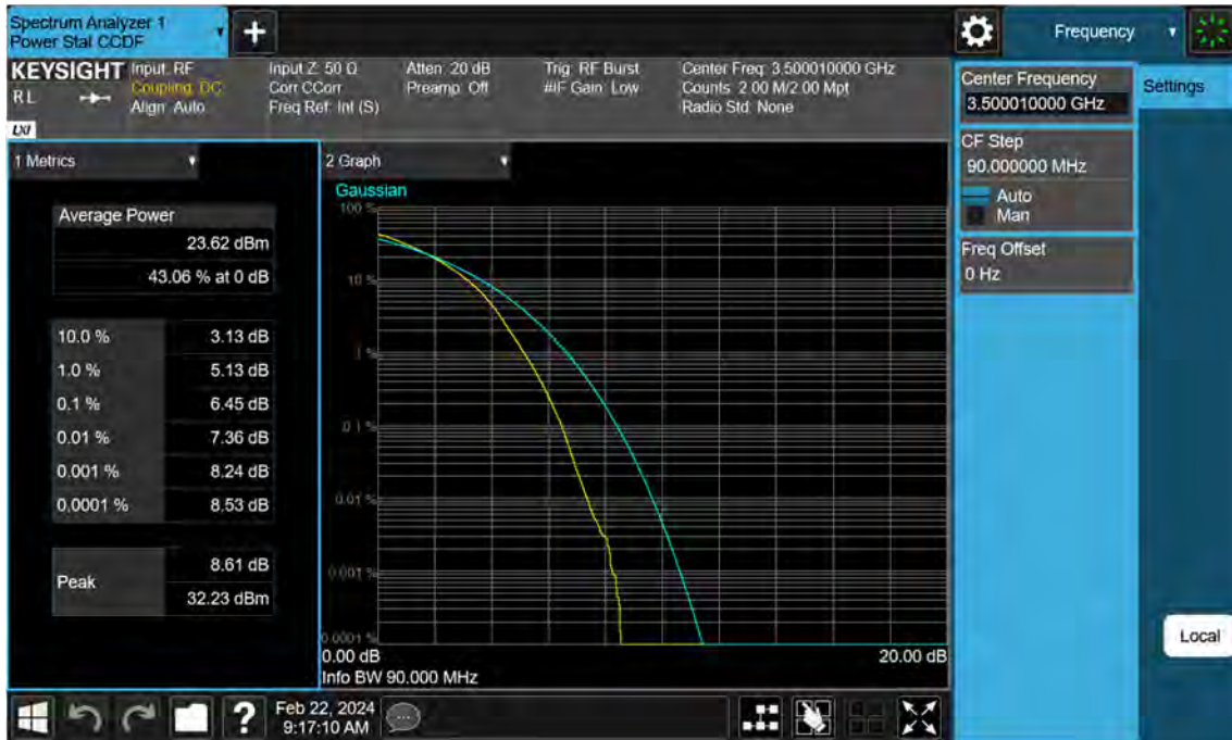
Sub6 n77. PAR Plot (90 M BW_Ch.633334_64QAM)
