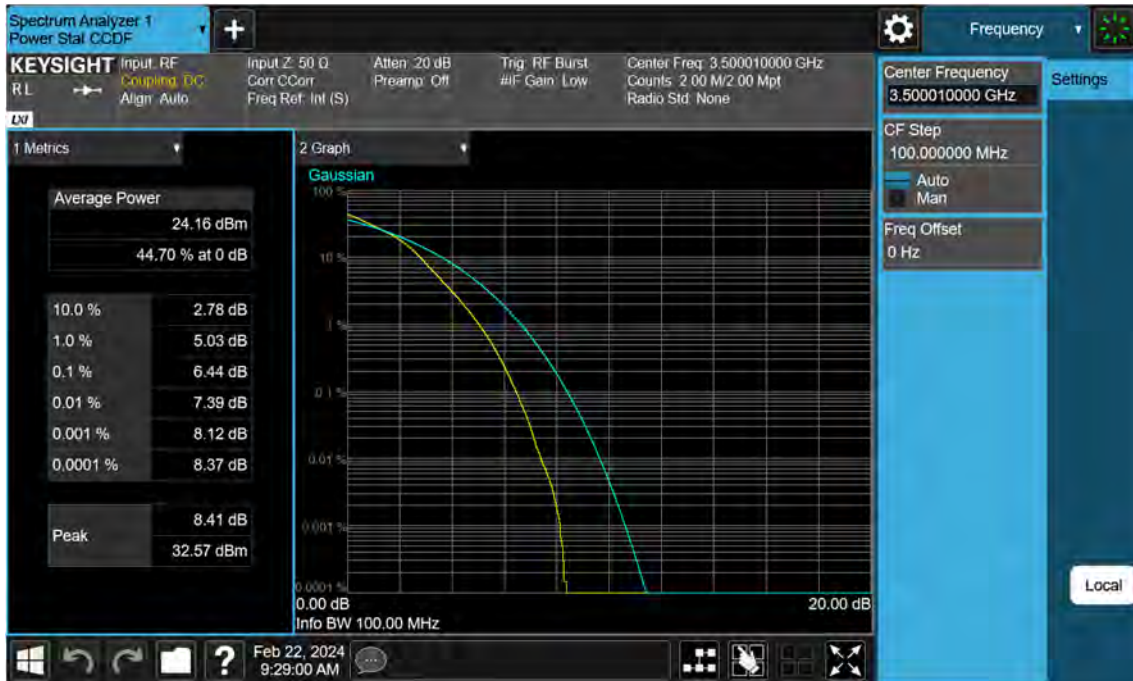
Sub6 n77. PAR Plot (100 M BW_Ch.633334_16QAM)
