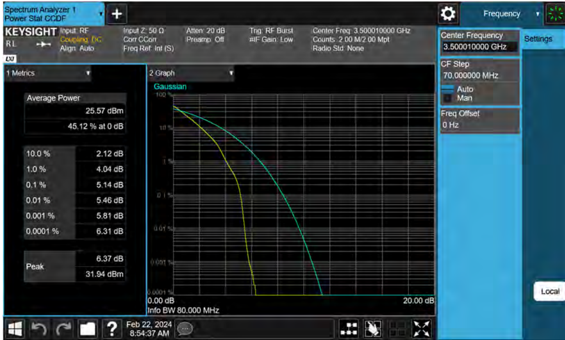
Sub6 n77. PAR Plot (80 M BW_Ch.633334_ BPSK)
