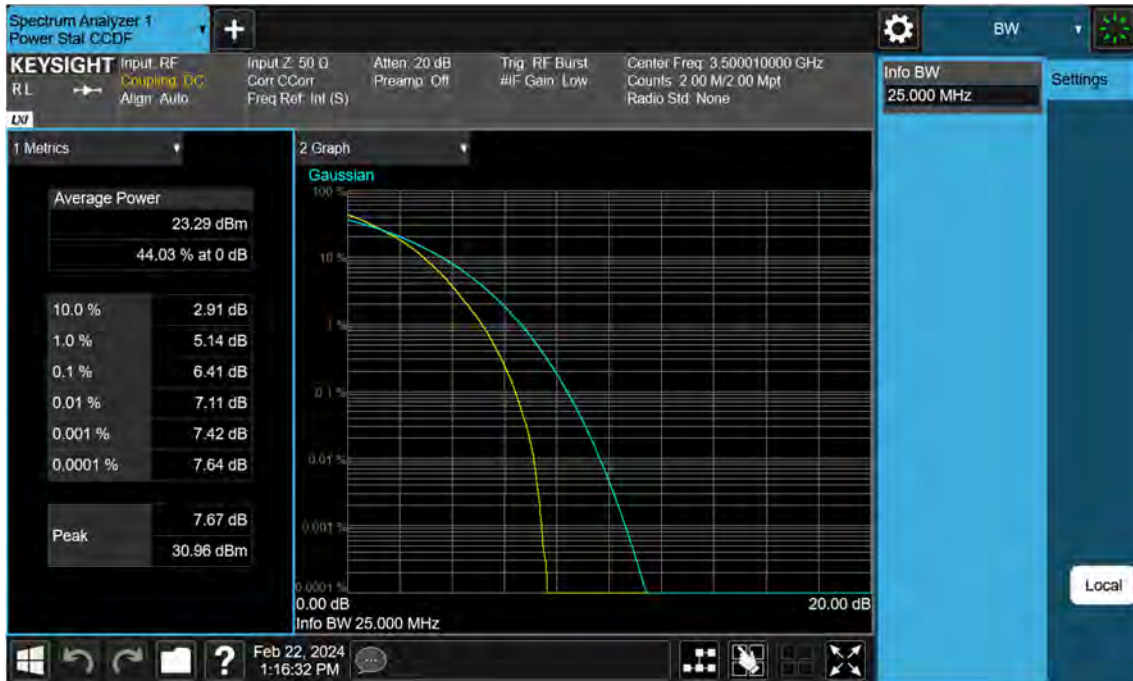
Sub6 n77. PAR Plot (25 M BW_Ch.633334_64QAM)
