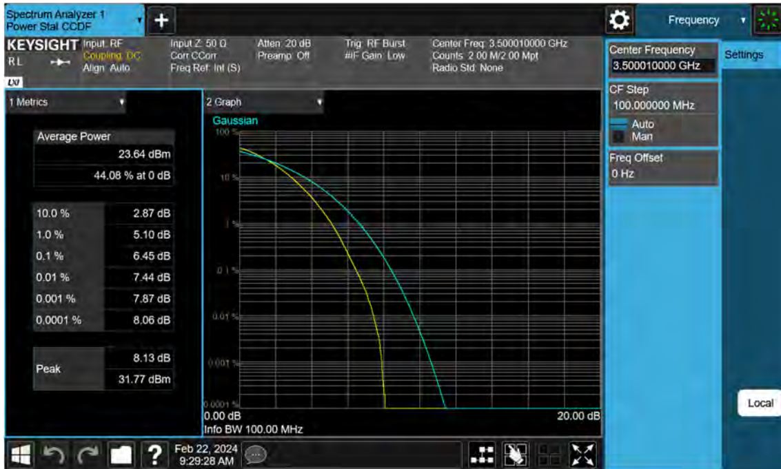
Sub6 n77. PAR Plot (100 M BW_Ch.633334_64QAM)
