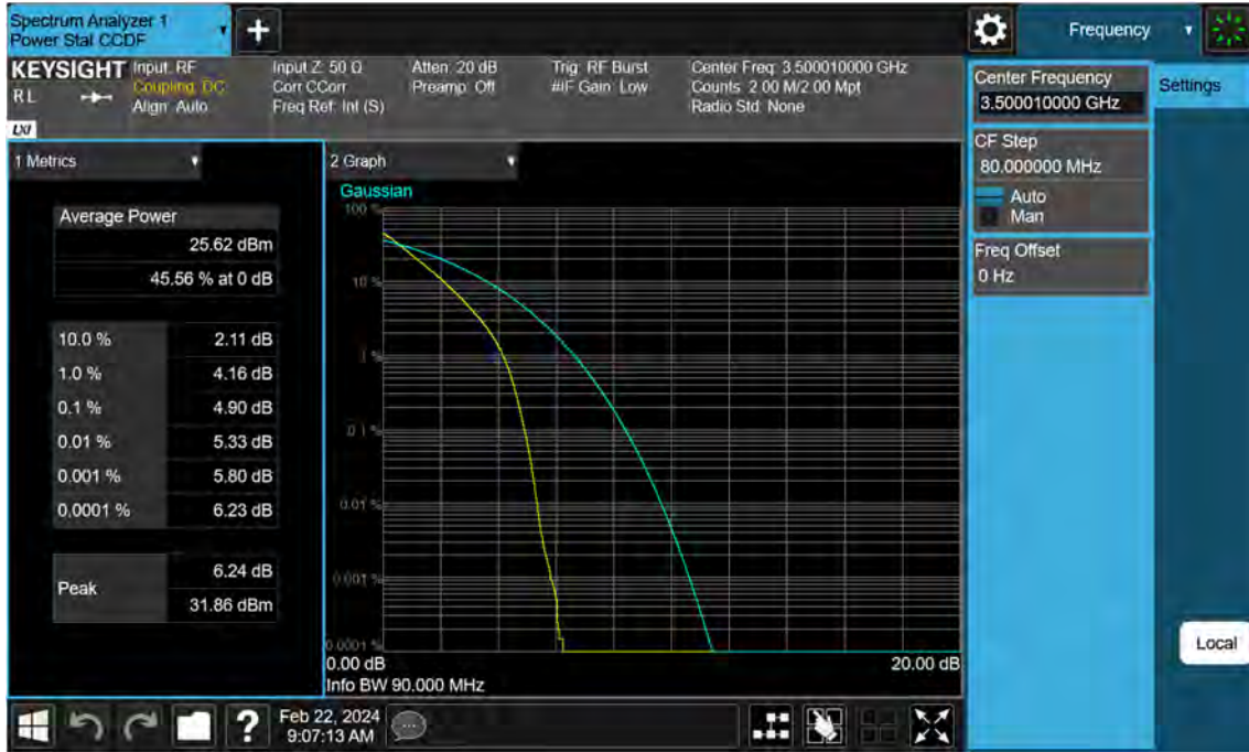
Sub6 n77. PAR Plot (90 M BW_Ch.633334_ BPSK)
