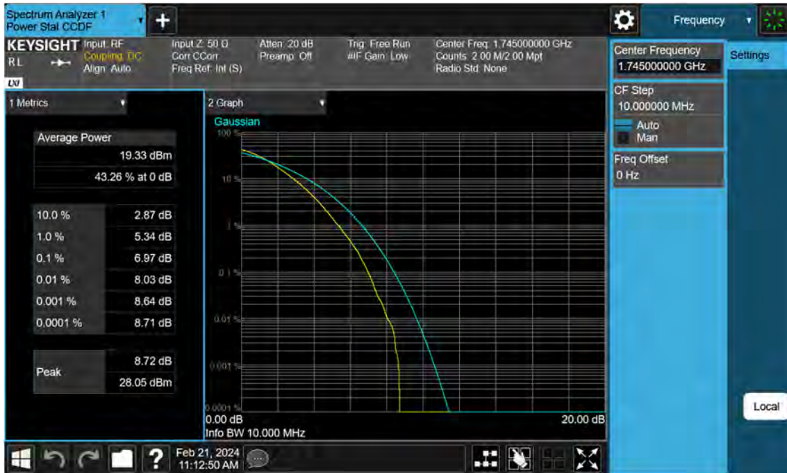
Sub6 n66. PAR Plot (10 M BW_Ch.349000_256QAM_Full RB)
