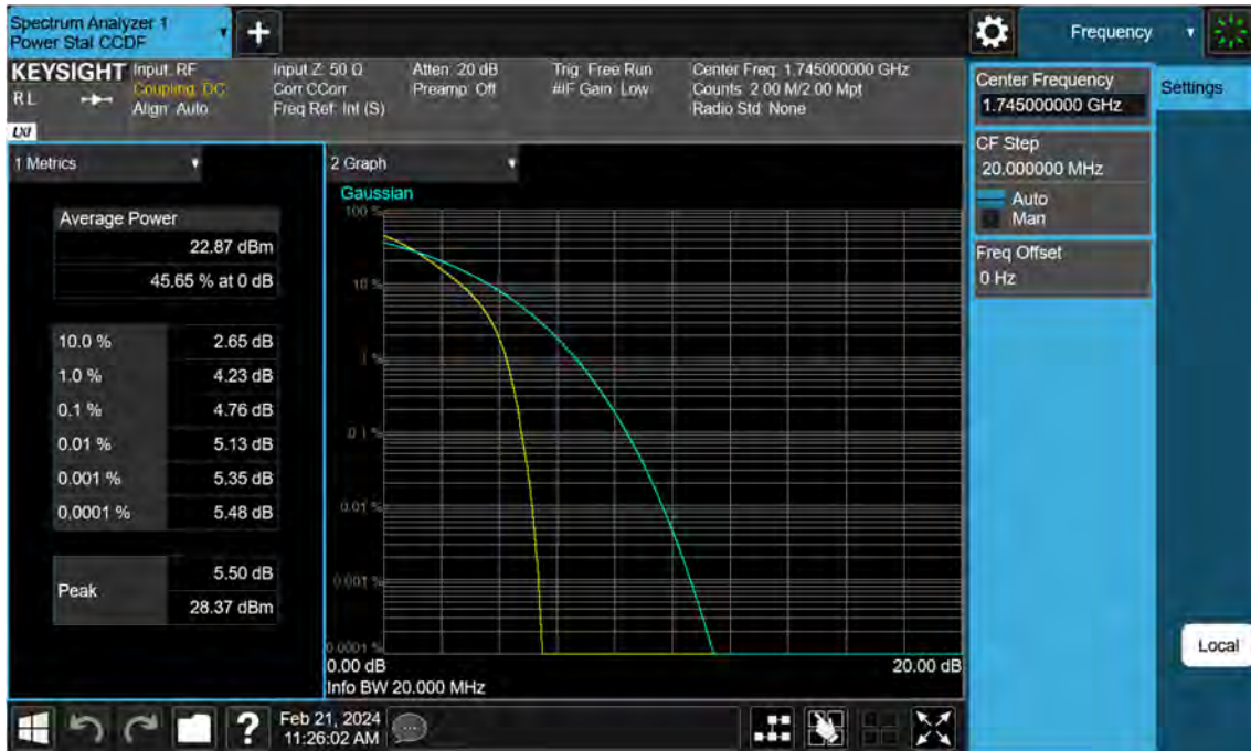
Sub6 n66. PAR Plot (20 M BW_Ch.349000_QPSK_Full RB)
