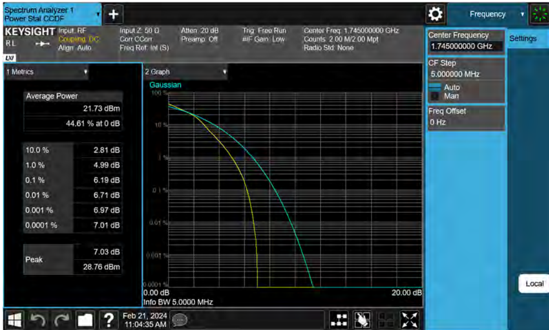
Sub6 n66. PAR Plot (5 M BW_Ch.349000_16QAM_Full RB)
