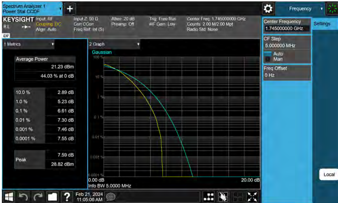
Sub6 n66. PAR Plot (5 M BW_Ch.349000_64QAM_Full RB)
