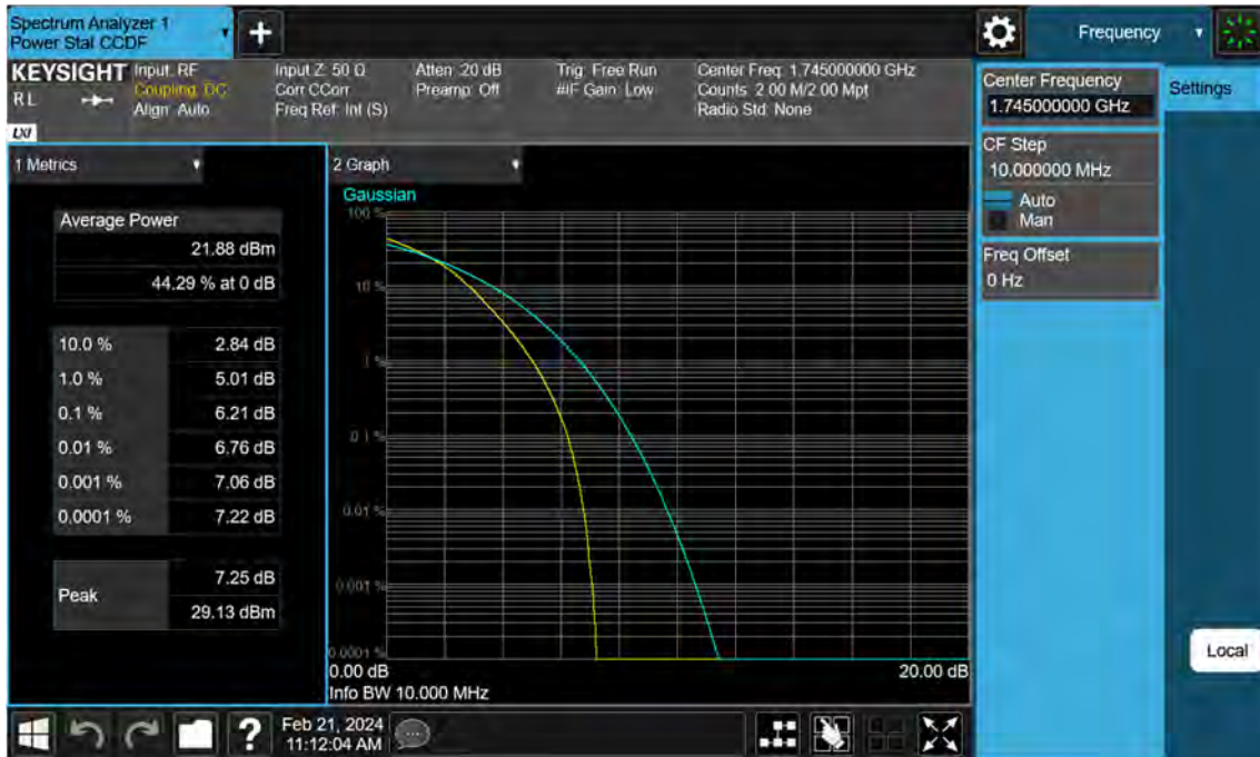
Sub6 n66. PAR Plot (10 M BW_Ch.349000_16QAM_Full RB)
