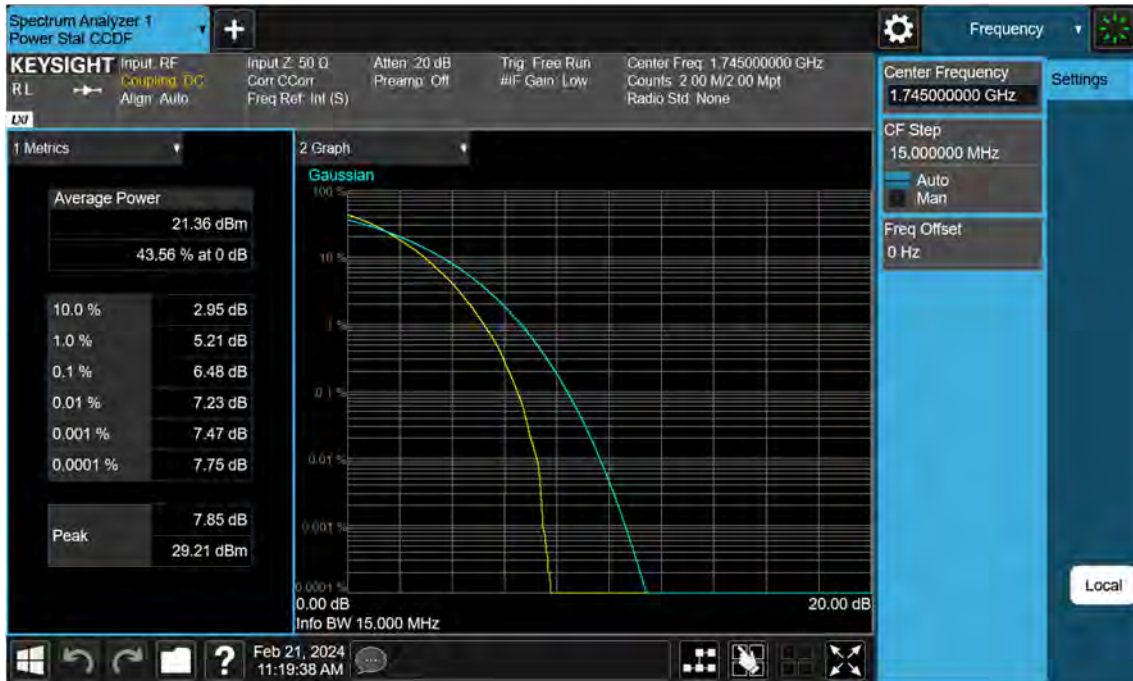
Sub6 n66. PAR Plot (15 M BW_Ch.349000_64QAM_Full RB)
