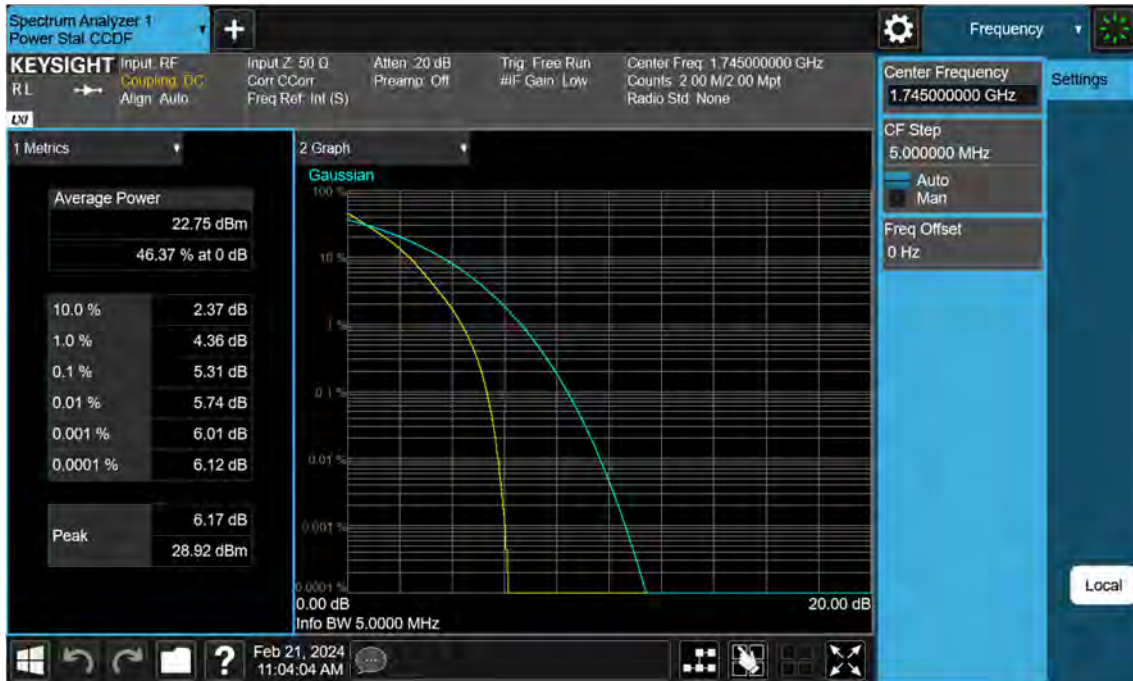
Sub6 n66. PAR Plot (5 M BW_Ch.349000_QPSK_Full RB)
