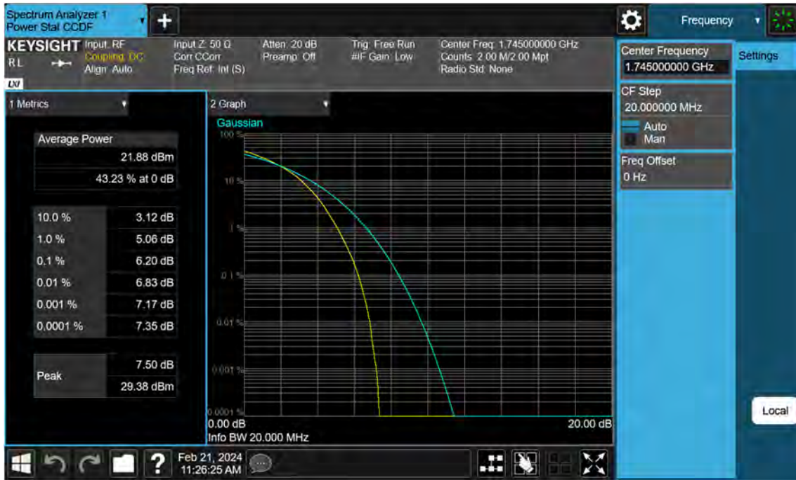
Sub6 n66. PAR Plot (20 M BW_Ch.349000_16QAM_Full RB)
