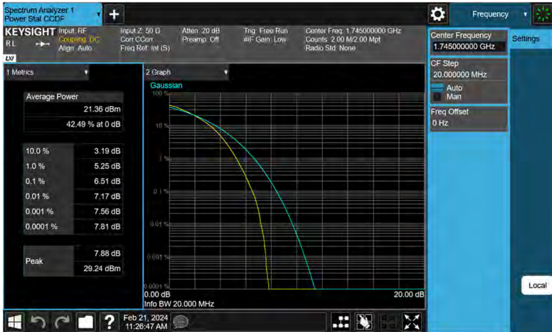
Sub6 n66. PAR Plot (20 M BW_Ch.349000_64QAM_Full RB)
