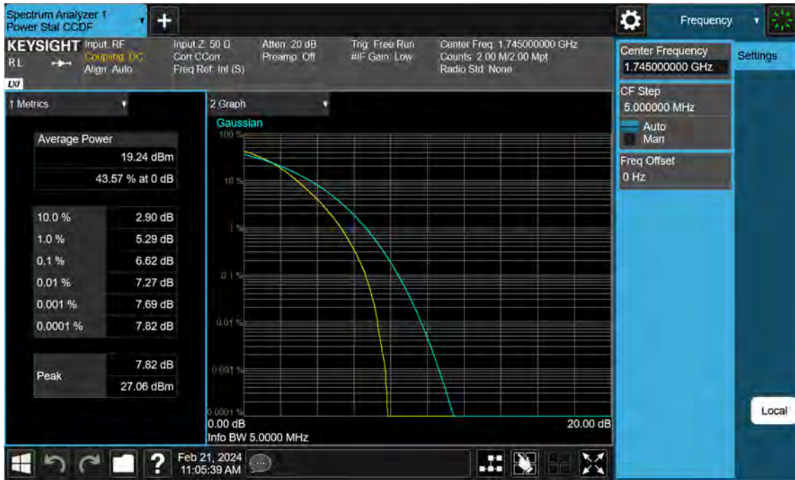
Sub6 n66. PAR Plot (5 M BW_Ch.349000_256QAM_Full RB)
