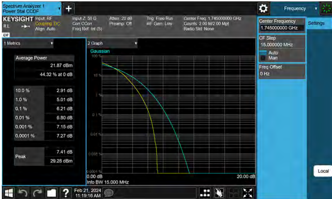
Sub6 n66. PAR Plot (15 M BW_Ch.349000_16QAM_Full RB)
