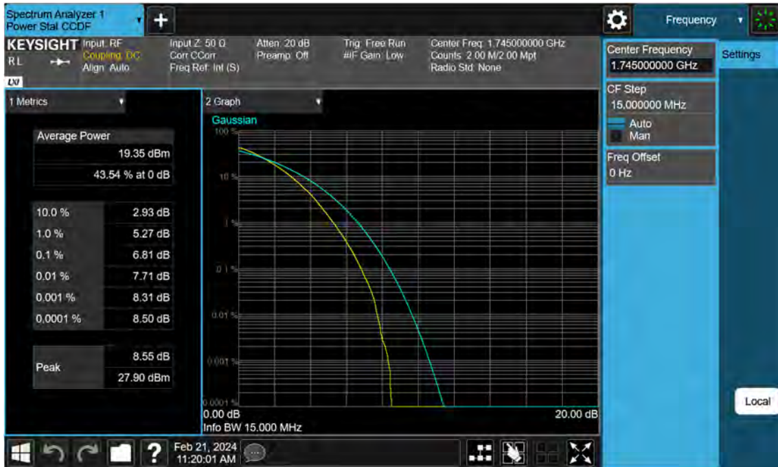
Sub6 n66. PAR Plot (15 M BW_Ch.349000_256QAM_Full RB)
