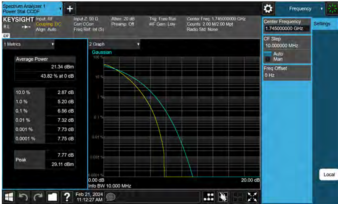
Sub6 n66. PAR Plot (10 M BW_Ch.349000_64QAM_Full RB)
