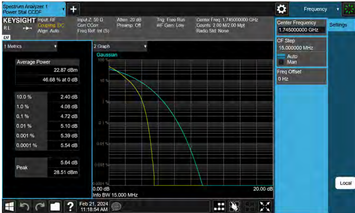
Sub6 n66. PAR Plot (15 M BW_Ch.349000_QPSK_Full RB)
