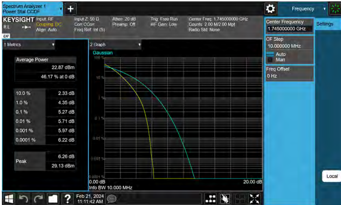
Sub6 n66. PAR Plot (10 M BW_Ch.349000_QPSK_Full RB)
