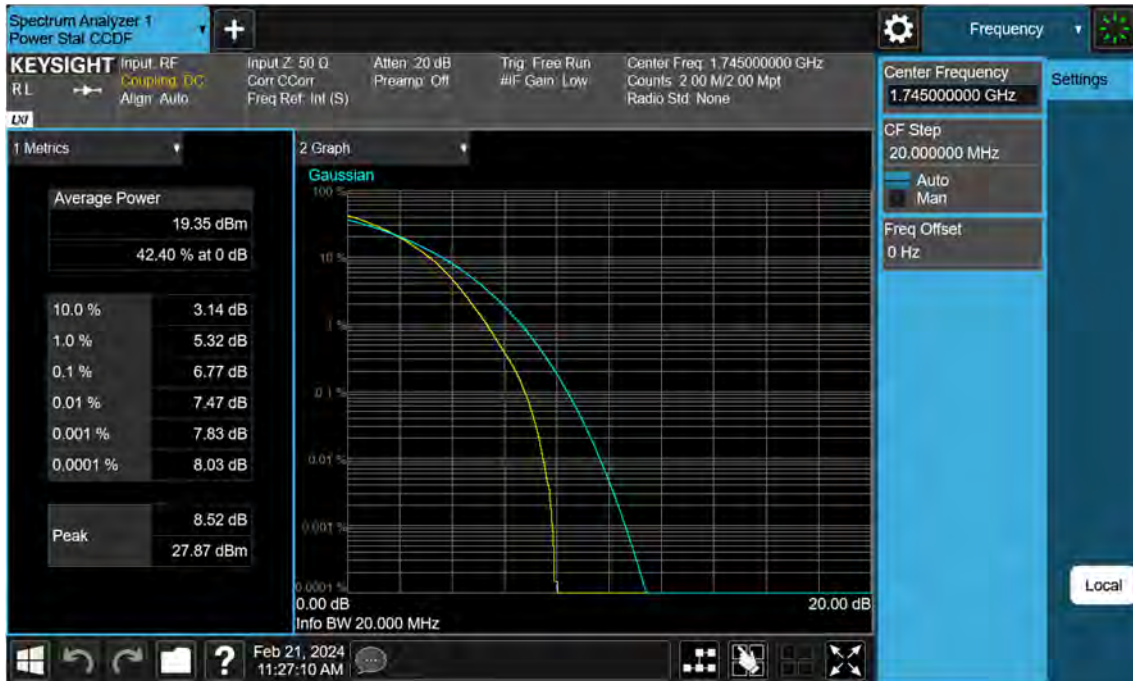
Sub6 n66. PAR Plot (20 M BW_Ch.349000_256QAM_Full RB)
