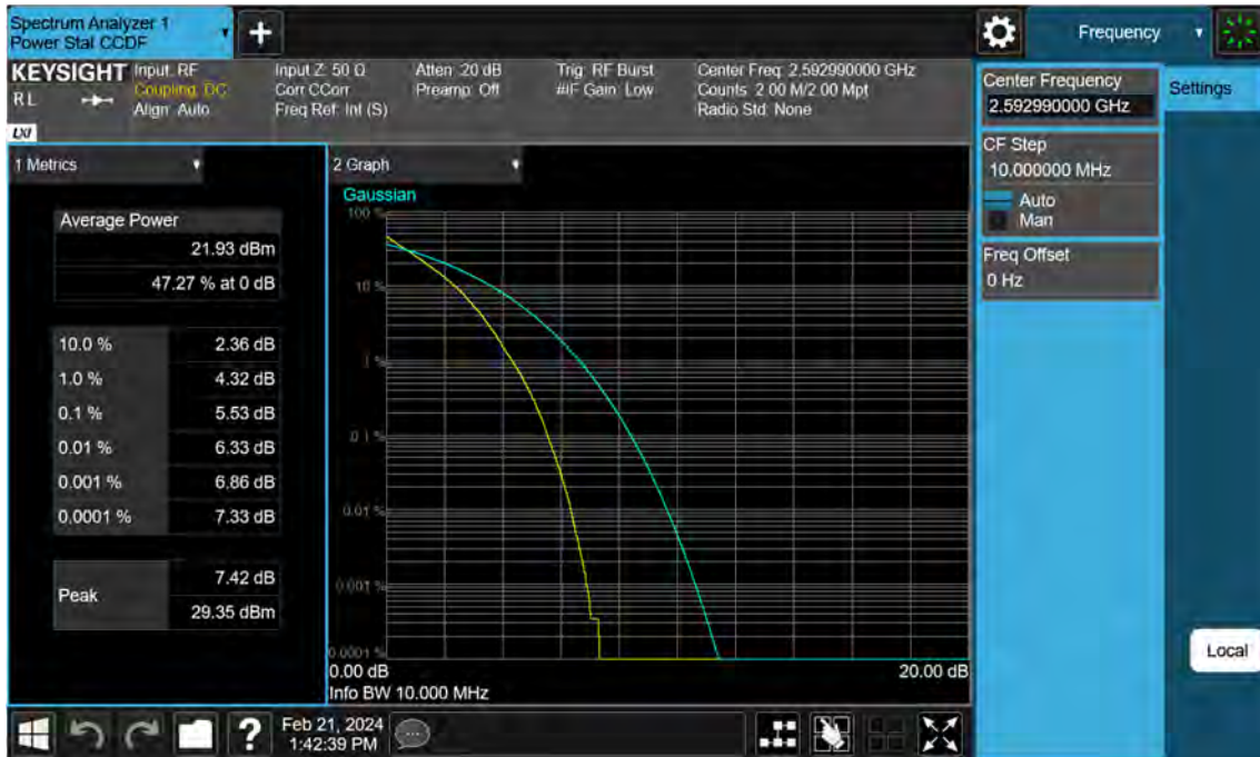
Sub6 n41. PAR Plot (10 M BW_Ch.518598_QPSK)
