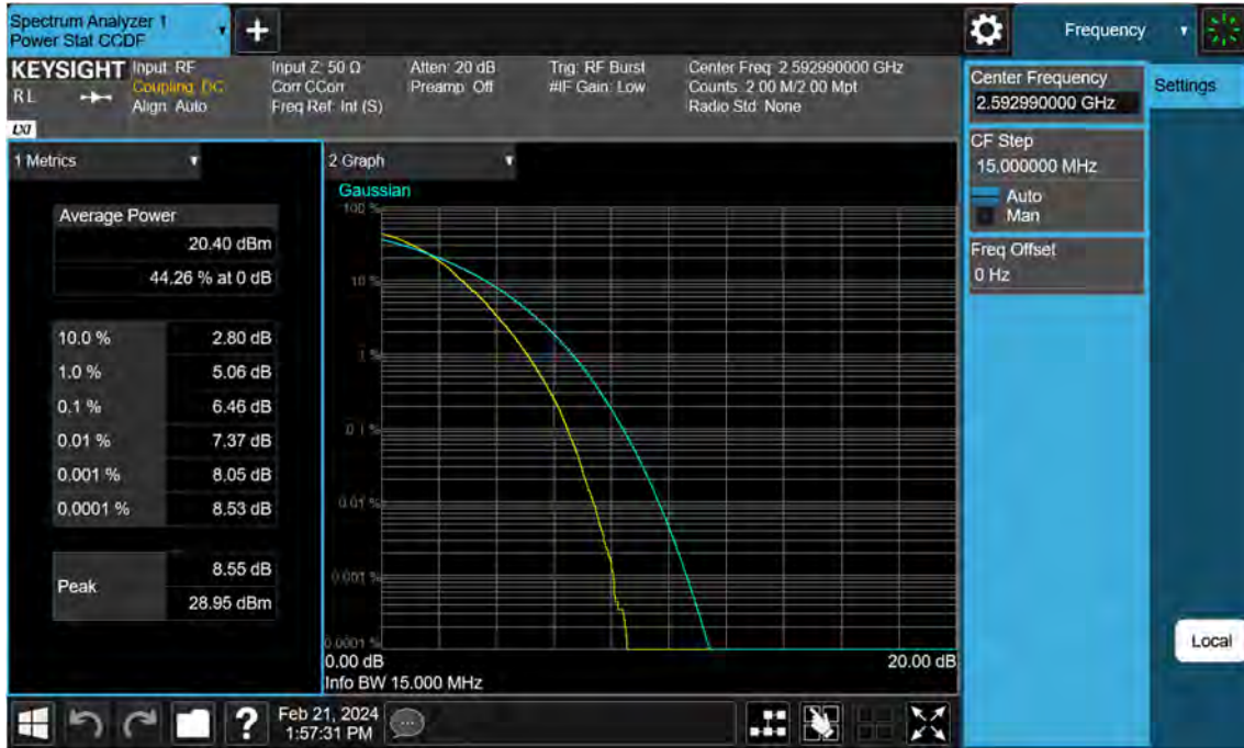
Sub6 n41. PAR Plot (15 M BW_Ch.518598_64QAM)
