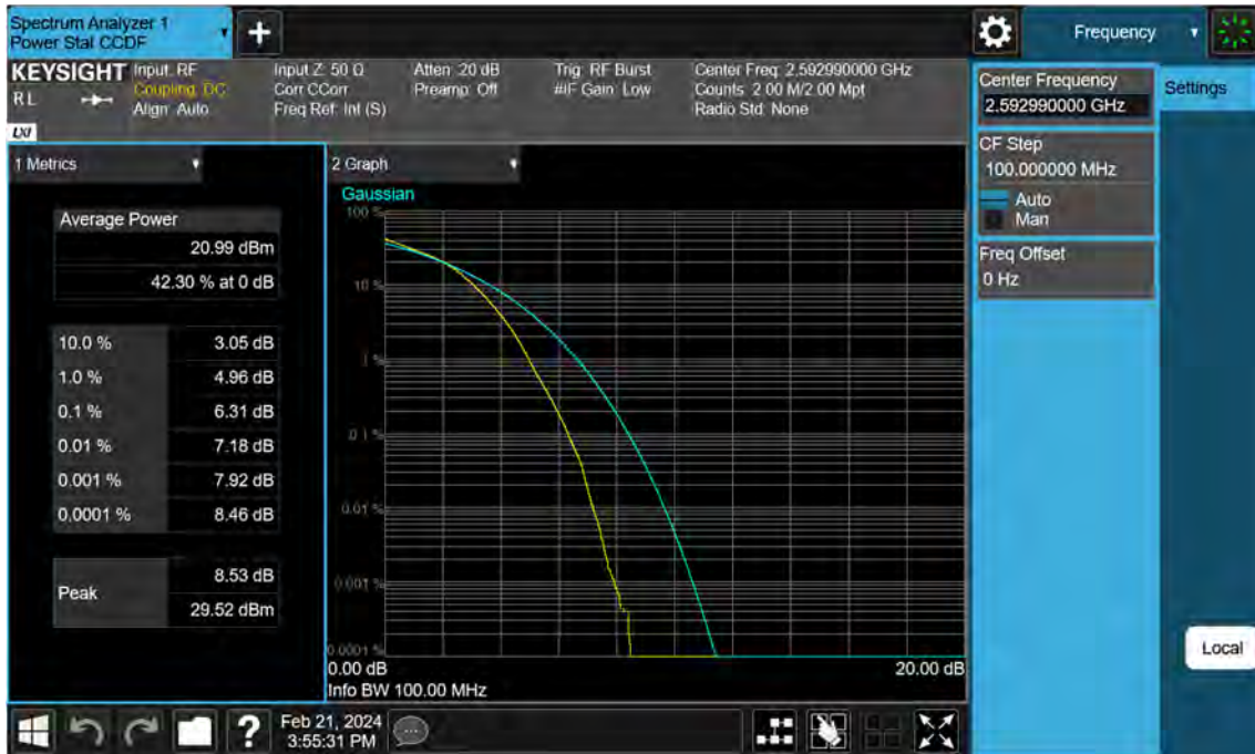
Sub6 n41. PAR Plot (100 M BW_Ch.518598_16QAM)
