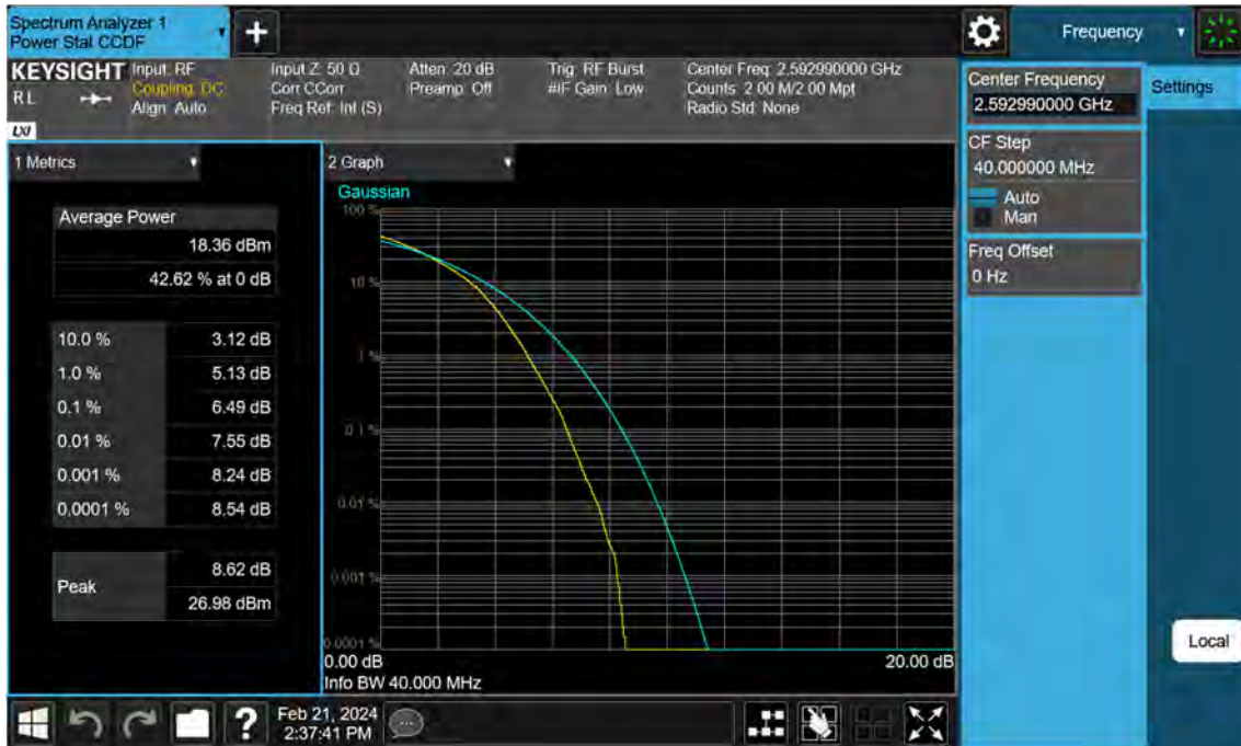
Sub6 n41. PAR Plot (40 M BW_Ch.518598_256QAM)
