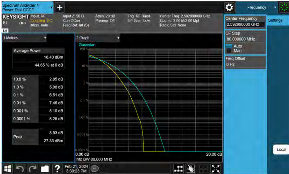
Sub6 n41. PAR Plot (80 M BW_Ch.518598_256QAM)
