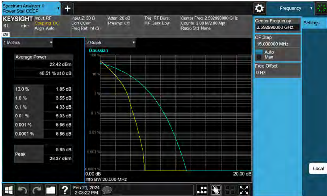
Sub6 n41. PAR Plot (20 M BW_Ch.518598_BPSK)
