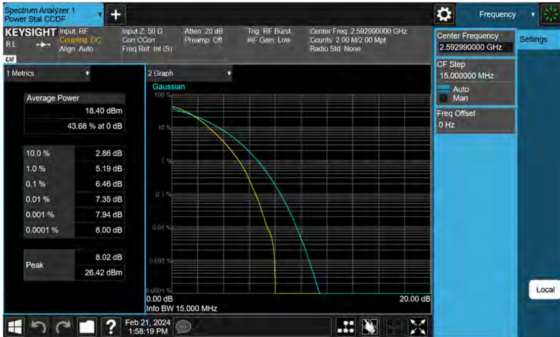
Sub6 n41. PAR Plot (15 M BW_Ch.518598_256QAM)
