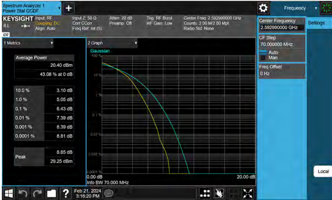
Sub6 n41. PAR Plot (70 M BW_Ch.518598_64QAM)
