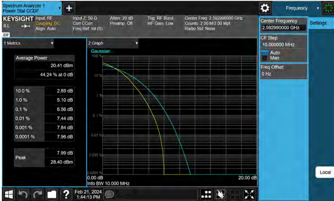
Sub6 n41. PAR Plot (10 M BW_Ch.518598_64QAM)
