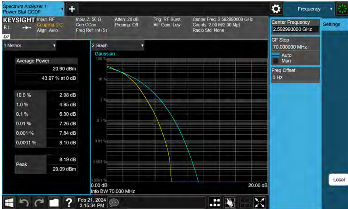
Sub6 n41. PAR Plot (70 M BW_Ch.518598_16QAM)
