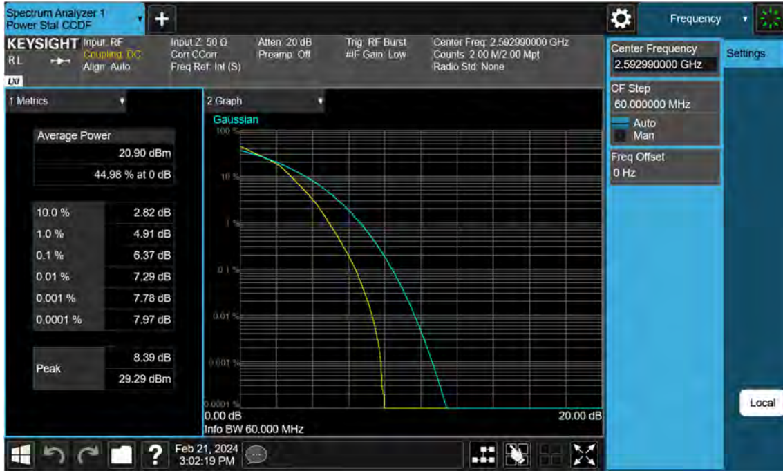
Sub6 n41. PAR Plot (60 M BW_Ch.518598_16QAM)
