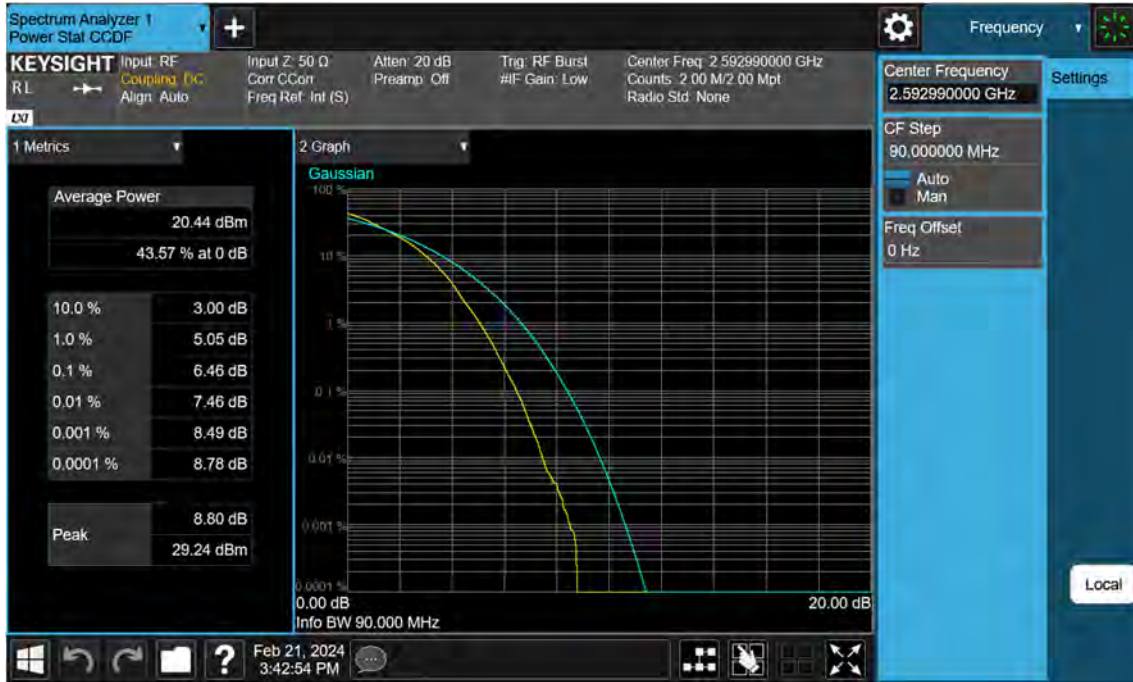
Sub6 n41. PAR Plot (90 M BW_Ch.518598_64QAM)
