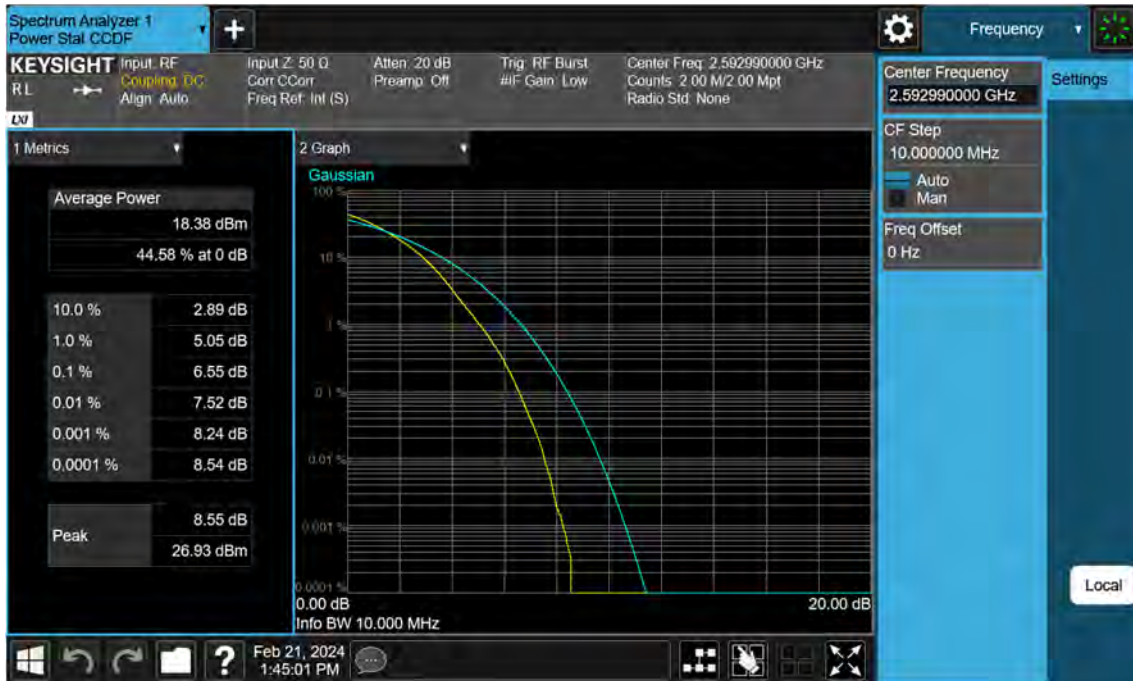
Sub6 n41. PAR Plot (10 M BW_Ch.518598_256QAM)
