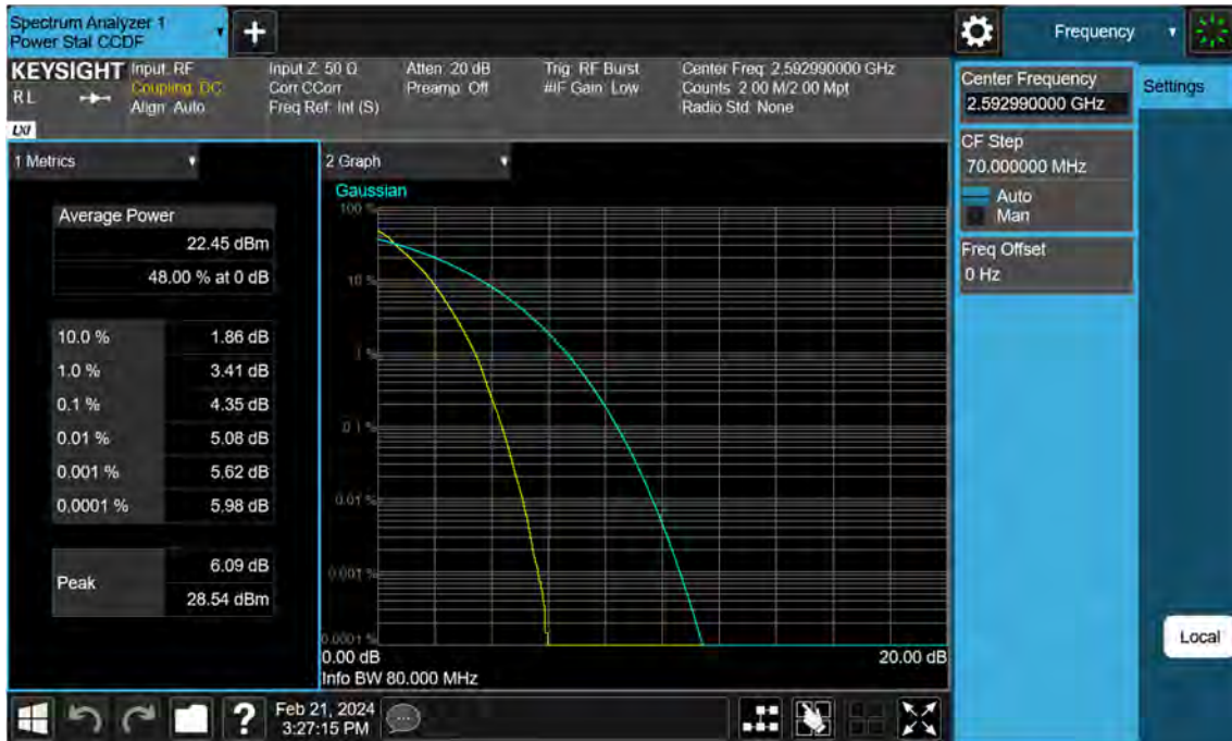
Sub6 n41. PAR Plot (80 M BW_Ch.518598_BPSK)
