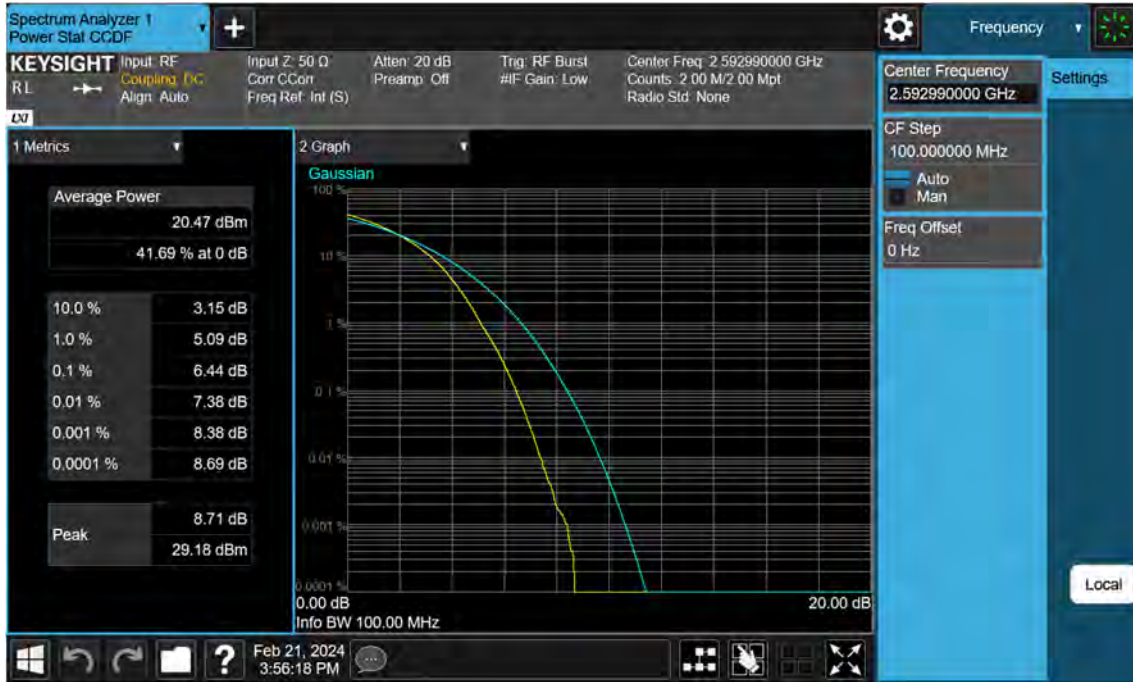
Sub6 n41. PAR Plot (100 M BW_Ch.518598_64QAM)
