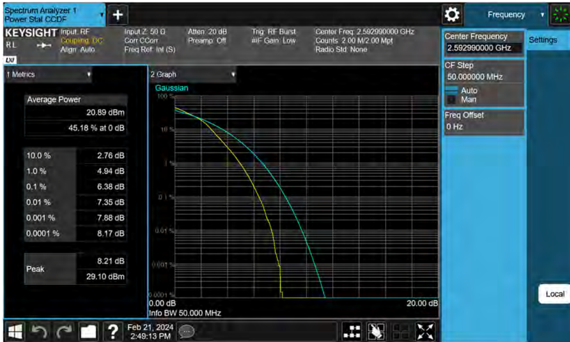
Sub6 n41. PAR Plot (50 M BW_Ch.518598_16QAM)
