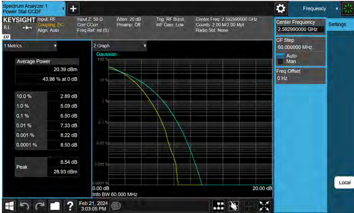
Sub6 n41. PAR Plot (60 M BW_Ch.518598_64QAM)
