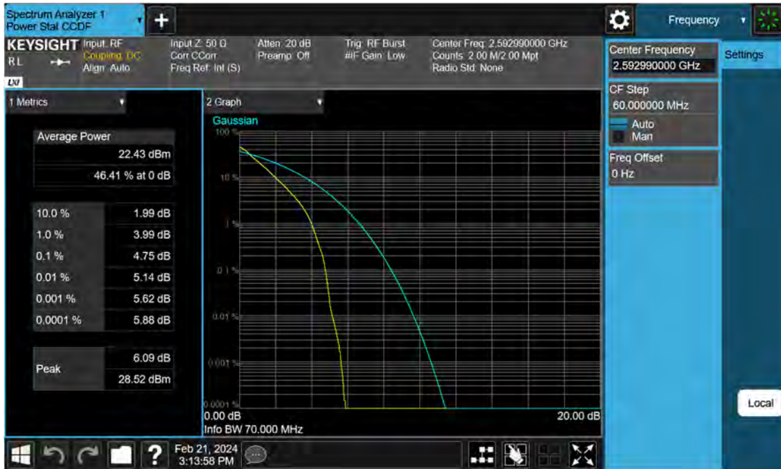
Sub6 n41. PAR Plot (70 M BW_Ch.518598_BPSK)
