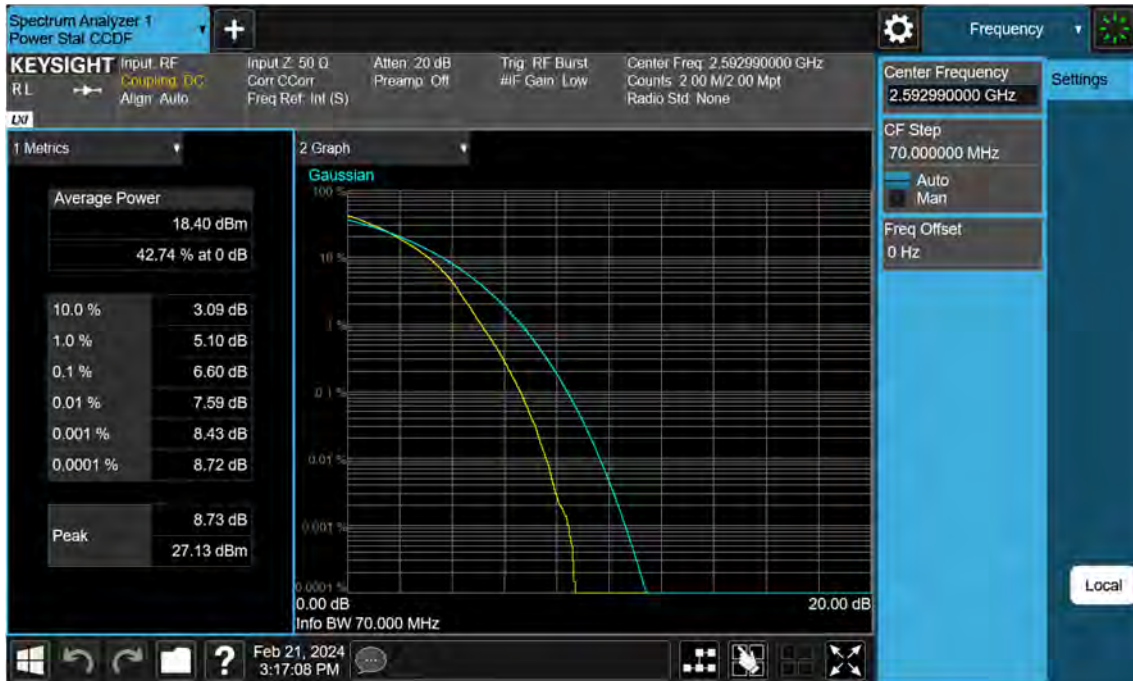
Sub6 n41. PAR Plot (70 M BW_Ch.518598_256QAM)
