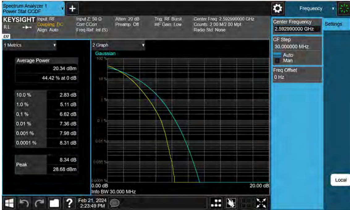
Sub6 n41. PAR Plot (30 M BW_Ch.518598_64QAM)
