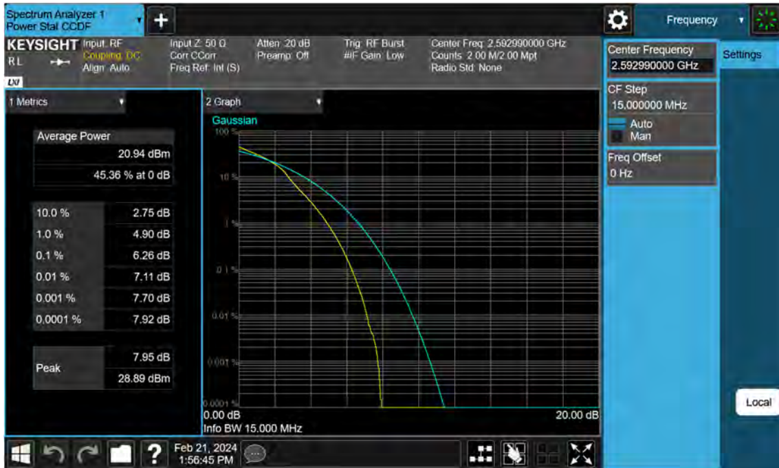
Sub6 n41. PAR Plot (15 M BW_Ch.518598_16QAM)
