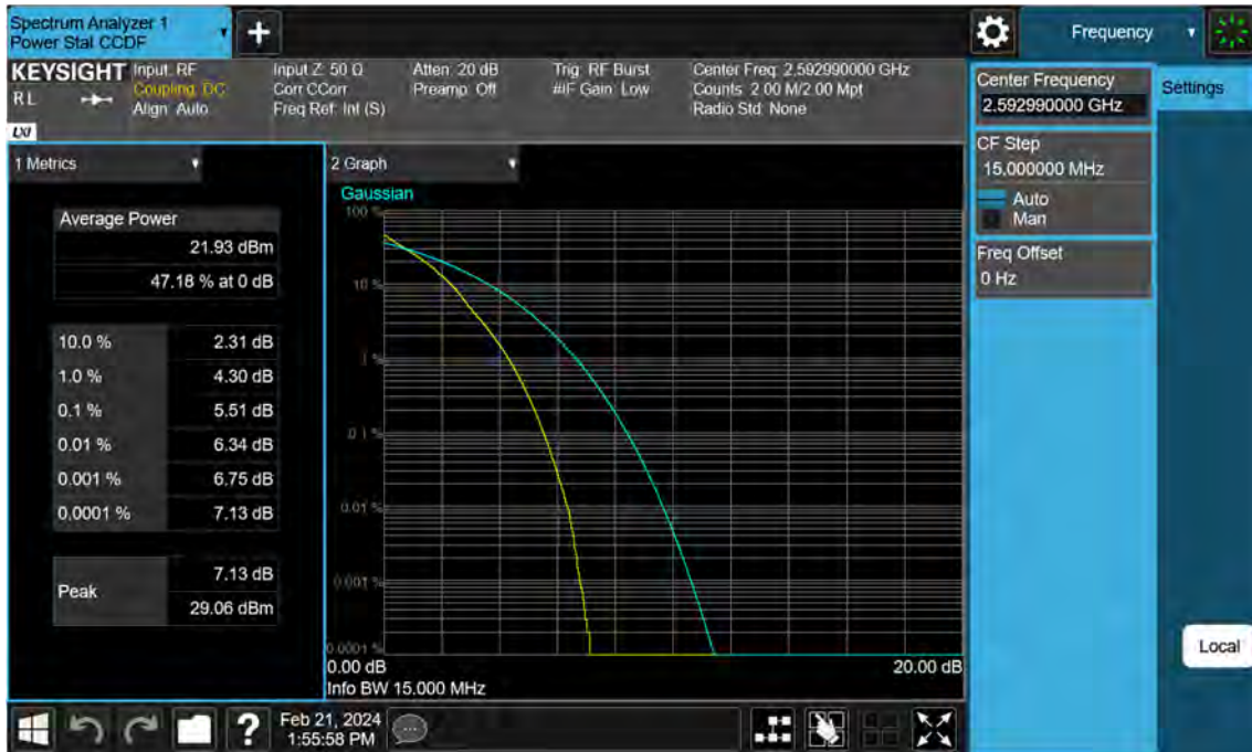
Sub6 n41. PAR Plot (15 M BW_Ch.518598_QPSK)
