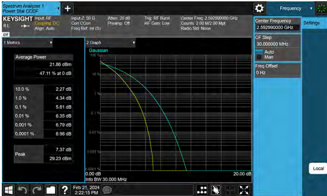
Sub6 n41. PAR Plot (30 M BW_Ch.518598_QPSK)
