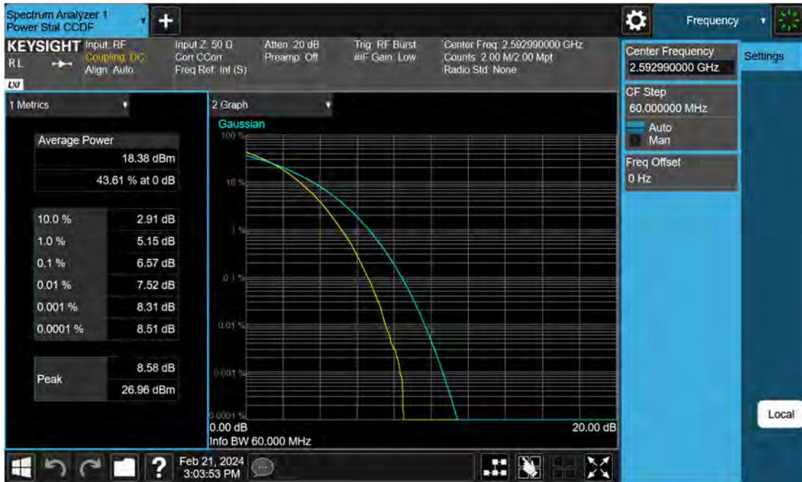
Sub6 n41. PAR Plot (60 M BW_Ch.518598_256QAM)
