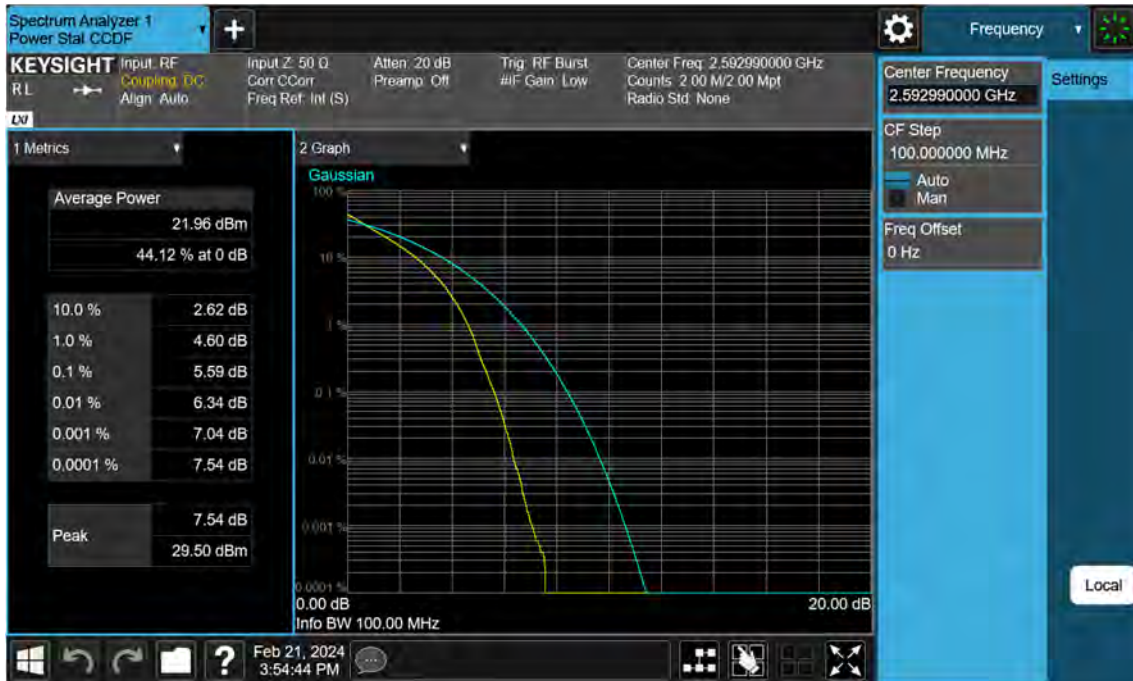
Sub6 n41. PAR Plot (100 M BW_Ch.518598_QPSK)
