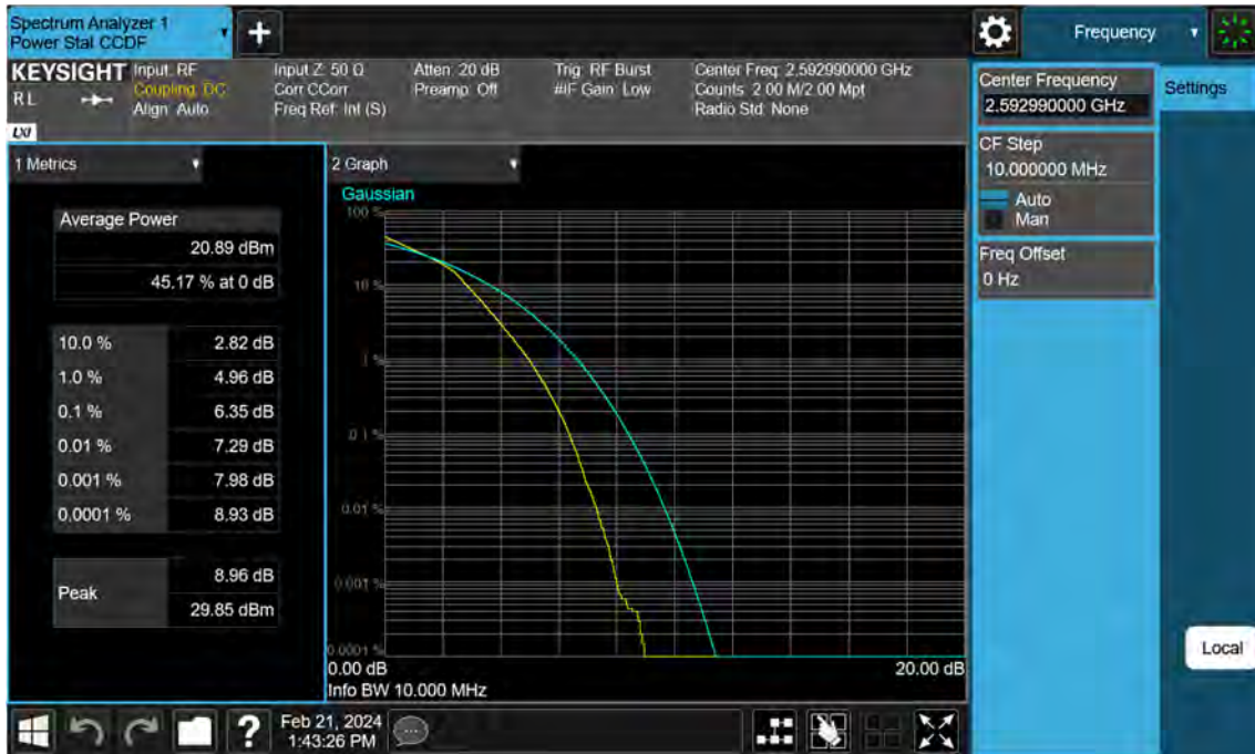
Sub6 n41. PAR Plot (10 M BW_Ch.518598_16QAM)
