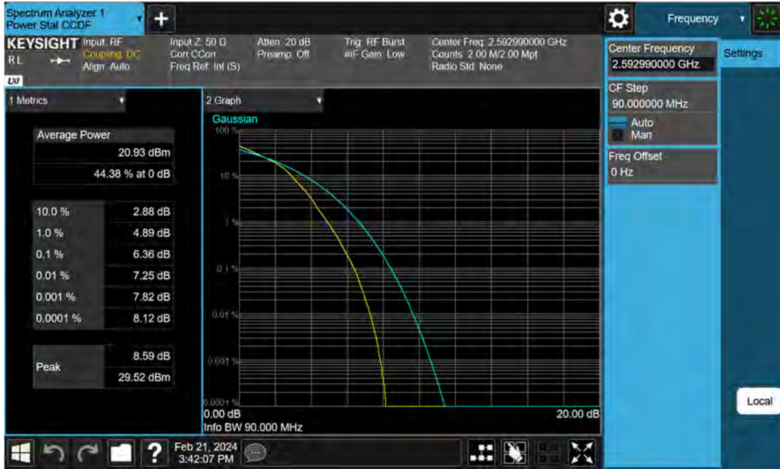
Sub6 n41. PAR Plot (90 M BW_Ch.518598_16QAM)
