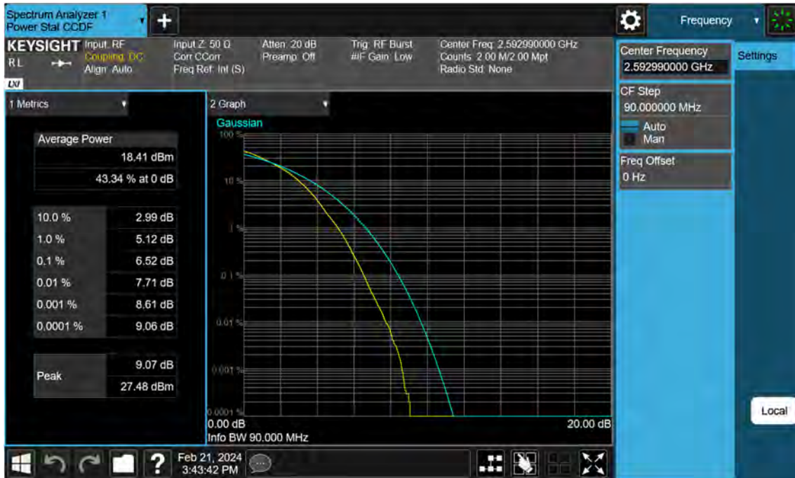
Sub6 n41. PAR Plot (90 M BW_Ch.518598_256QAM)
