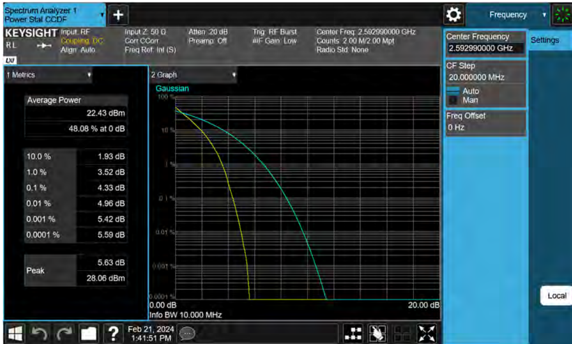
Sub6 n41. PAR Plot (10 M BW_Ch.518598_BPSK)
