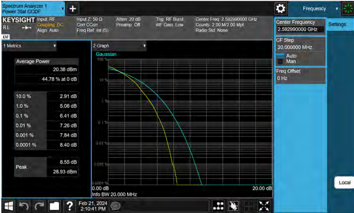
Sub6 n41. PAR Plot (20 M BW_Ch.518598_64QAM)
