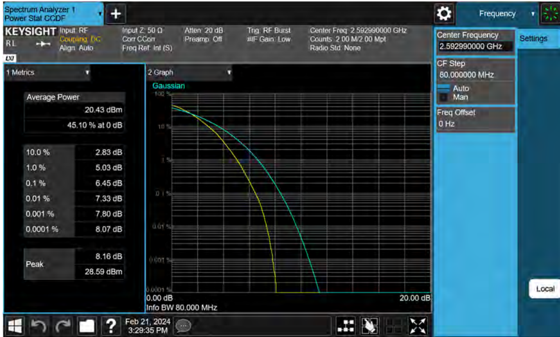
Sub6 n41. PAR Plot (80 M BW_Ch.518598_64QAM)
