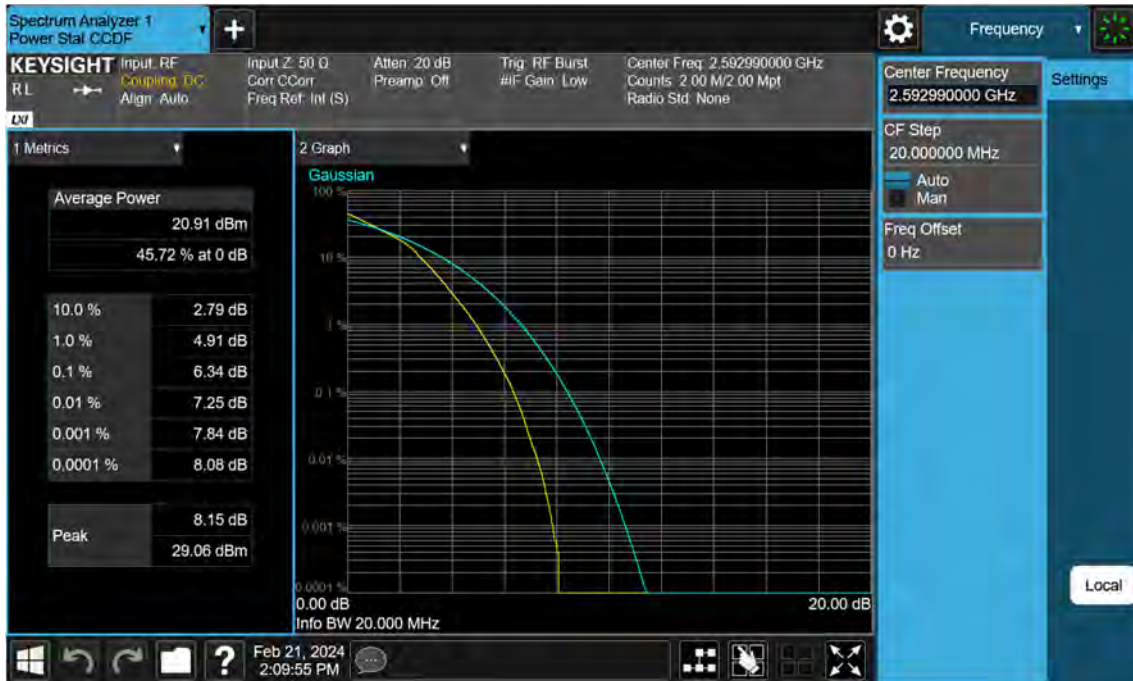
Sub6 n41. PAR Plot (20 M BW_Ch.518598_16QAM)
