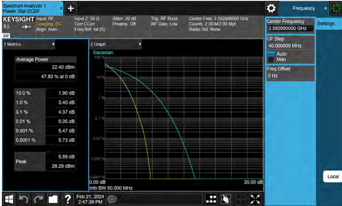
Sub6 n41. PAR Plot (50 M BW_Ch.518598_BPSK)
