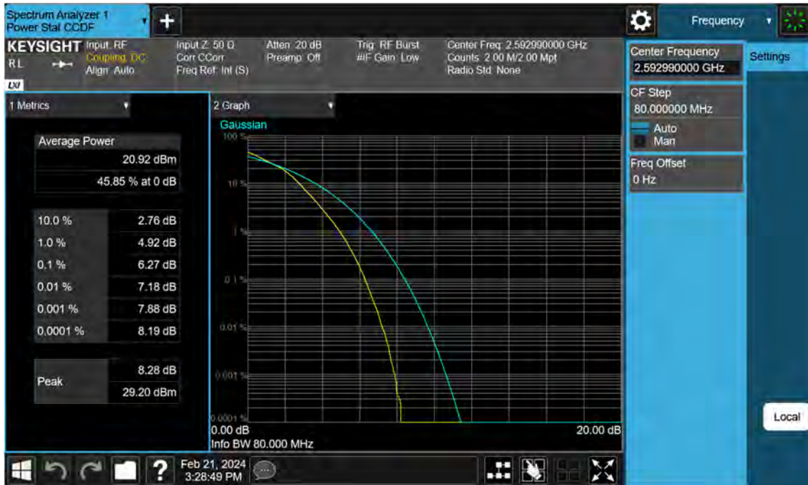
Sub6 n41. PAR Plot (80 M BW_Ch.518598_16QAM)
