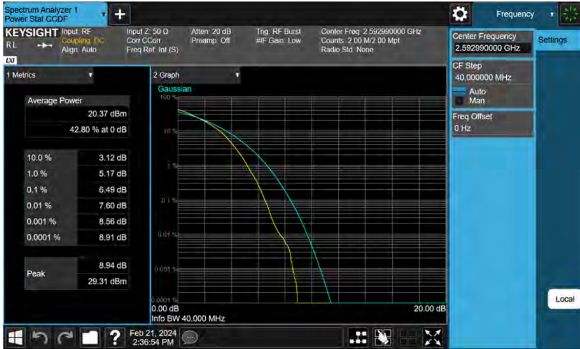
Sub6 n41. PAR Plot (40 M BW_Ch.518598_64QAM)
