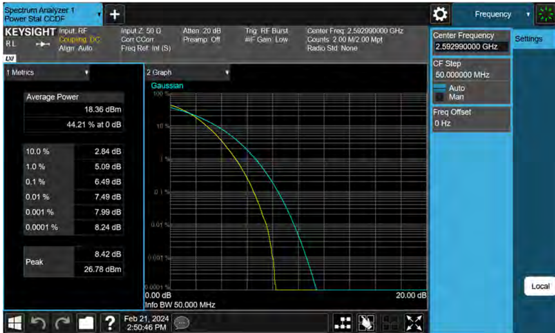
Sub6 n41. PAR Plot (50 M BW_Ch.518598_256QAM)
