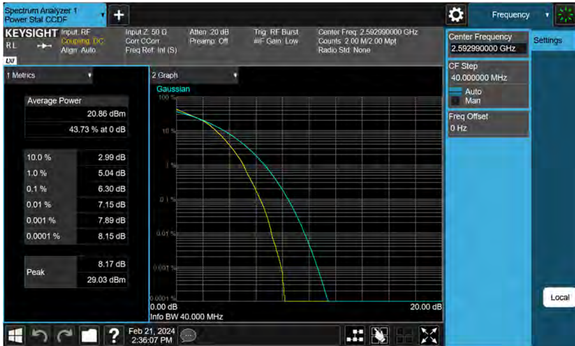
Sub6 n41. PAR Plot (40 M BW_Ch.518598_16QAM)
