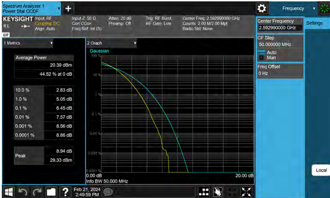
Sub6 n41. PAR Plot (50 M BW_Ch.518598_64QAM)
