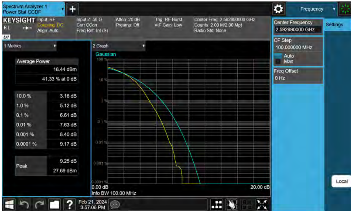
Sub6 n41. PAR Plot (100 M BW_Ch.518598_256QAM)
