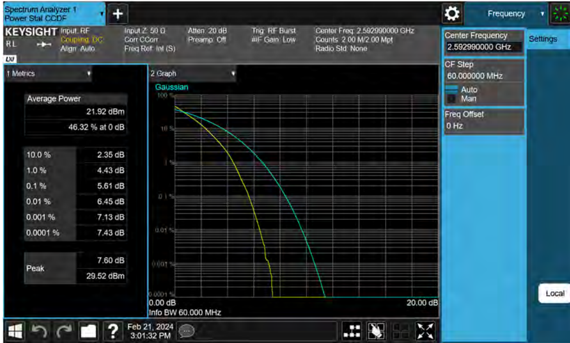
Sub6 n41. PAR Plot (60 M BW_Ch.518598_QPSK)
