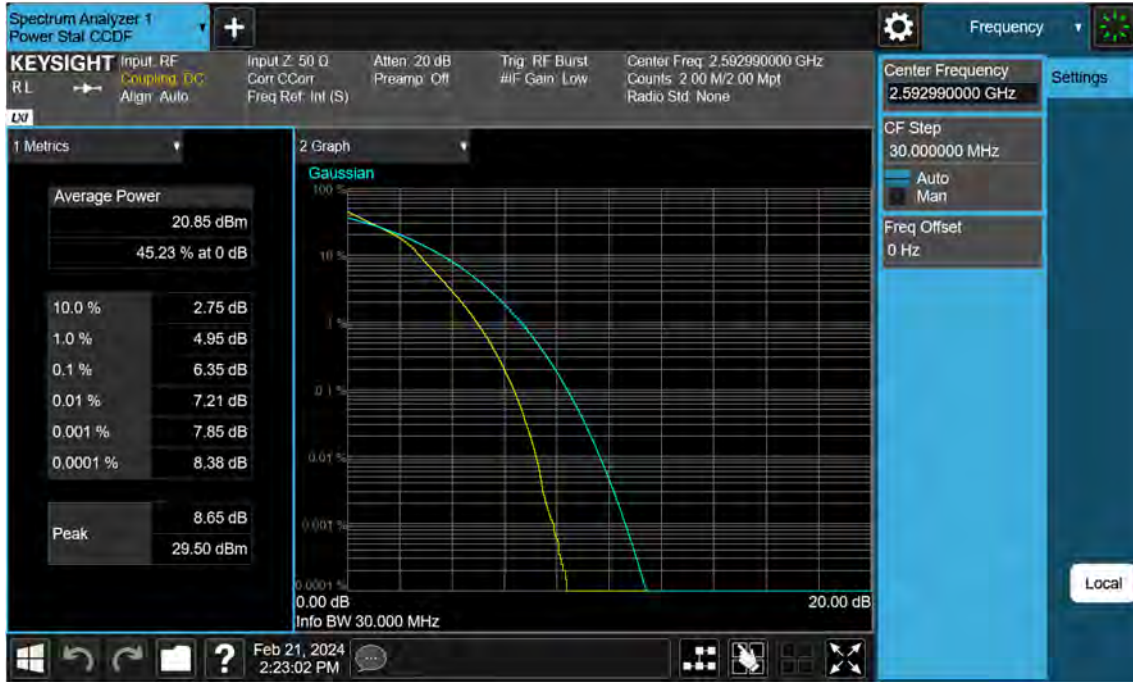
Sub6 n41. PAR Plot (30 M BW_Ch.518598_16QAM)
