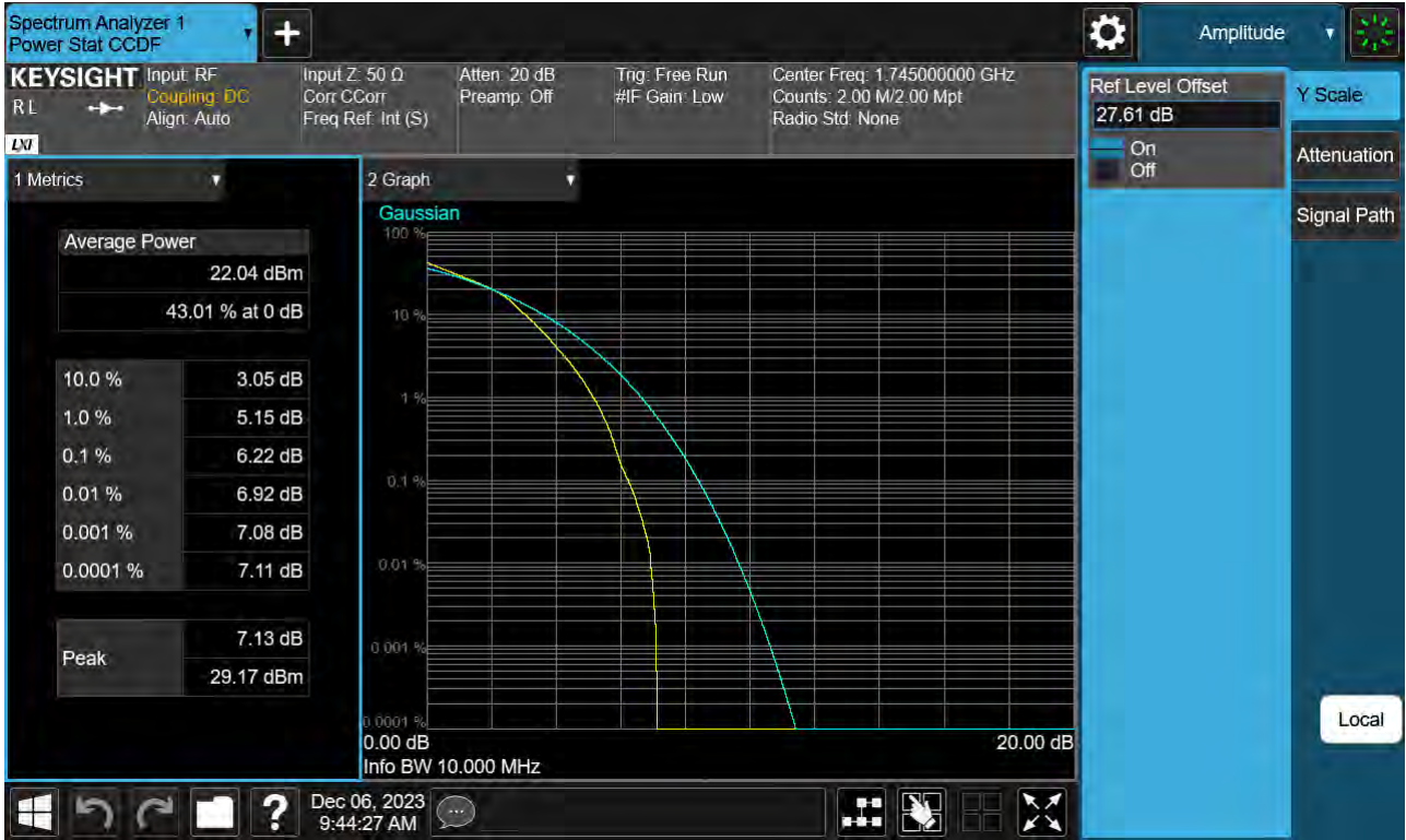
Sub6 n66. PAR Plot (10 M BW_Ch.349000_16QAM_Full RB)
