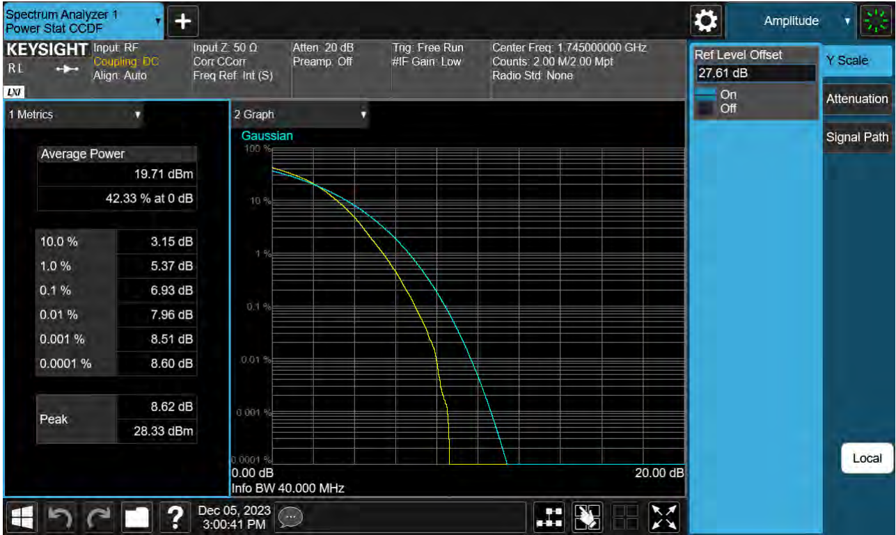
Sub6 n66. PAR Plot (40 M BW_Ch.349000_256QAM_Full RB)
