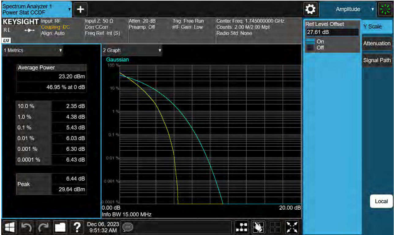
Sub6 n66. PAR Plot (15 M BW_Ch.349000_QPSK_Full RB)
