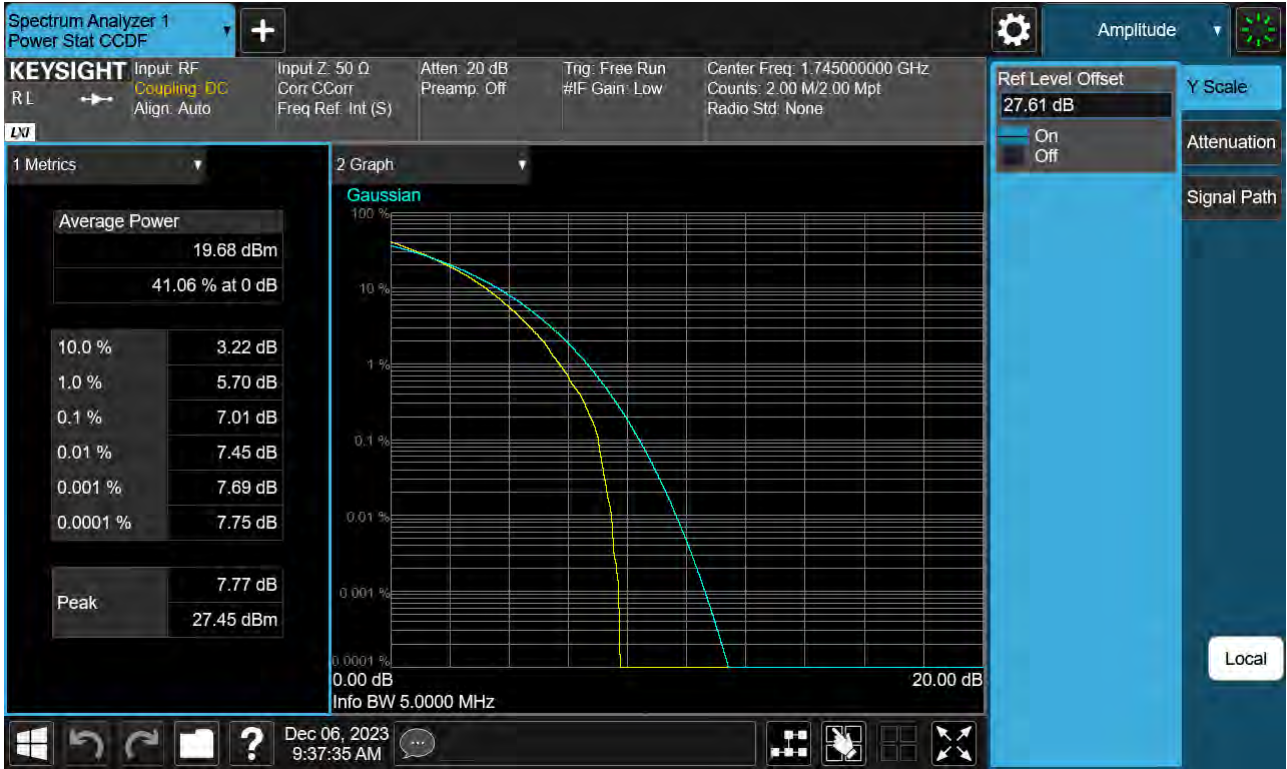
Sub6 n66. PAR Plot (5 M BW_Ch.349000_256QAM_Full RB)
