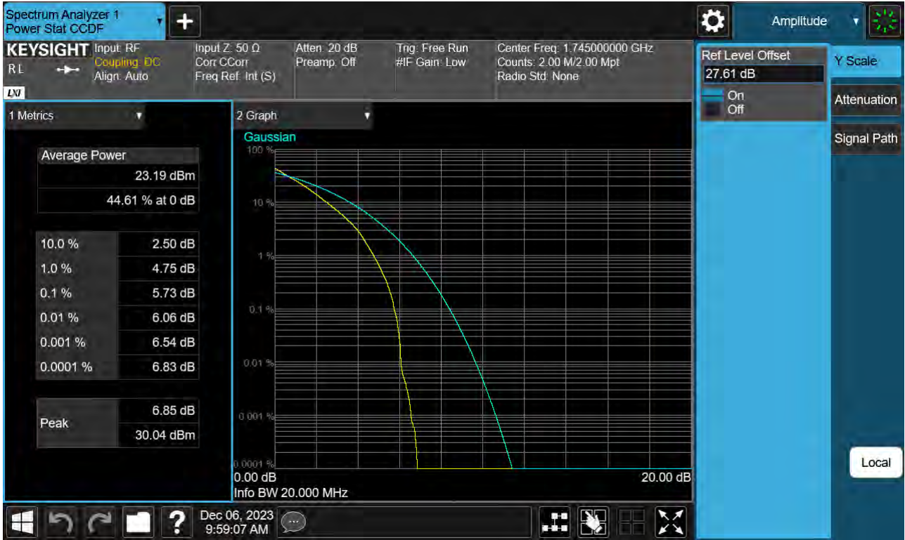
Sub6 n66. PAR Plot (20 M BW_Ch.349000_QPSK_Full RB)
