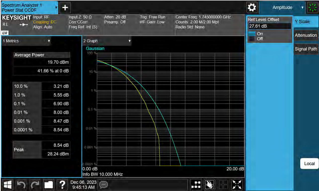
Sub6 n66. PAR Plot (10 M BW_Ch.349000_256QAM_Full RB)
