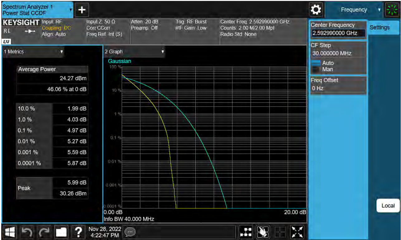
Sub6 n41. PAR Plot (40 M BW_Ch.518598_BPSK)
