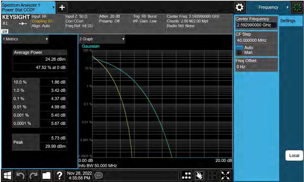
Sub6 n41. PAR Plot (50 M BW_Ch.518598_BPSK)
