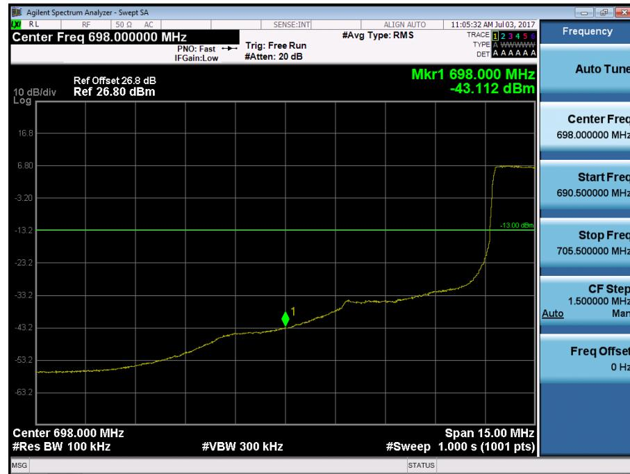
**BAND 17. Lower Extended Band Edge Plot (5M BW Ch.23755 QPSK\_RB25\_0) -3**
