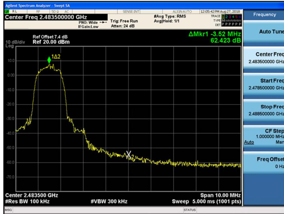
Test Plots without hopping ( $\pi/4$ DQPSK)
