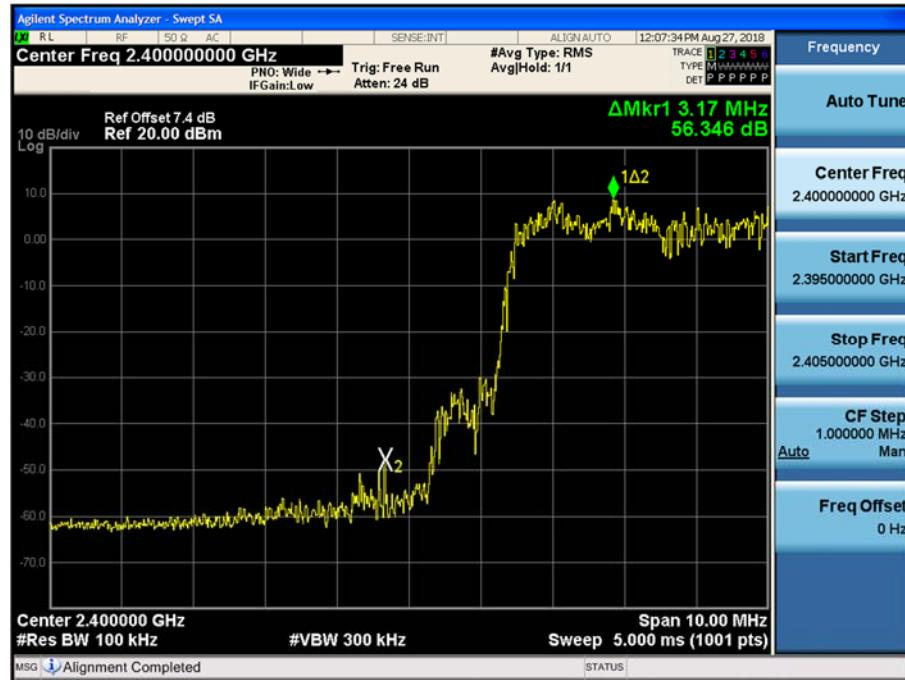
Test Plots with hopping ( $\pi/4$ DQPSK)
