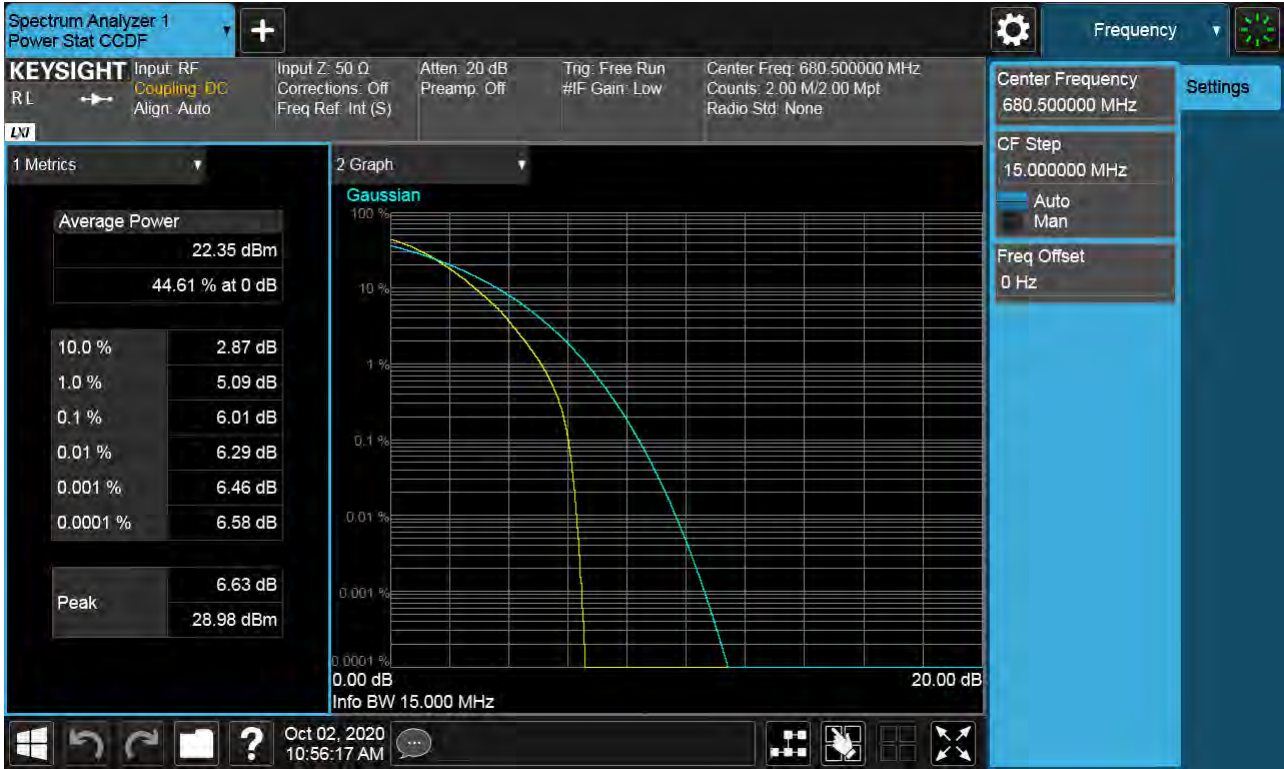
Sub6 n66. PAR Plot (15M BW_Ch.349000_64QAM_RB75_0)
