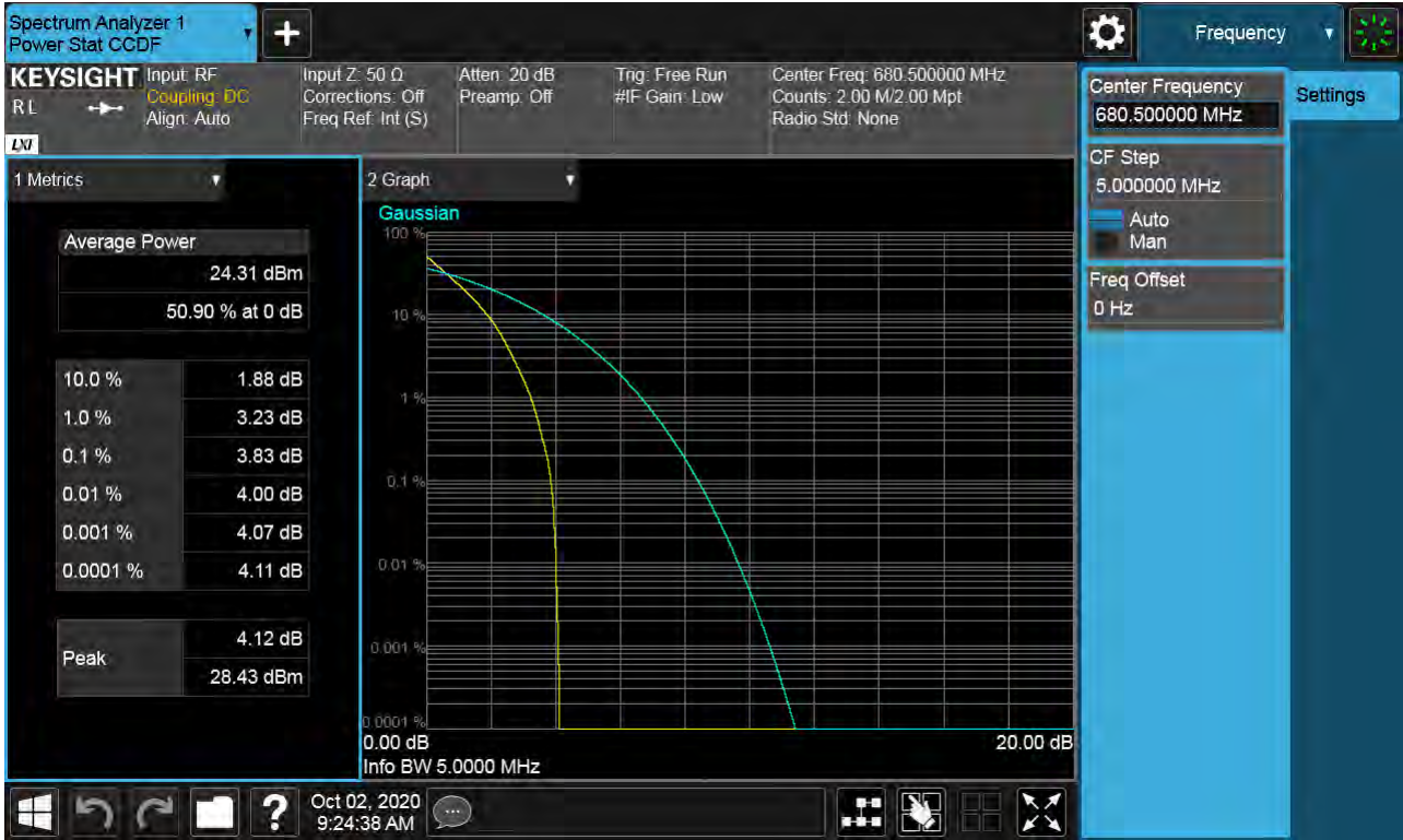
Sub6 n66. PAR Plot (5M BW_Ch.349000_ BPSK_RB25_0)
