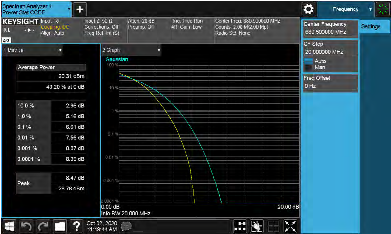
Sub6 n66. PAR Plot (20M BW_Ch.349000_256QAM_RB100_0)
