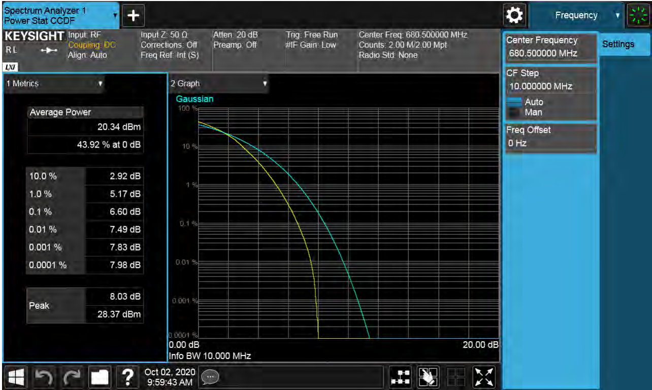
Sub6 n66. PAR Plot (10M BW_Ch.349000_256QAM_RB50_0)
