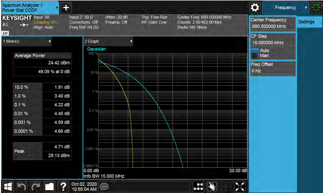
Sub6 n66. PAR Plot (15M BW_Ch.349000_ BPSK_RB75_0)
