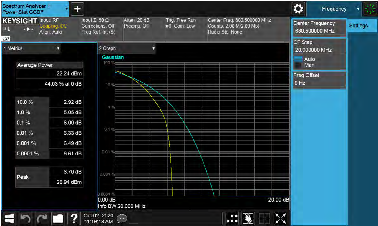
Sub6 n66. PAR Plot (20M BW_Ch.349000_64QAM_RB100_0)
