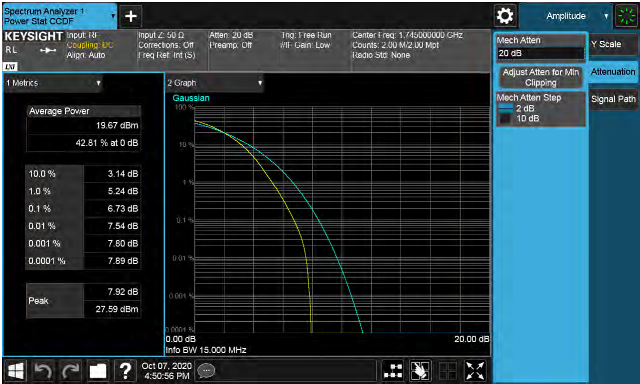
Sub6 n66. PAR Plot (15M BW_Ch.349000_256QAM_RB75_0)
