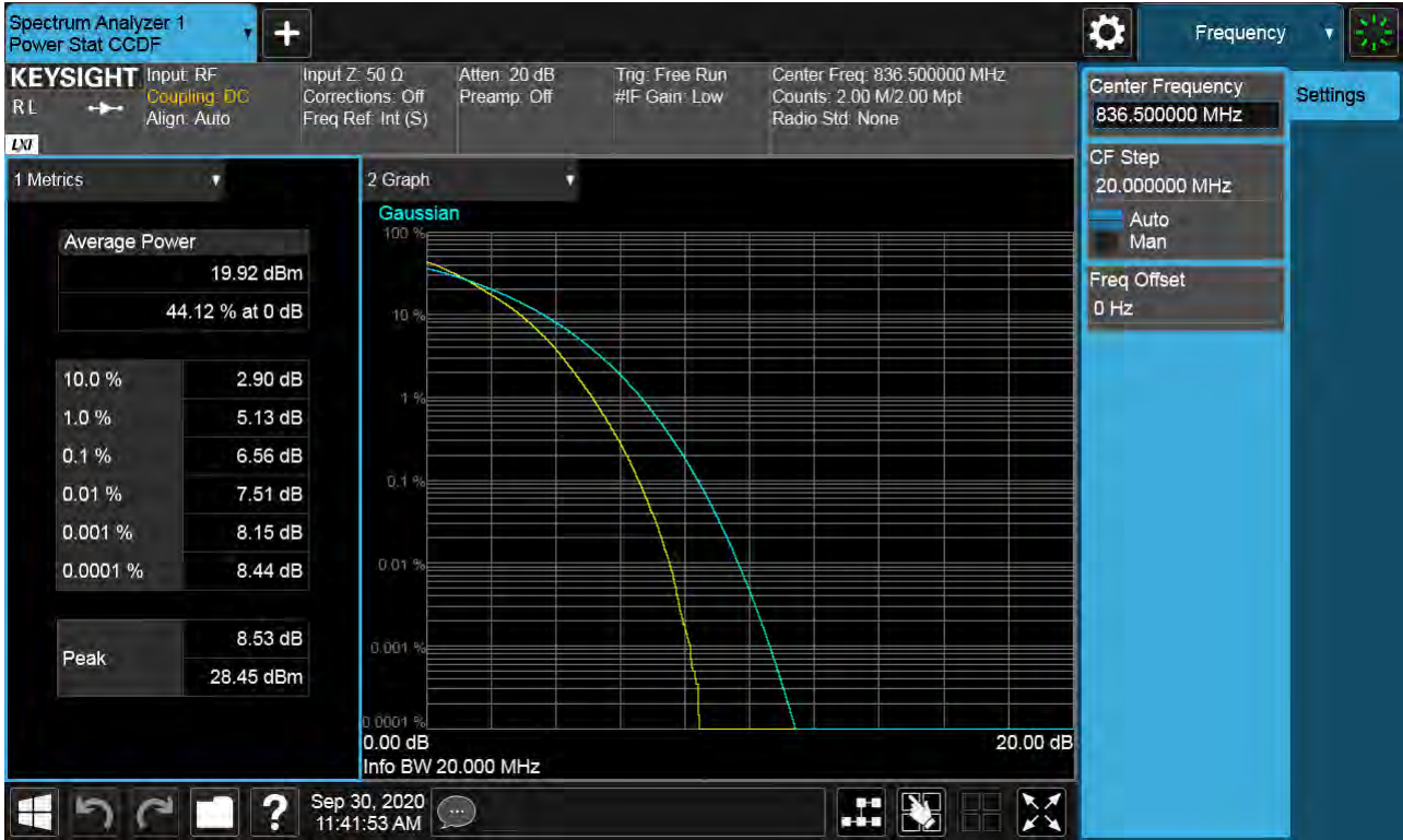
Sub6 n66. PAR Plot (20M BW_Ch.349000_256QAM_RB100_0)
