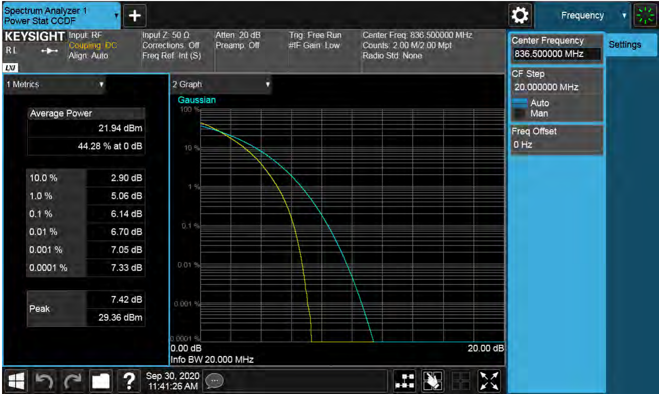
Sub6 n66. PAR Plot (20M BW_Ch.349000_64QAM_RB100_0)
