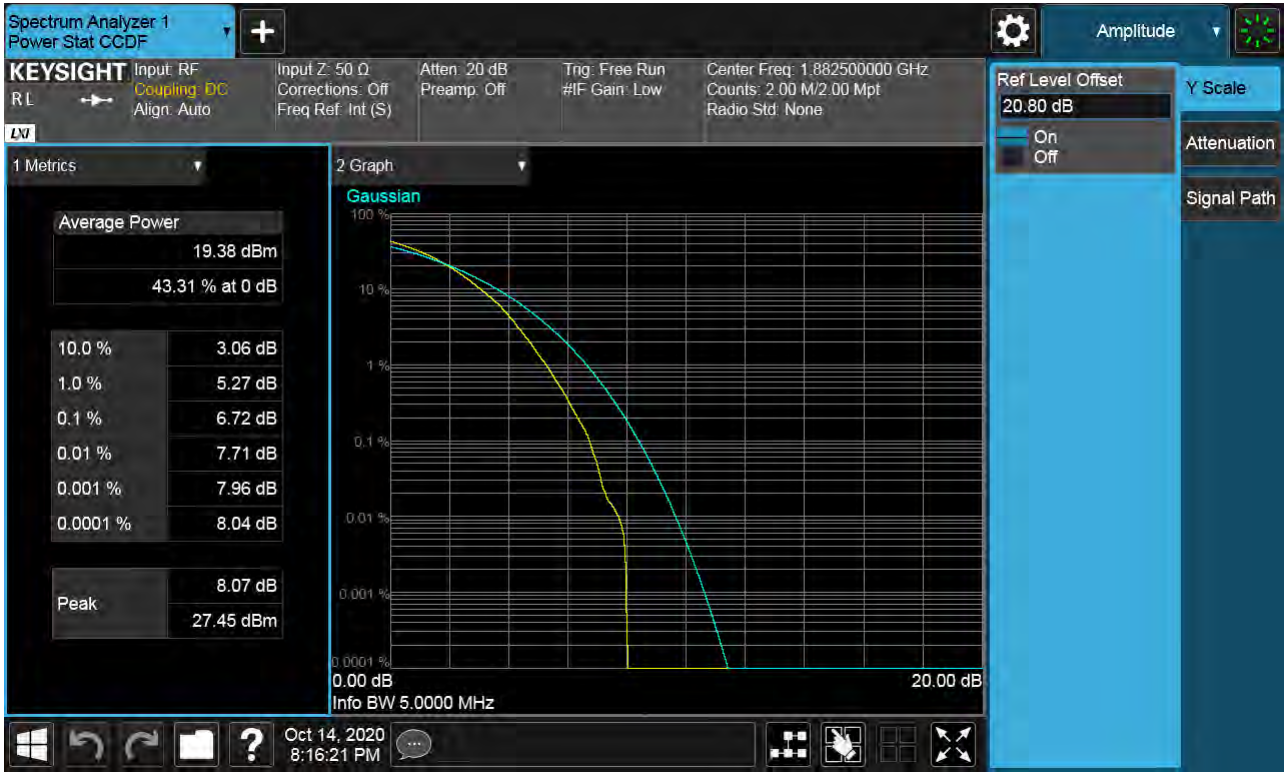
Sub6 n25(2). PAR Plot (5M BW Ch.376500 256QAM )
