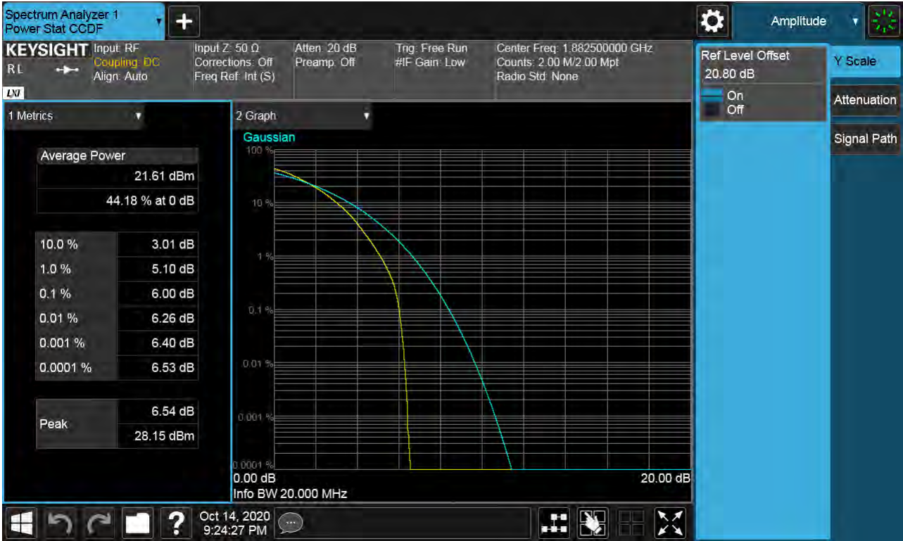
Sub6 n25(2). PAR Plot (20M BW Ch.376500 64QAM RB 100_0)
