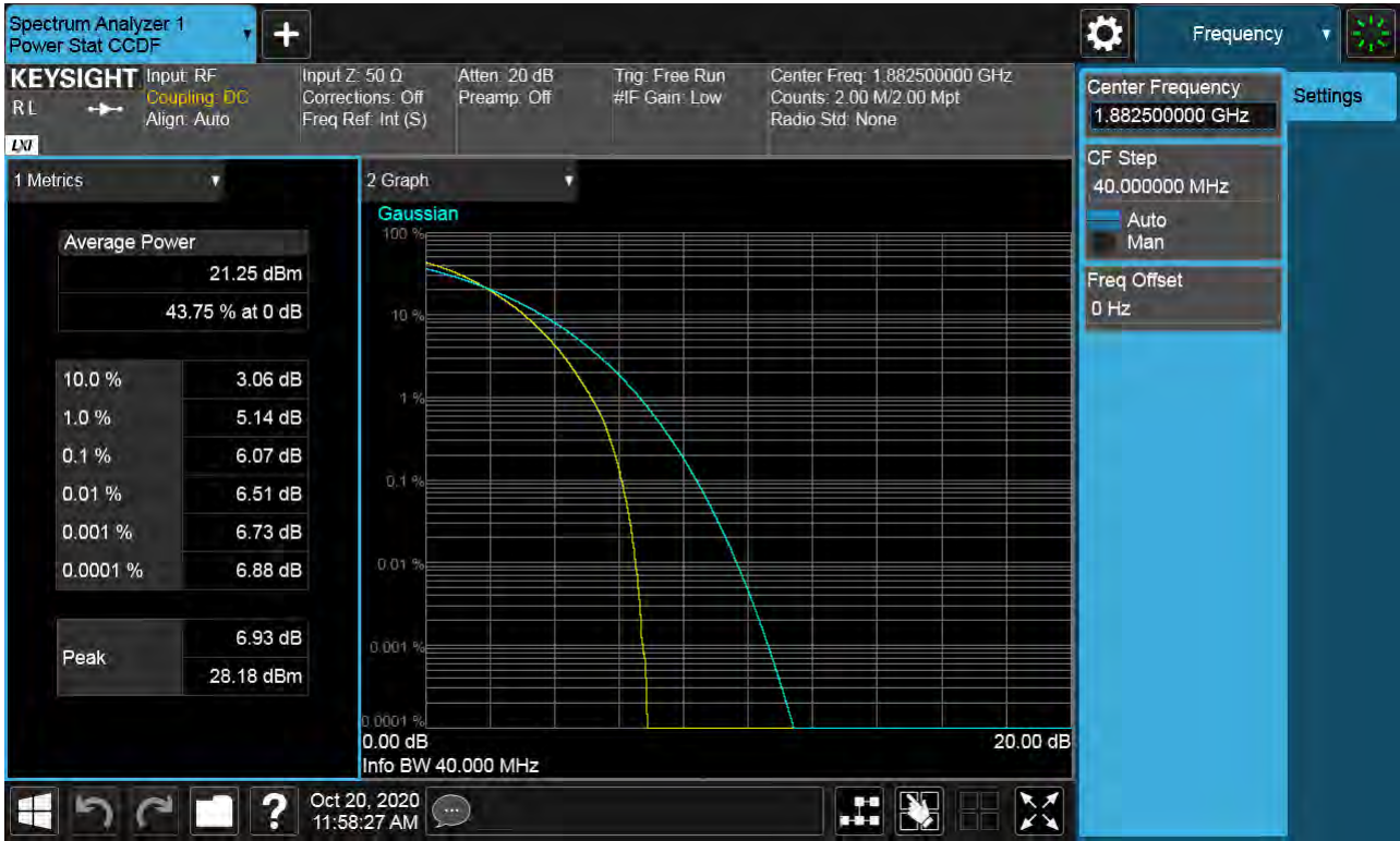
Sub6 n25(2). PAR Plot (40M BW Ch.376500 64QAM )
