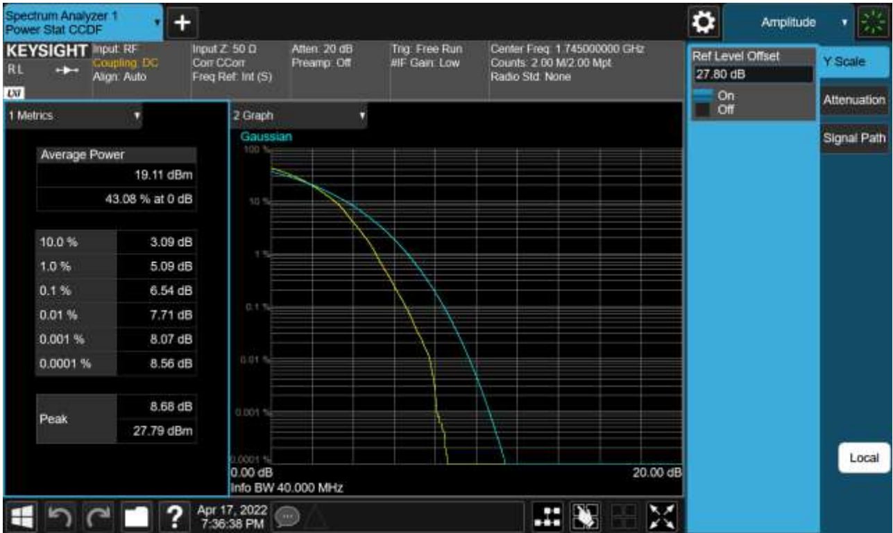
Sub6 n66. PAR Plot (40 M BW_Ch.349000_256QAM_Full RB)
