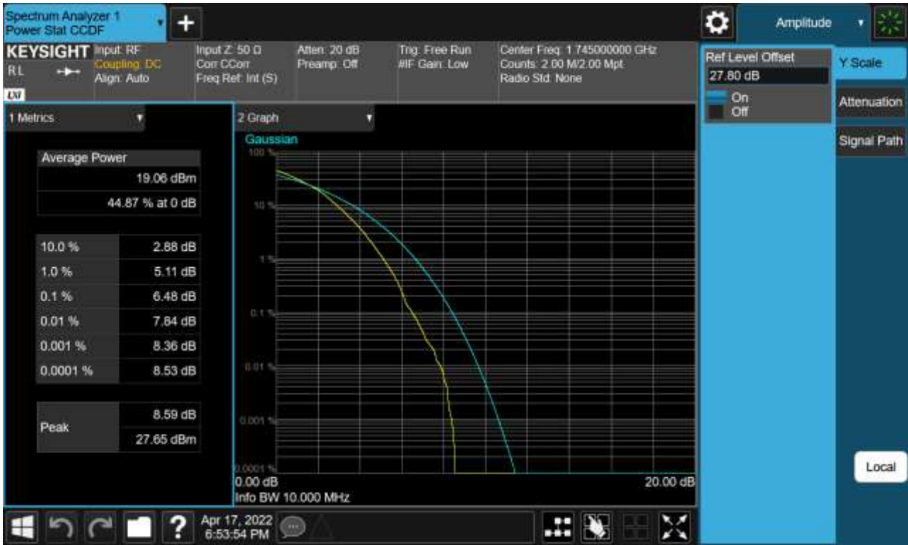
Sub6 n66. PAR Plot (10 M BW_Ch.349000_256QAM_Full RB)
