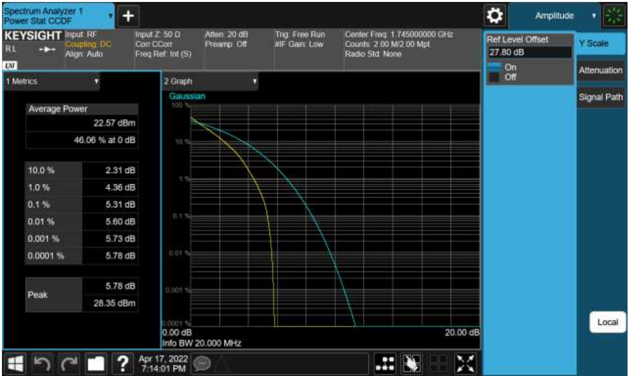
Sub6 n66. PAR Plot (20 M BW_Ch.349000_QPSK_Full RB)
