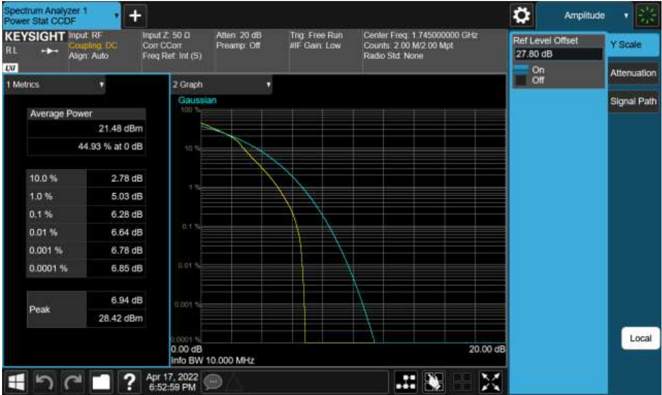
Sub6 n66. PAR Plot (10 M BW_Ch.349000_16QAM_Full RB)
