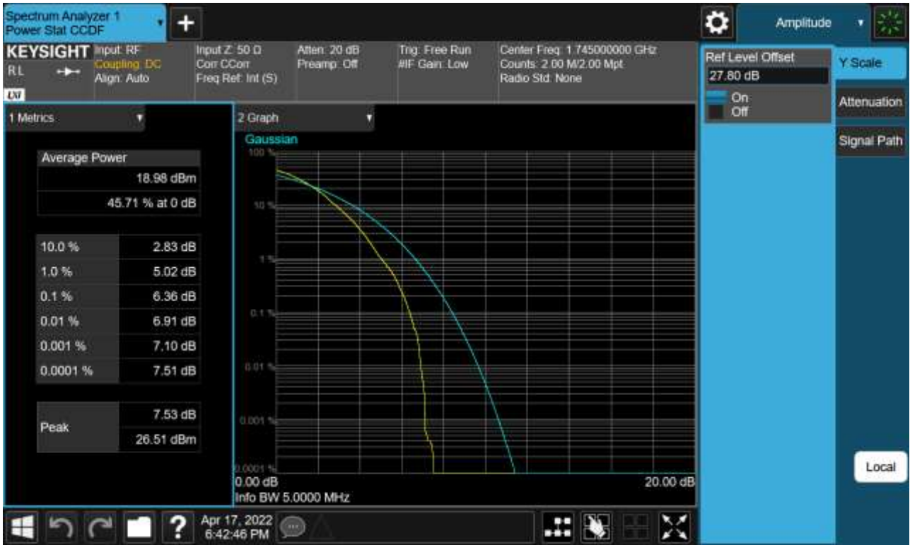
Sub6 n66. PAR Plot (5 M BW_Ch.349000_256QAM_Full RB)
