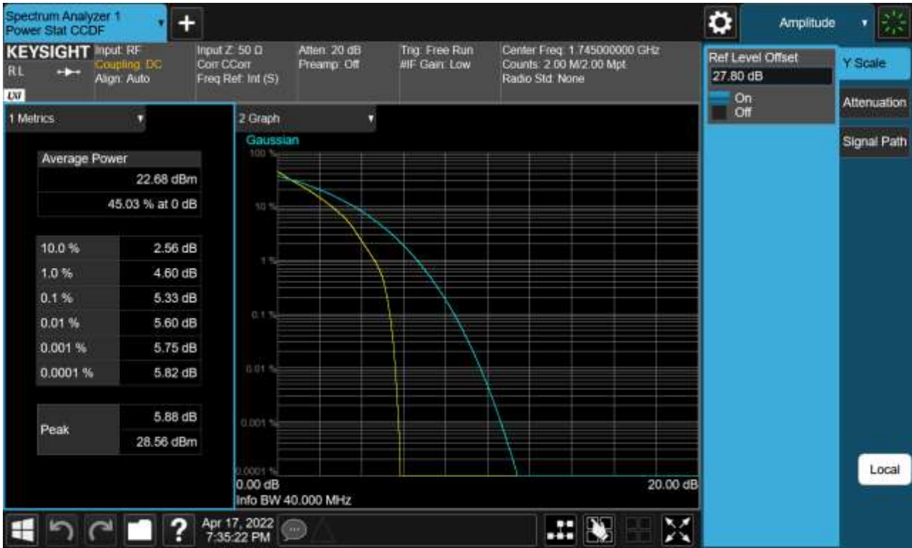
Sub6 n66. PAR Plot (40 M BW_Ch.349000_QPSK_Full RB)
