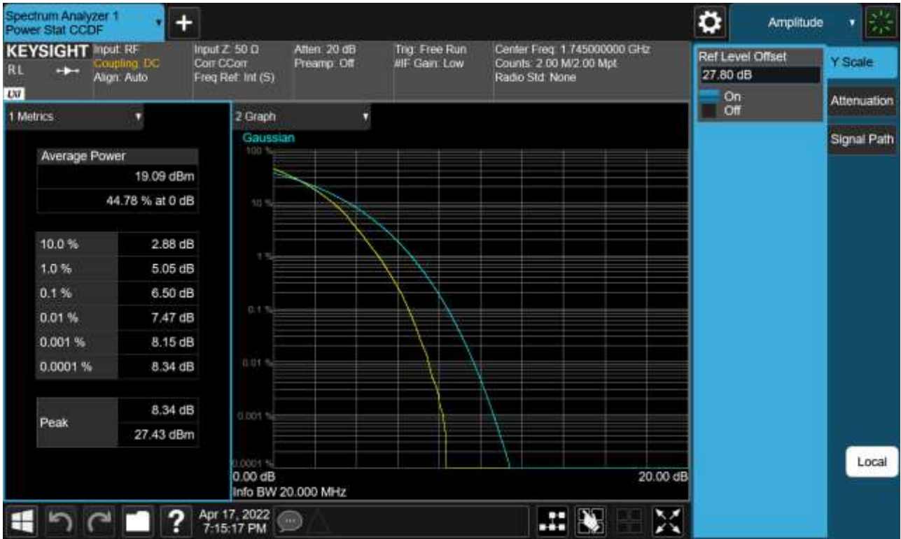
Sub6 n66. PAR Plot (20 M BW_Ch.349000_256QAM_Full RB)
