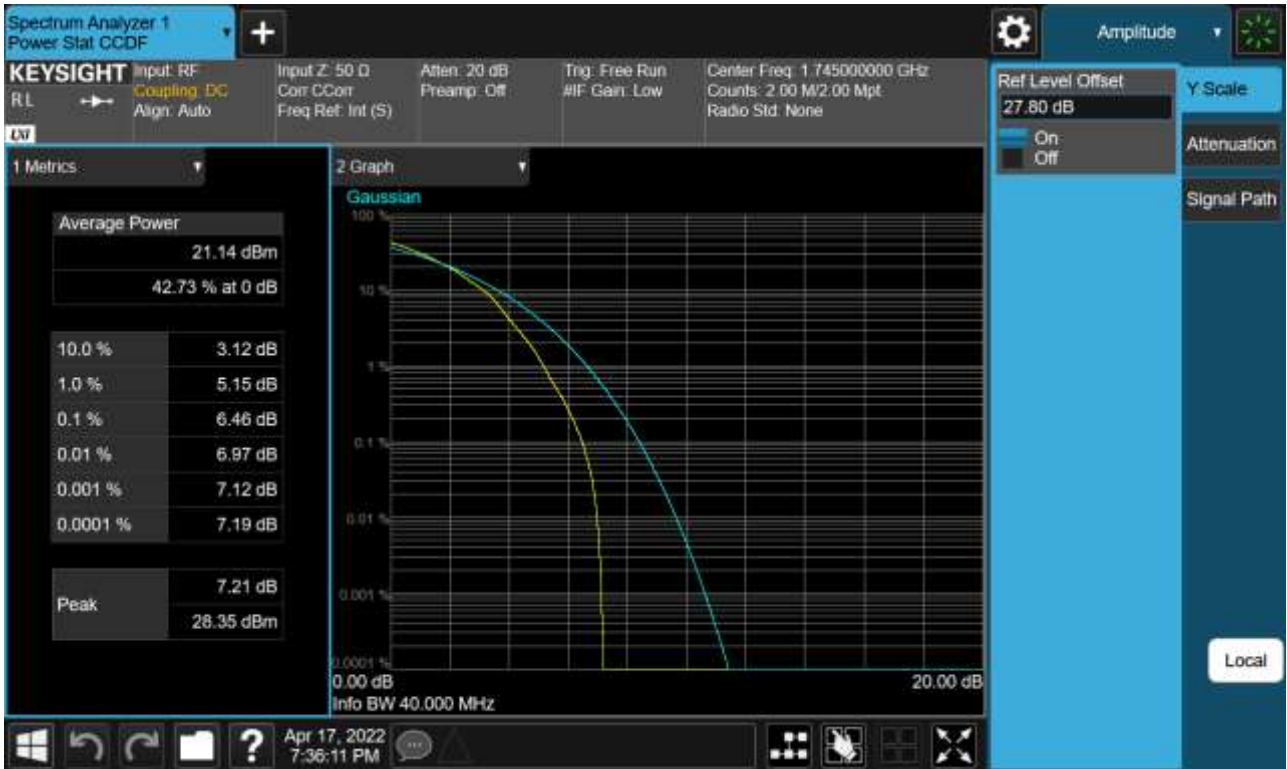
Sub6 n66. PAR Plot (40 M BW_Ch.349000_64QAM_Full RB)
