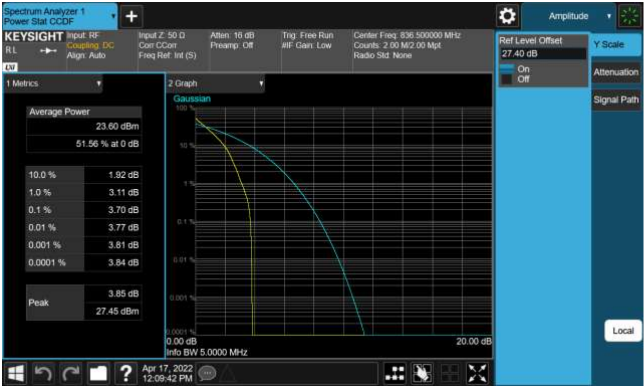
Sub6 n5. PAR Plot (5 M BW_Ch.167300_BPSK_Full RB_0)
