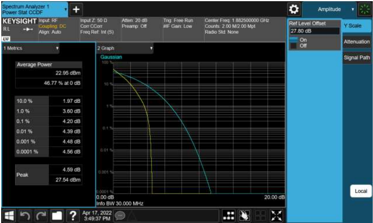
Sub6 n25. PAR Plot (30 M BW Ch.376500 BPSK_ Full RB_0 )
