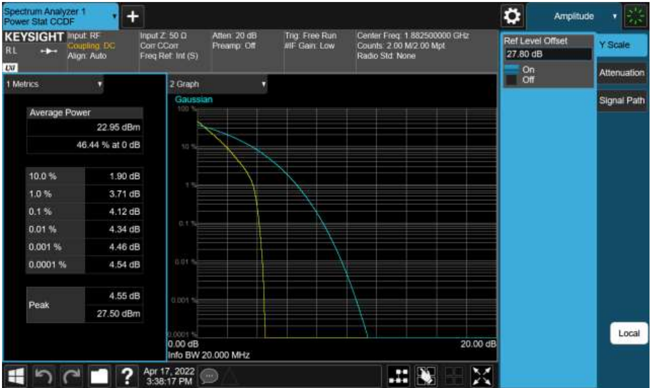
Sub6 n25(2). PAR Plot (20 M BW Ch.376500 BPSK _ Full RB _0)
