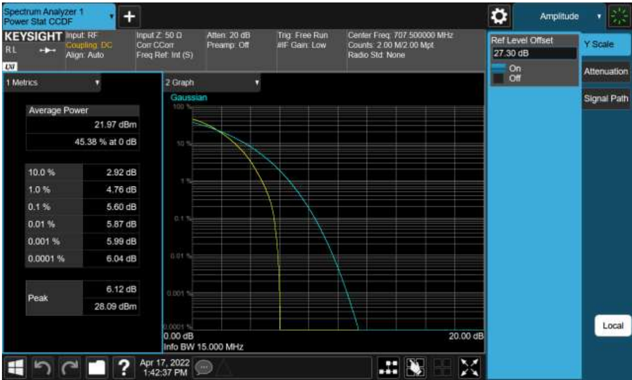
Sub6 n12. PAR Plot (15M BW Ch.141500 64QAM_RB75_0)
