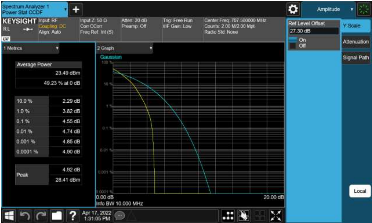
Sub6 n12. PAR Plot (10M BW Ch.141500 QPSK_RB50_0)
