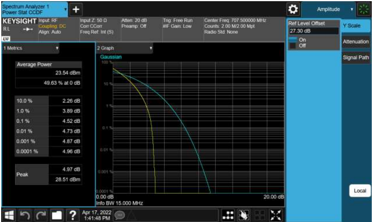
Sub6 n12. PAR Plot (15M BW Ch.141500 QPSK_RB75_0)
