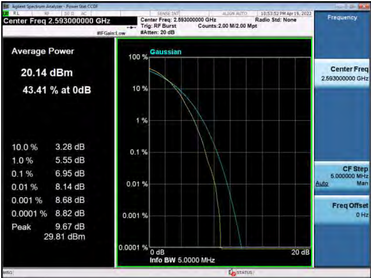
PAR Plot (5M BW_Ch.40620_64QAM_RB25_0) (POWER CLASS 3)
