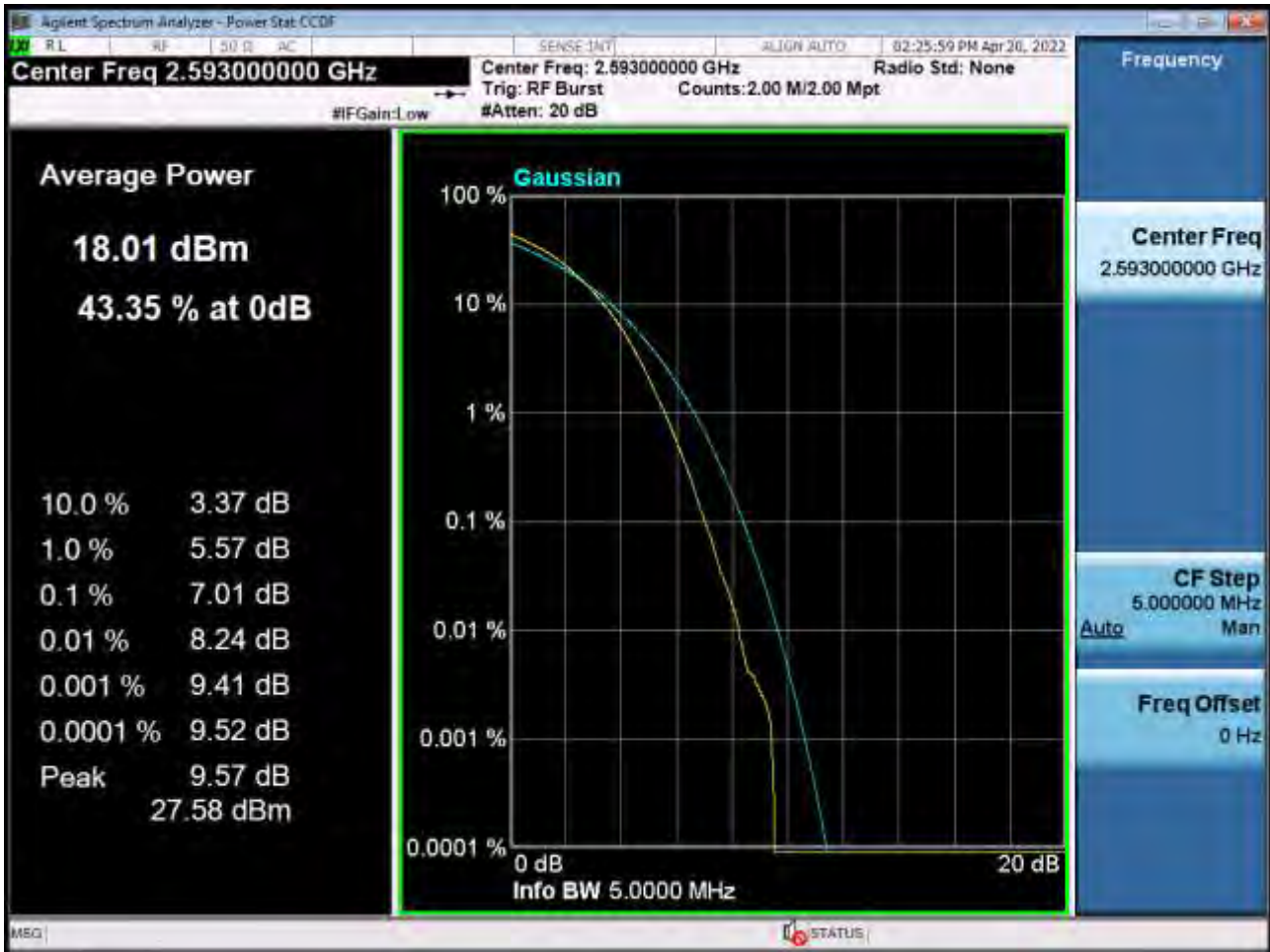
PAR Plot (5M BW_Ch.40620_256QAM_RB25_0) (POWER CLASS 3)
