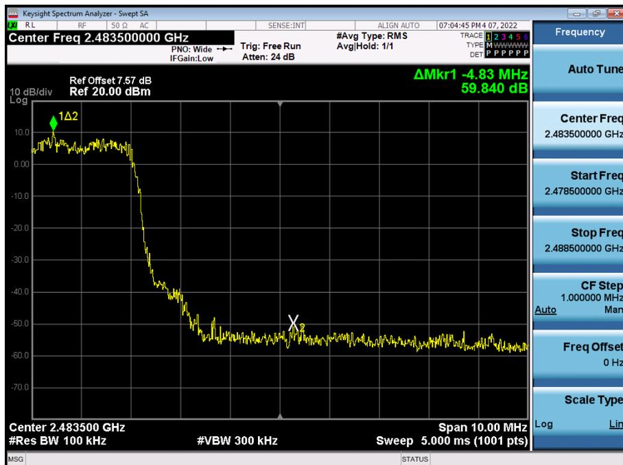
Test Plots with hopping ( $\pi/4$ DQPSK)
