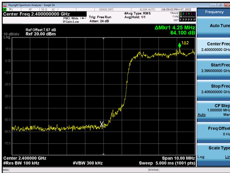
Test Plots with hopping ( $\pi/4$ DQPSK)
