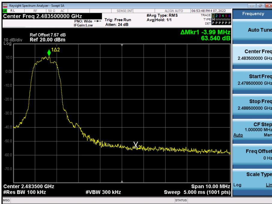
Test Plots without hopping ( $\pi/4$ DQPSK)
