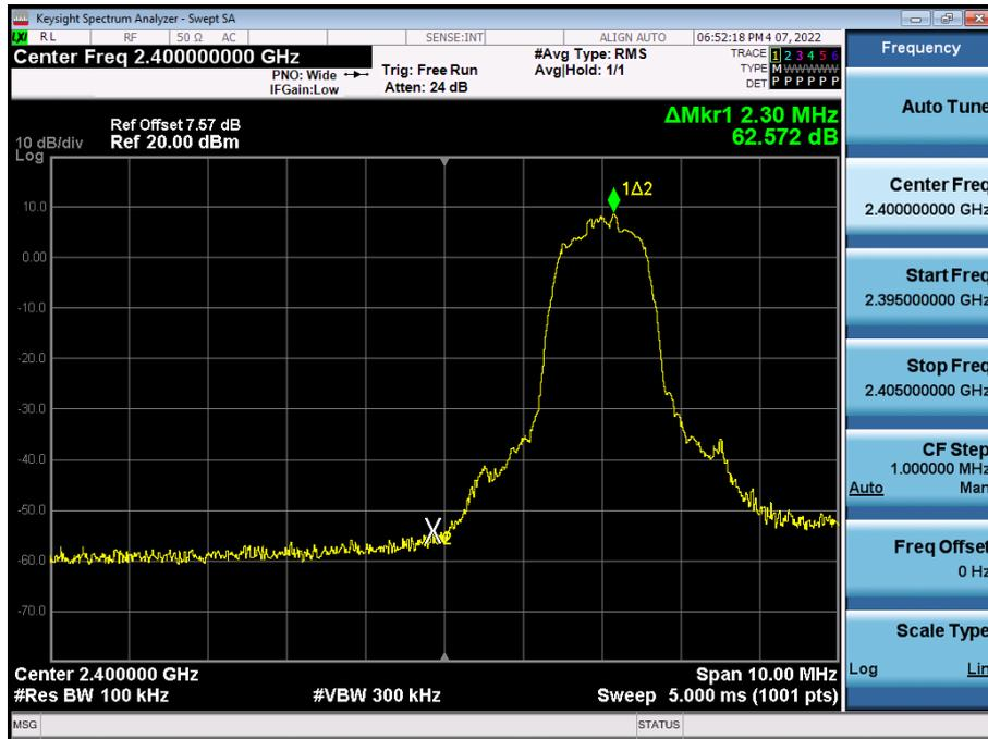
Test Plots without hopping ( $\pi/4$ DQPSK)
