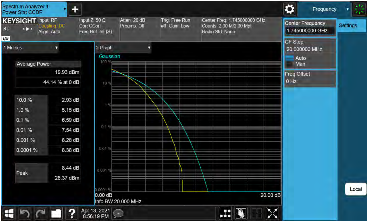
Sub6 n66. PAR Plot (20M BW_Ch.349000_256QAM_RB100_0)
