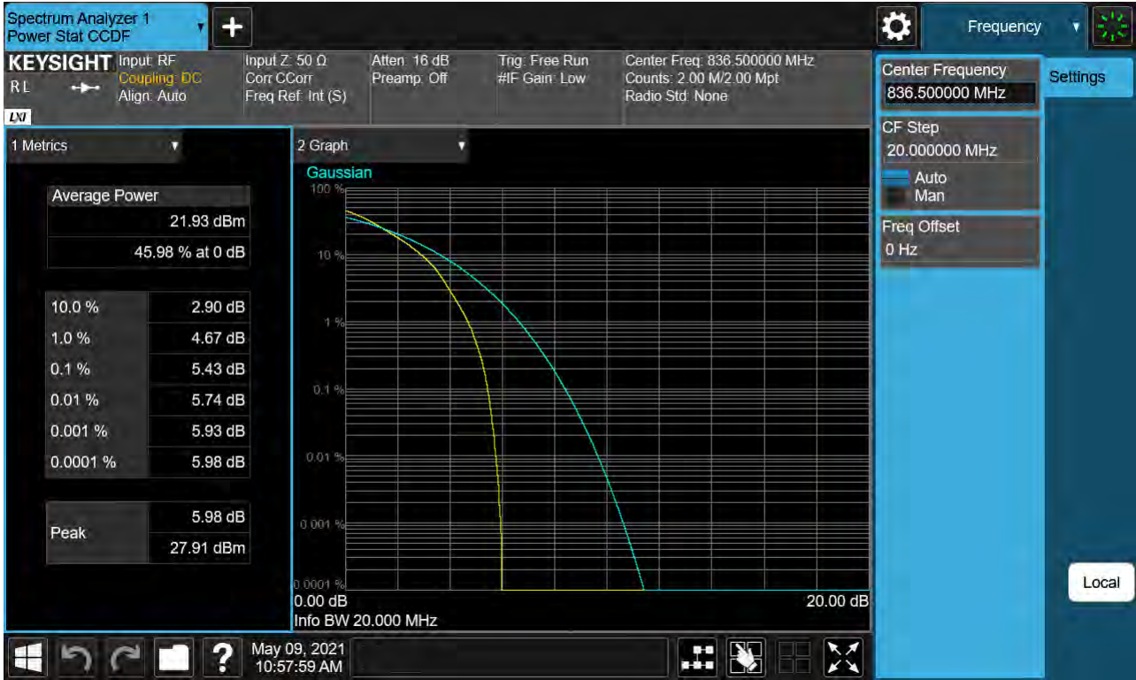
Sub6 n5. PAR Plot (20M BW_Ch. 167300_64QAM_Full RB _0)
