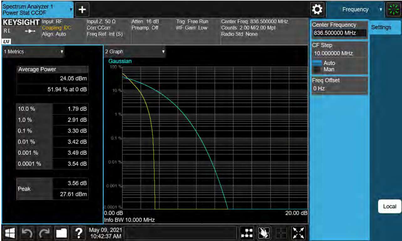
Sub6 n5. PAR Plot (10M BW_Ch. 167300_ BPSK_ Full RB _0)
