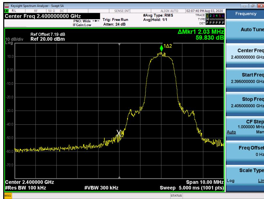
Test Plots without hopping ( $\pi/4$ DQPSK)
