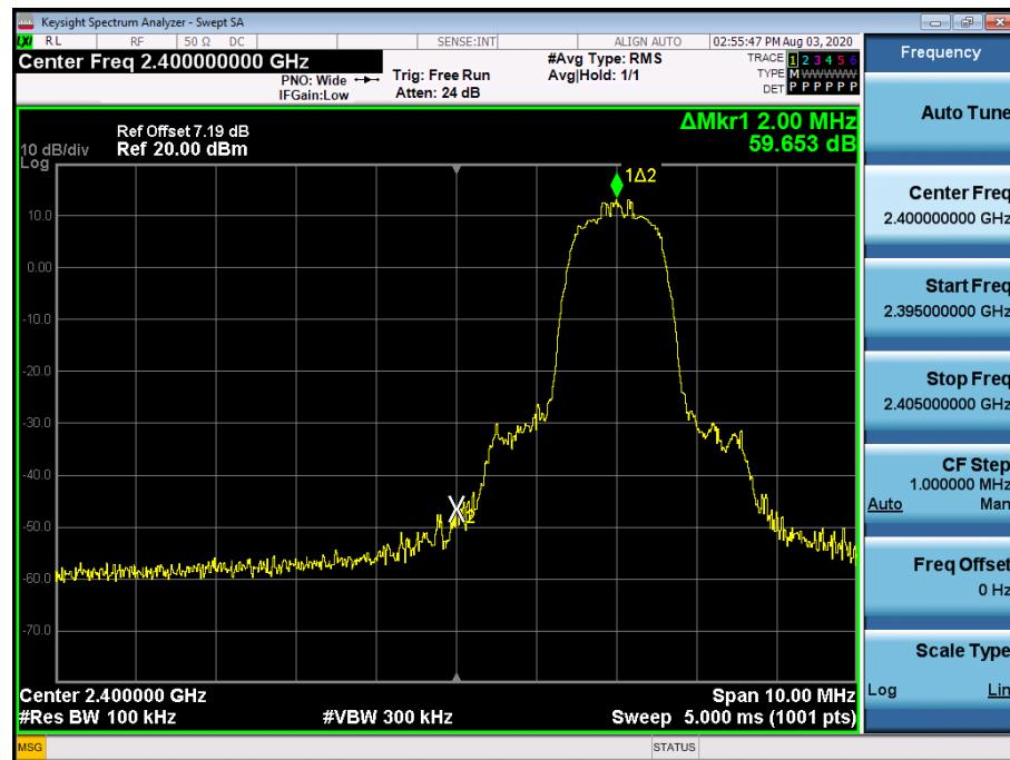
Test Plots without hopping ( $\pi/4$ DQPSK)
