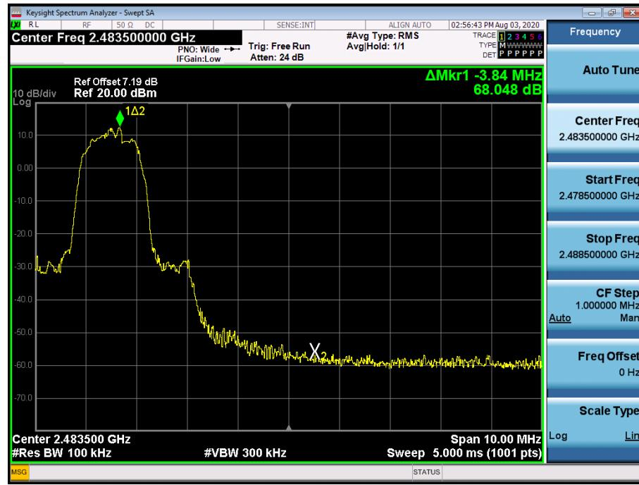
Test Plots without hopping ( $\pi/4$ DQPSK)
