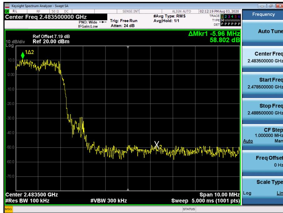
Test Plots with hopping ( $\pi/4$ DQPSK)
