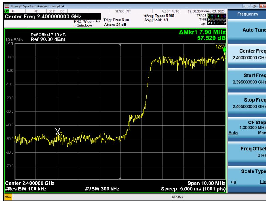
Test Plots with hopping ( $\pi/4$ DQPSK)
